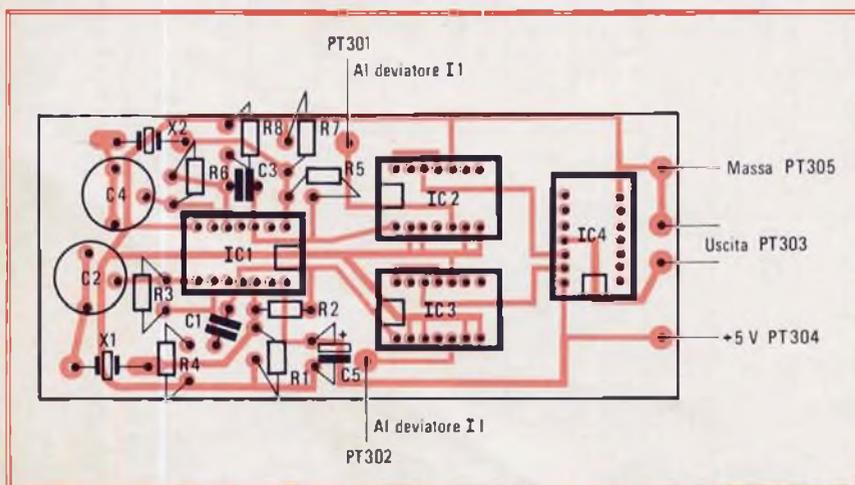
Fig. 6 - Disposizione dei componenti sul circuito stampato di figura 5.
