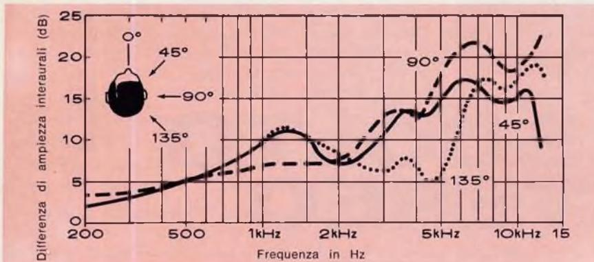
Fig. 2 - (a destra) sono riportate in grafico le differenze interaurali per tre diverse angolazioni e per la banda di frequenza compresa tra 200 e 12.000 Hz.
