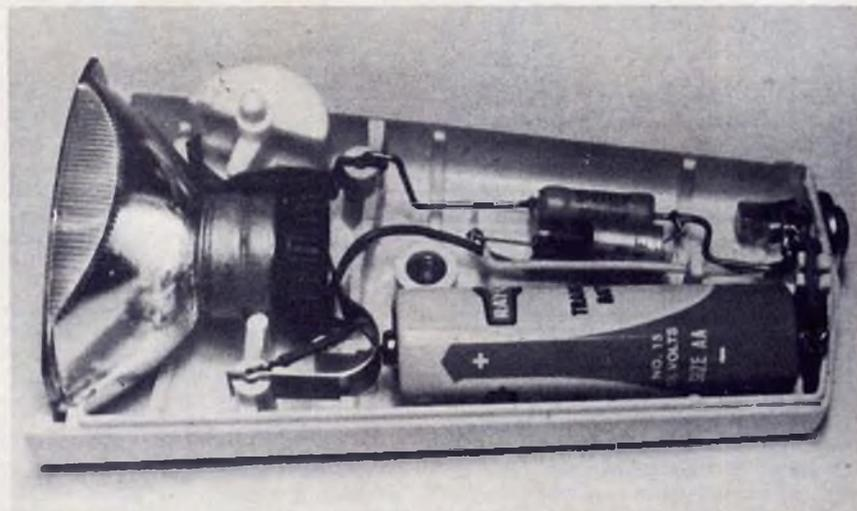
Fig. 6-B - Metodo di installazione dei componenti all'interno del contenitore illustrato alla figura 6-A.
