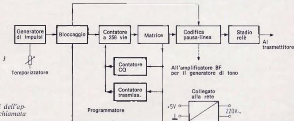
Fig. 1 - Schema a blocchi dell'apparecchio automatico di chiamata CQ.
