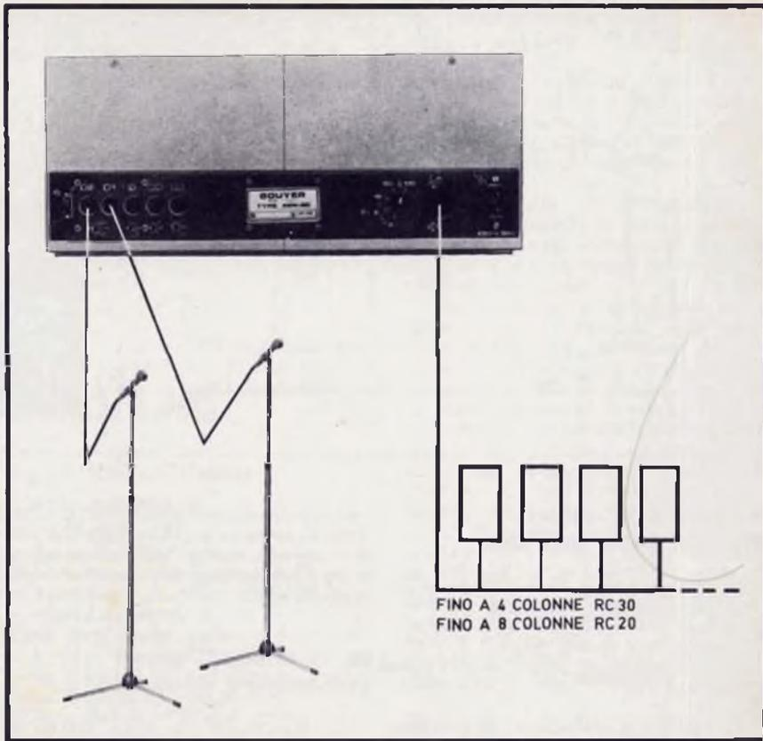
Fig. 3 - Impianto di sonorizzazione ANS60 per teatri e locali di medie dimensioni. Potenza di uscita 120 W. Diffusori fino a 4 colonne sonore RC 30 od 8 colonne RC 20.
