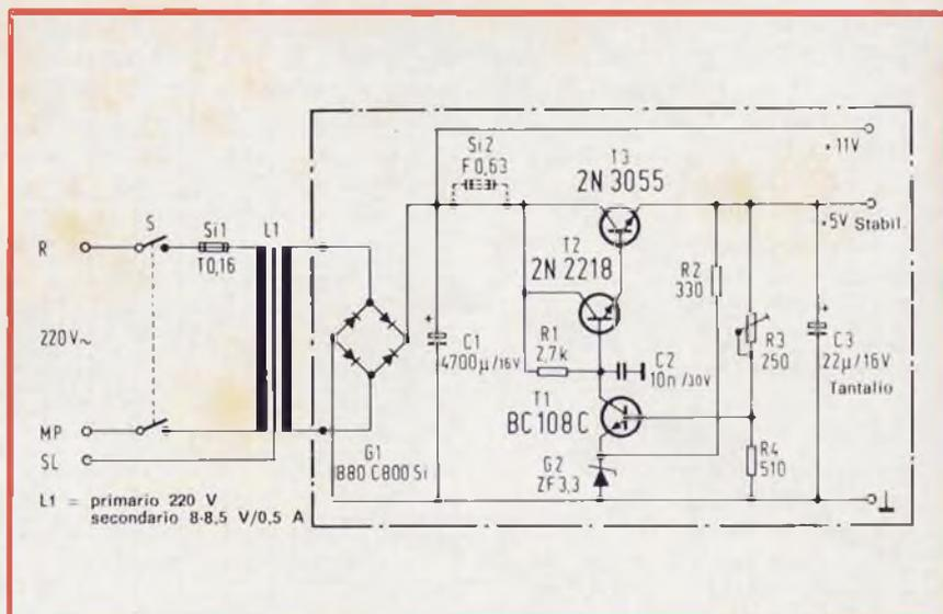
Fig. 4 - Schema elettrico della piastra CQ3 (alimentatore).
