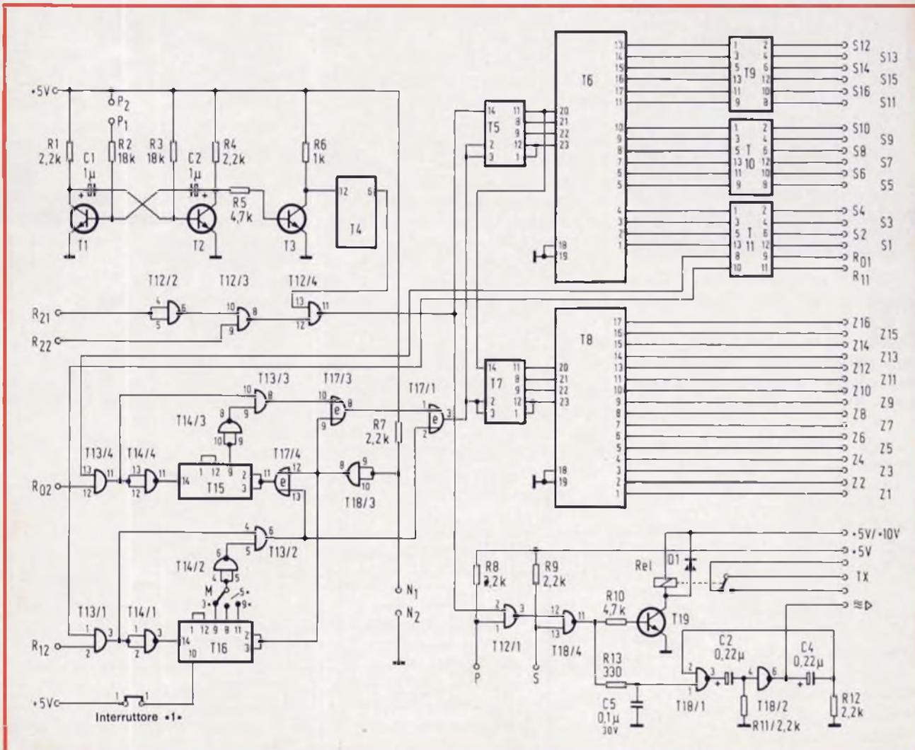
Fig. 2 - Schema elettrico della piastra CQ1 (programmatore).
