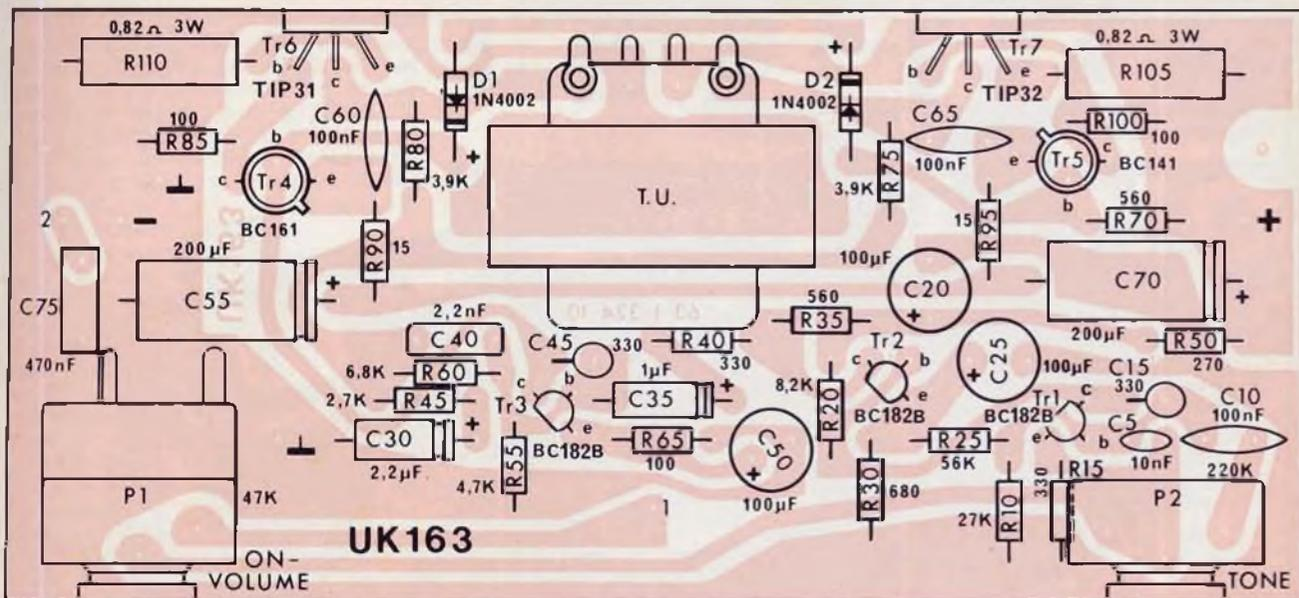
Fig. 2 - Disposizione dei componenti sulla basetta a circuito stampato.
