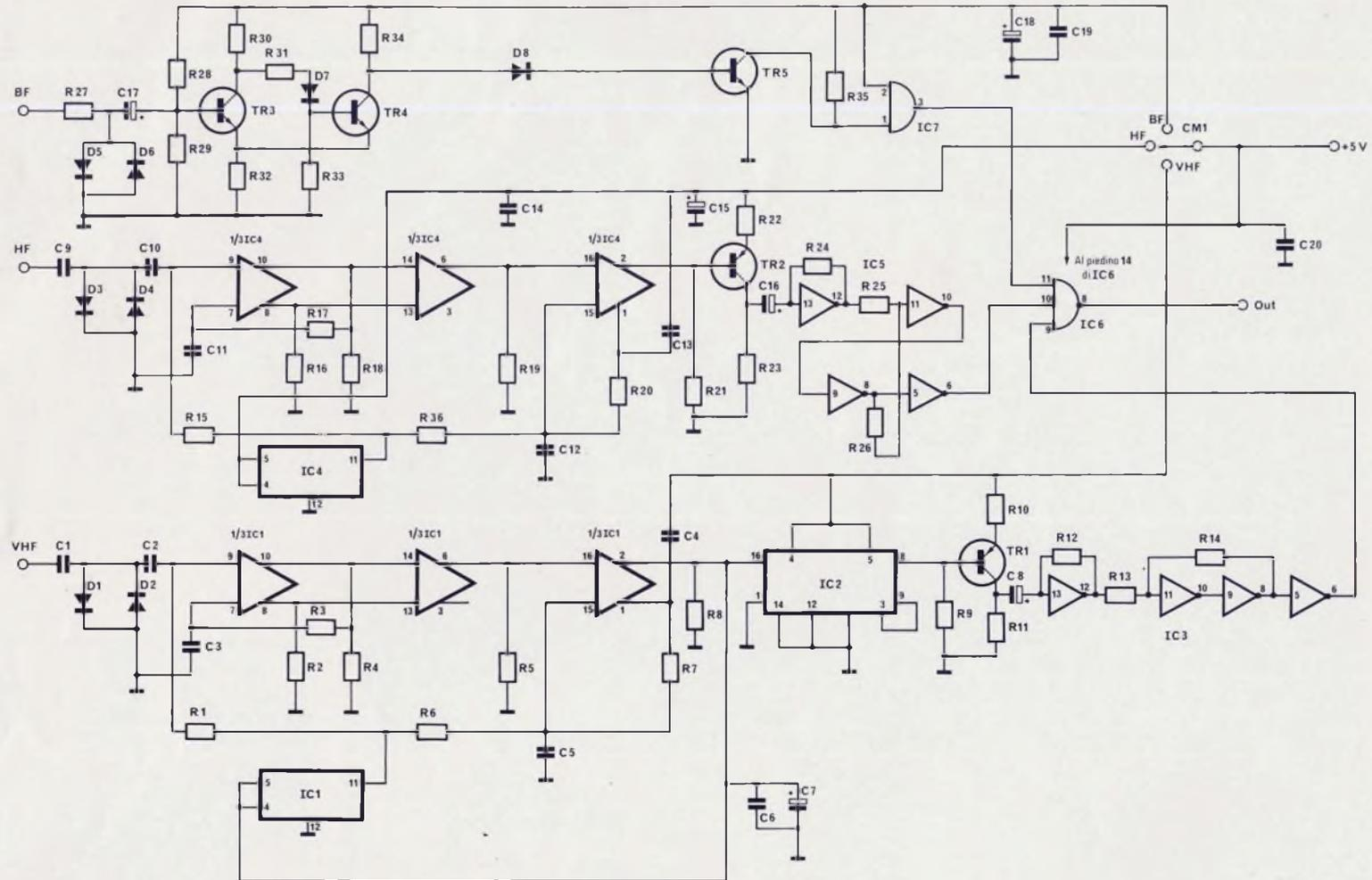
Fig. 7 - Schema elettrico dei circuiti d'ingresso.
