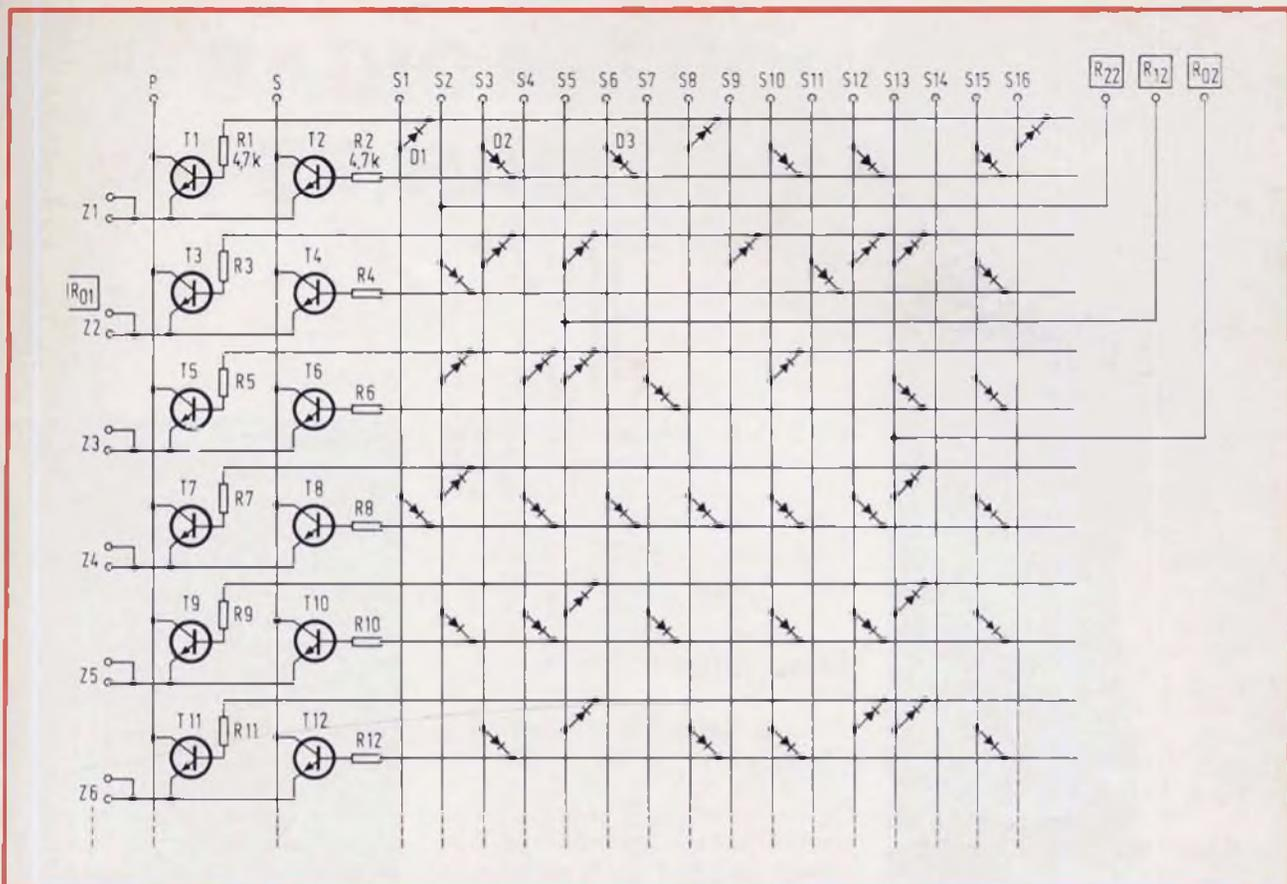
Fig. 3 - Schema elettrico della matrice a programma.
