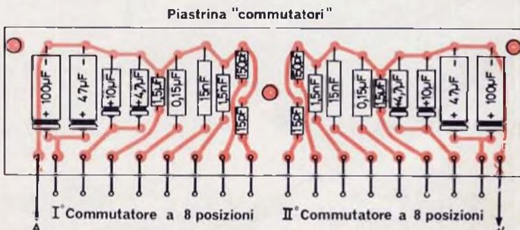
Fig. 5 - Disposizione dei condensatori sulla piastrina a circuito stampato di commutazione.
