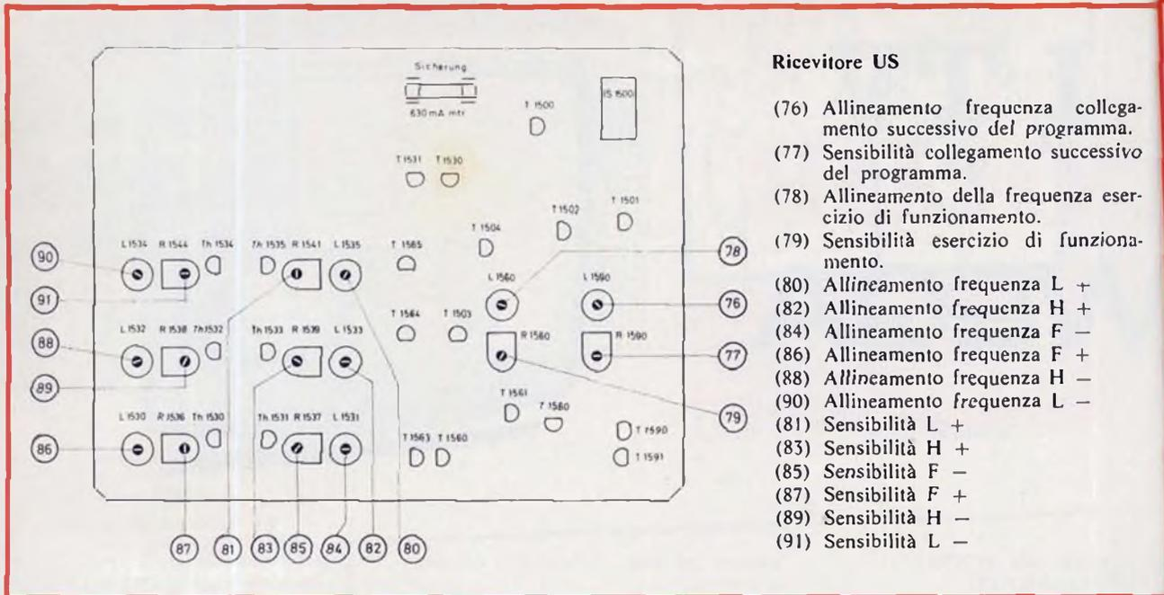
Fig. 11 - Punti di allineamento del ricevitore ad ultrasuoni.
