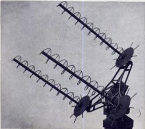
Fig. 4 - Altro sistema di antenne elicoidali, sensibilmente più complesso di quello illustrato in figura 5 (guadagno dell'ordine di 25 dB).
