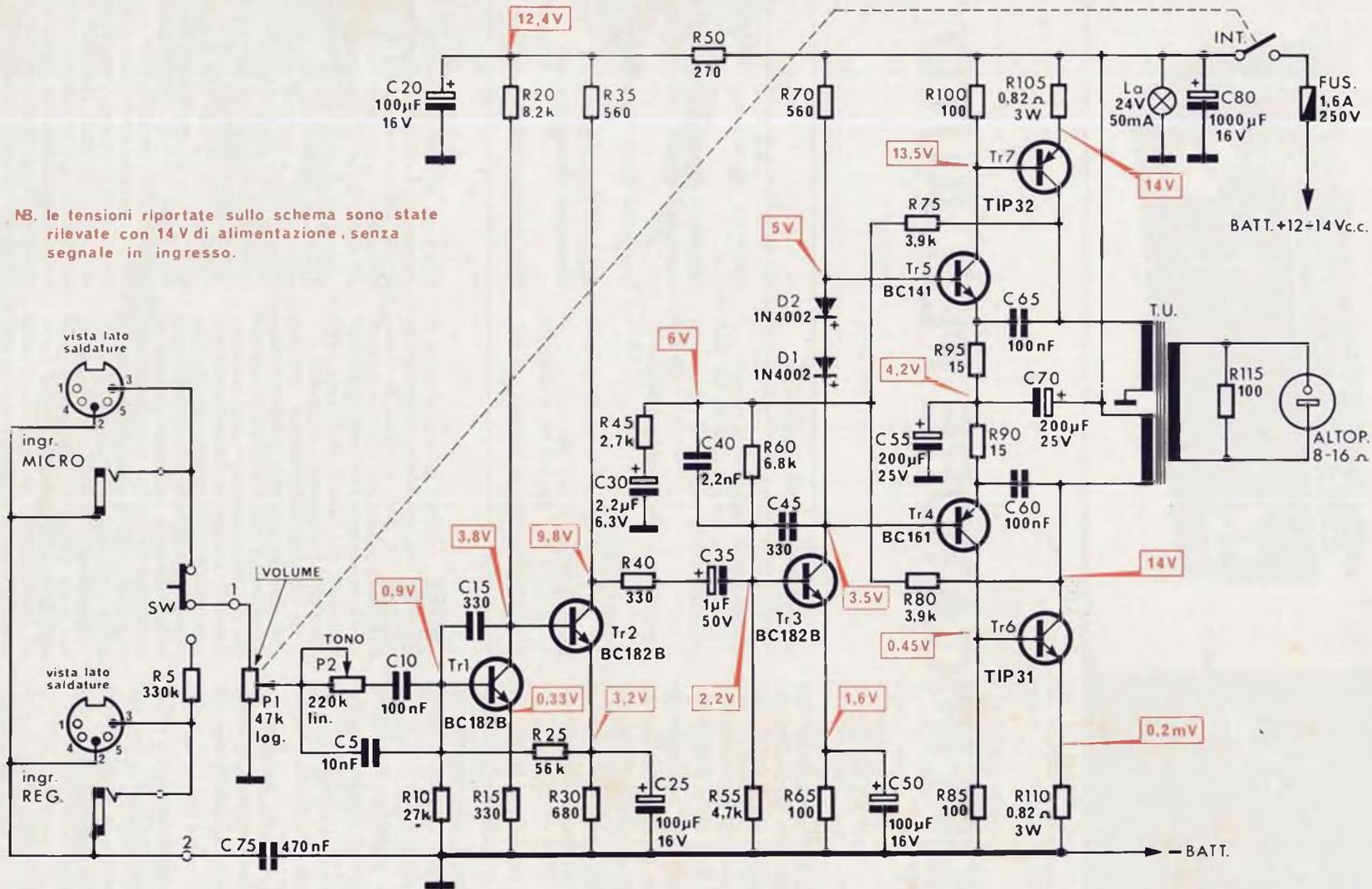
Fig. 1 - Schema elettrico.
