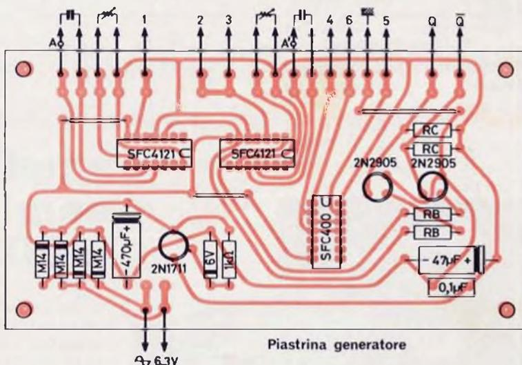
Fig. 4 - Disposizione dei componenti sulla piastrina a circuito stampato del generatore.
