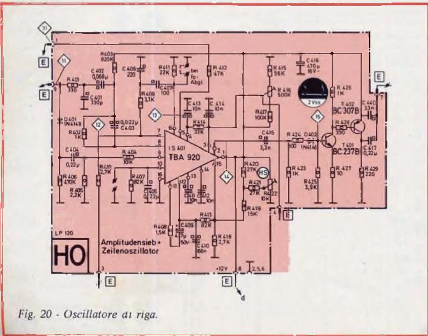
Fig. 20 - Oscillatore di riga.
