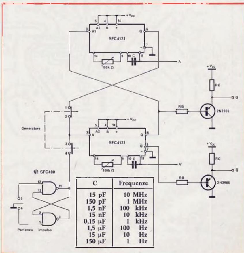
Fig. 1 - Schema elettrico del generatore d'impulsi con circuiti integrati TTL.
