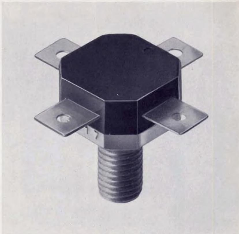
Il **BLX 15** è stato realizzato per completare la gamma dei transistori finali H.F. e V.H.F.. Si tratta di un transistorore di potenza al silicio capace di fornire 150 W<sub>p.e.p.</sub><sup>1)</sup> da solo, e 300 W<sub>p.e.p.</sub> in controfase; la distorsione di intermodulazione in entrambi i casi è di appena - 30 dB.
