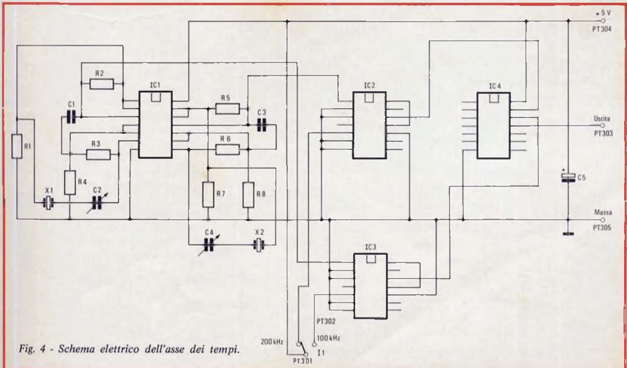
Fig. 4 - Schema elettrico dell'asse dei tempi.
