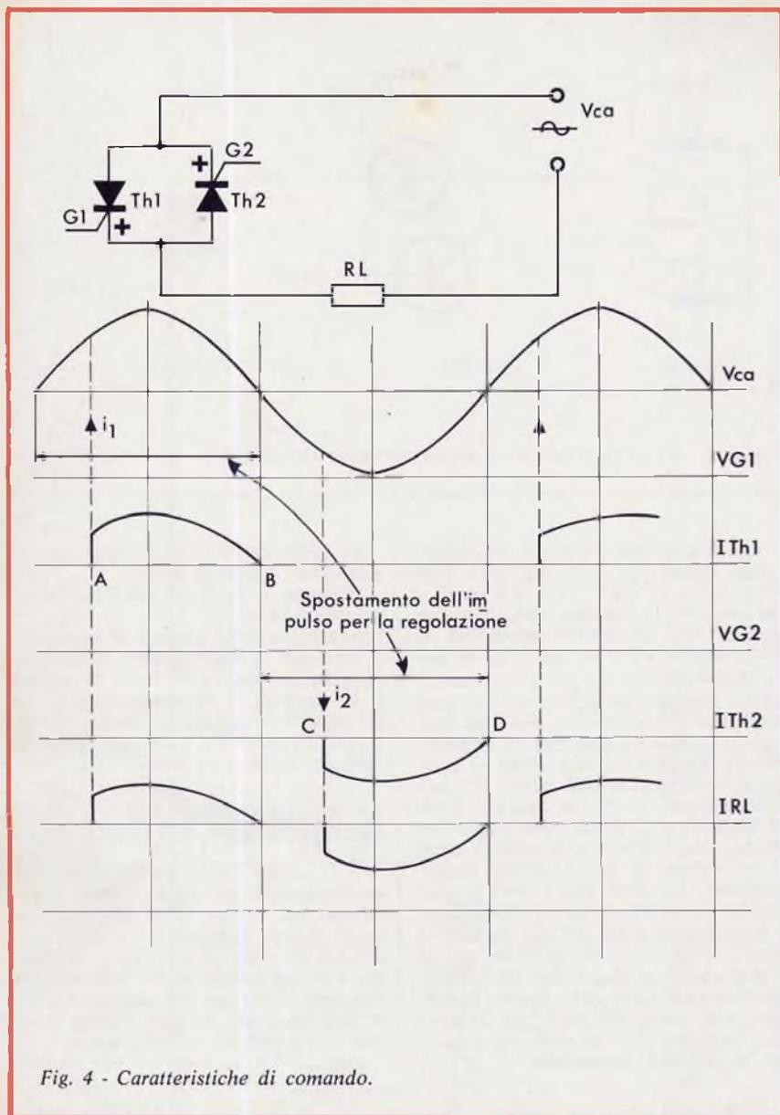
Fig. 4 - Caratteristiche di comando.
