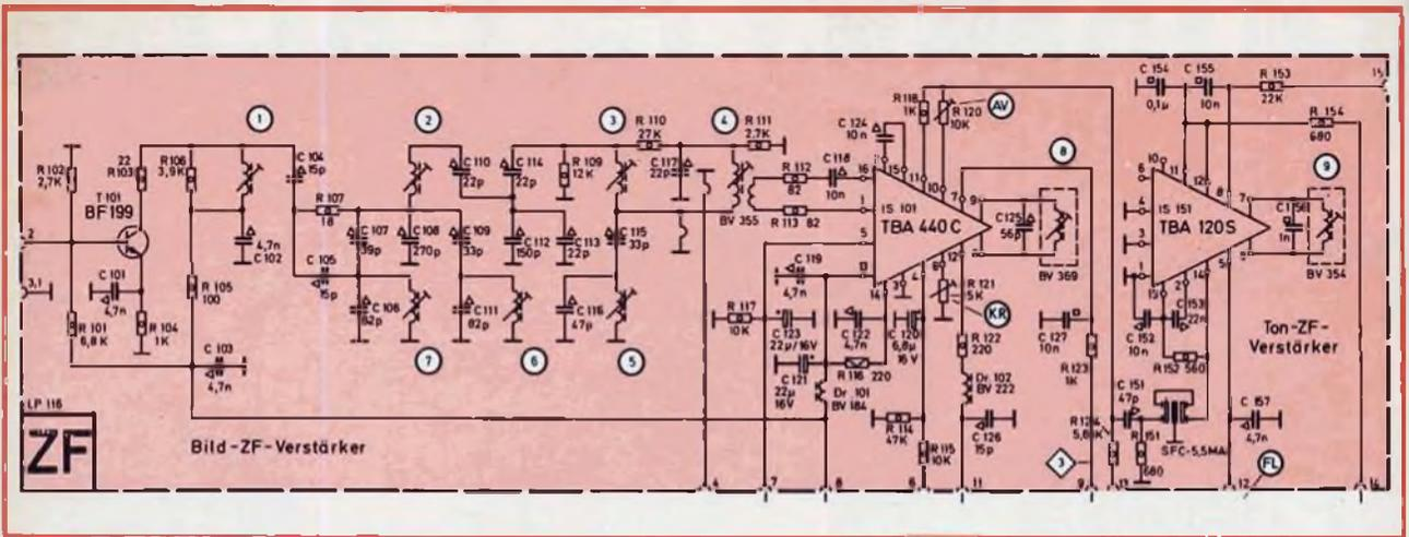
Fig. 18 - Circuito delle medie frequenze video.
