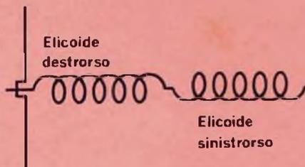
Fig. 6 - Per ottenere una polarizzazione lineare si può montare due elicotidi in serie, avvolti in senso inverso.
