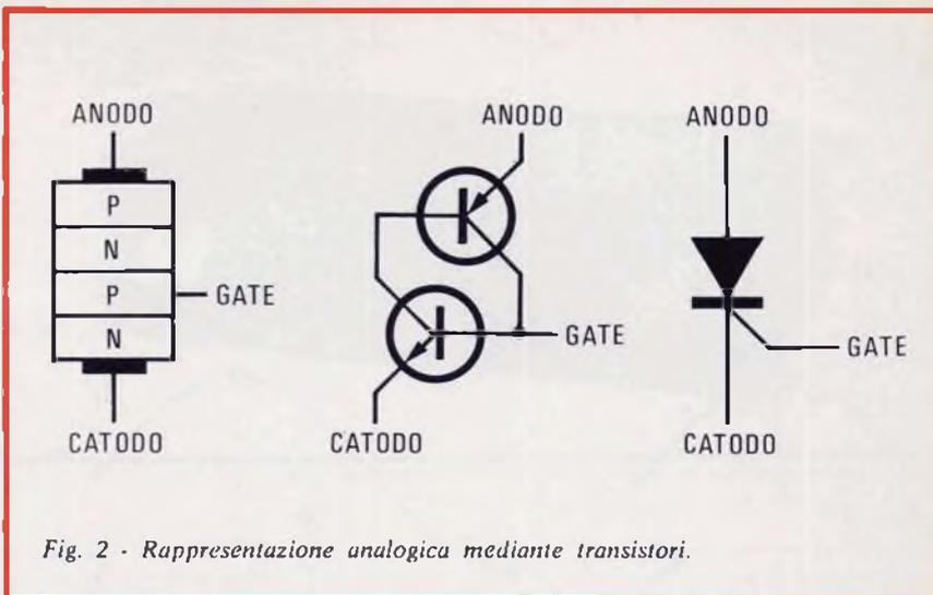
Fig. 2 - Rappresentazione analogica mediante transistori.
