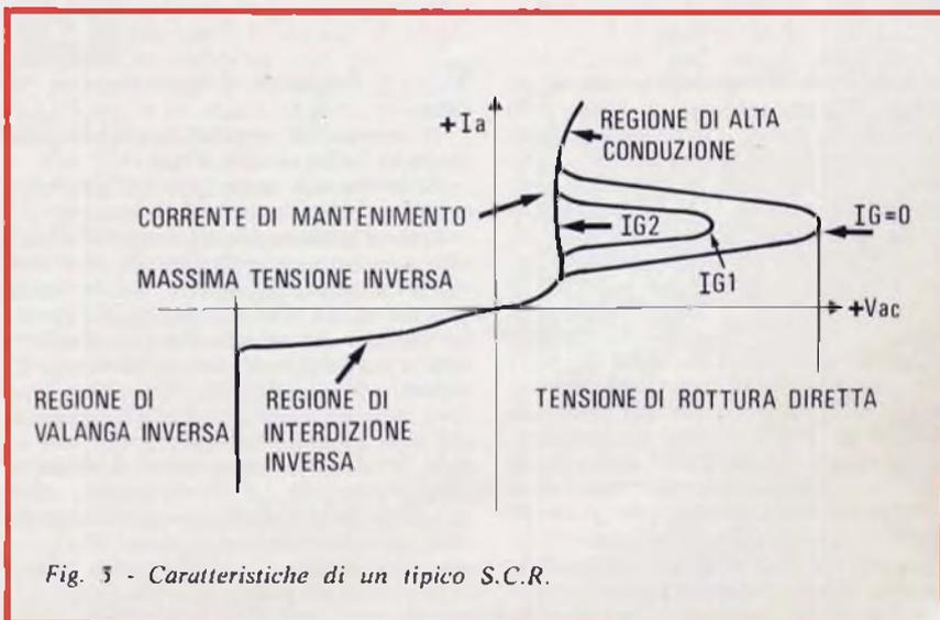
Fig. 3 - Caratteristiche di un tipico S.C.R.
