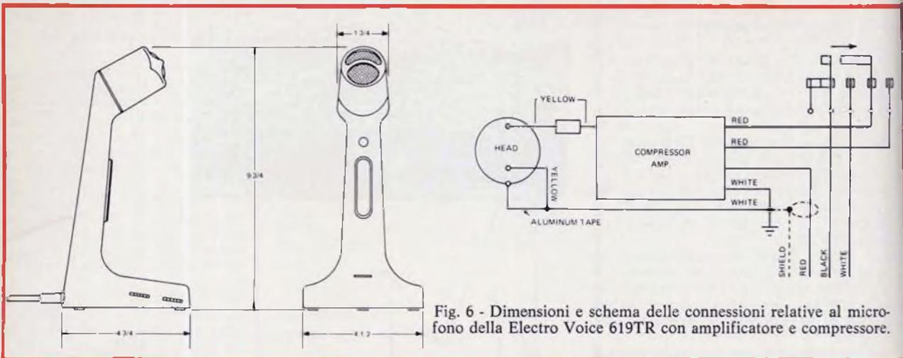
Fig. 6 - Dimensioni e schema delle connessioni relative al microfono della Electro Voice 619TR con amplificatore e compressore.
