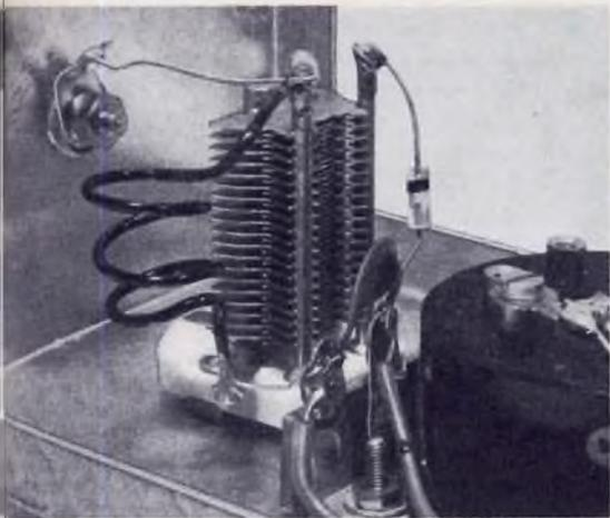
Fig. 9 - Particolare di montaggio del misura-campo di figura 8 per la gomma dei 144 MHz.
