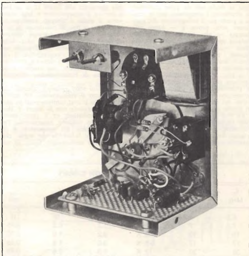
Fig. 11 - Metodo realizzativo dello strumento di fig. 10: il tutto viene montato in un telaio ad «U», di dimensioni appena sufficienti per poter contenere la basetta a circuiti stampati, lo strumento, ed i diversi dispositivi di comando.
