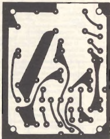
Fig. 5 - A sinistra, riproduzione del circuito stampato visto dal lato rame; a destra lo stesso circuito è illustrato dal lato opposto, per chiarire la posizione dei diversi componenti e le connessioni ai componenti esterni.
