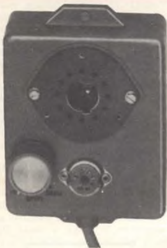
Fig. 10 - Adattatore universale per i diversi tipi di tubi a raggi catodici.
