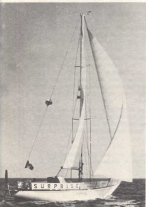
Fig. 9 - Ecco una bella inquadratura del «Surprise». Si noti il riflettore radar montato sullo strallo di poppa: è indispensabile per evitare collisioni con le navi di linea. Ma il pericolo di abbordi in mare sia con imbarcazioni, rottami alla deriva od anche piccoli «iceberg» specie alle alte latitudini è sempre presente ed è una delle principali incognite delle rotte transoceaniche. Ben visibile pure il timone a vento disposto all'esterno della poppa del «Surprise»; è un altro compagno indispensabile per chi naviga in solitario.
