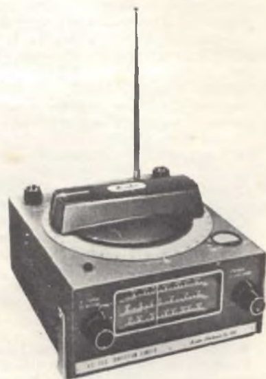
Fig. 14 - Radiogoniometro portatile adatto per imbarcazioni da diporto di piccole dimensioni.
