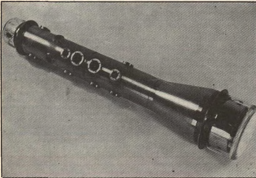
Fig. 15 - Aspetto pratico del nuovo tipo di tubo a raggi catodici, realizzato dai Laboratori di Elettronica e di Fisica Applicata in Francia.
