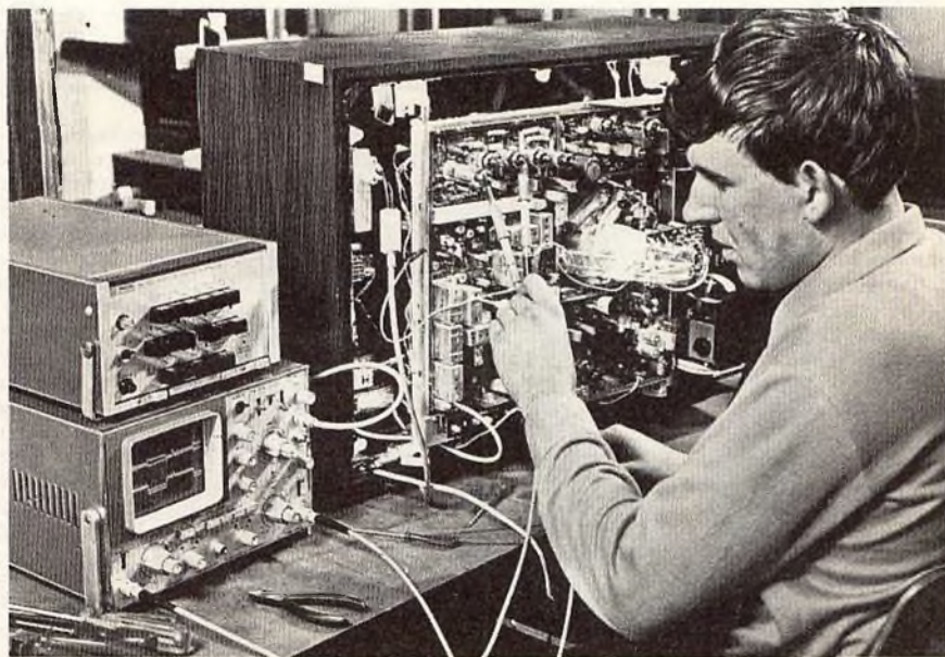
Fig. 1 - Le dimensioni e l'attrezzatura di un laboratorio per tecnico radoriparatore sono strettamente legate all'attività del lavoro che vi si intende svolgere. Tale laboratorio va tenuto separato da altri e gli utensili e gli strumenti di misura devono essere a portata di mano.
