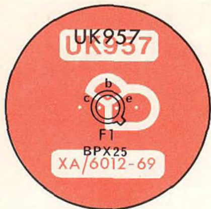
Fig. 2/a - Montaggio del fototransistore.
