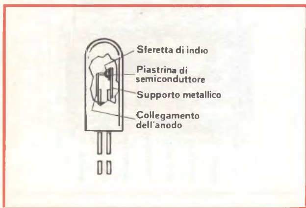
Fig. 7 - Diodo a giunzione (struttura interna).
