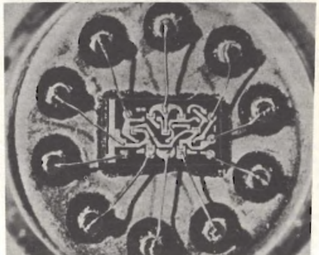
Fig. 3 - Circuito integrato (è stato tolto il cappuccio; Telefunken).
