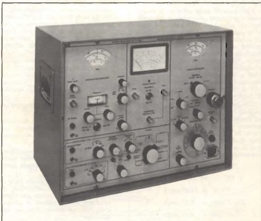
Fig. 1 - Strumento di controllo «mobile radio test set» modello TF 2950 della Marconi Instruments, per la verifica delle apparecchiature per il servizio mobile nella gamma VHF.
