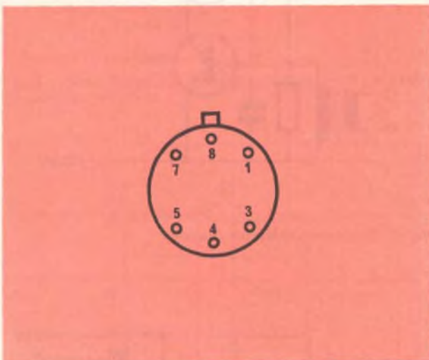
Fig. 4 - Connessioni del 703C viste dal lato elettrodi.
