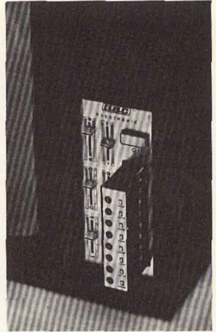
Fig. 4 - Particolare del sistema a sensori del recente televisore a colori UT/3060 Regret (GBC Italiana), completamente a transistori e circuiti integrati realizzato secondo la tecnica modulare.
