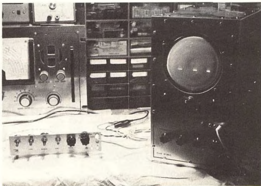
Foto 16 - Prova del generatore, posto in posizione barre, con il monitor che descriverò nelle prossime puntate.
