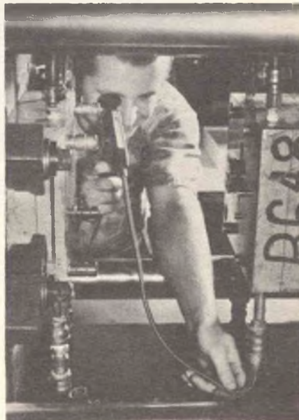
Fig. 2 - Tipico esempio di impiego del Fiberscope FS-100 illustrato in figura 1.
