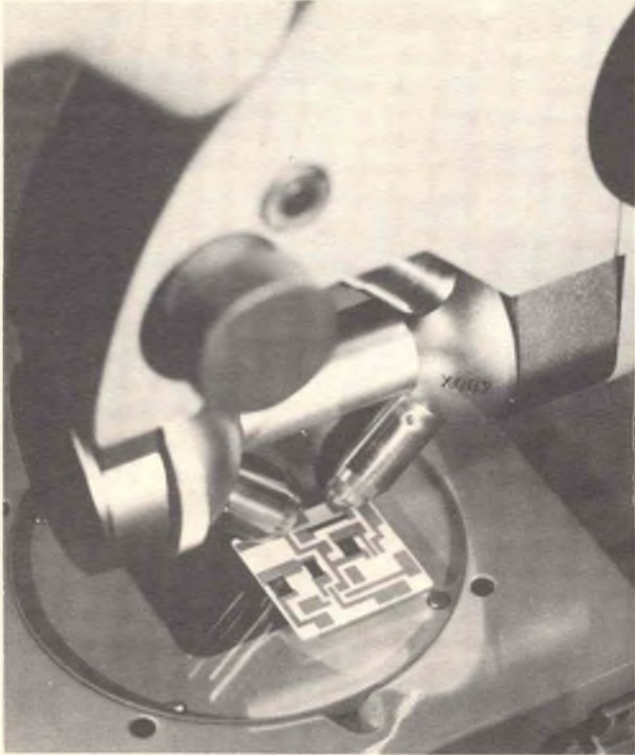
Fig. 86 - Per la realizzazione di circuiti integrati ad alta densità di componenti (L.S.I. = Large Scale Integration), il disegno della maschera viene ulteriormente ridotto, e di conseguenza, si richiede un controllo ottico mediante microscopio.
