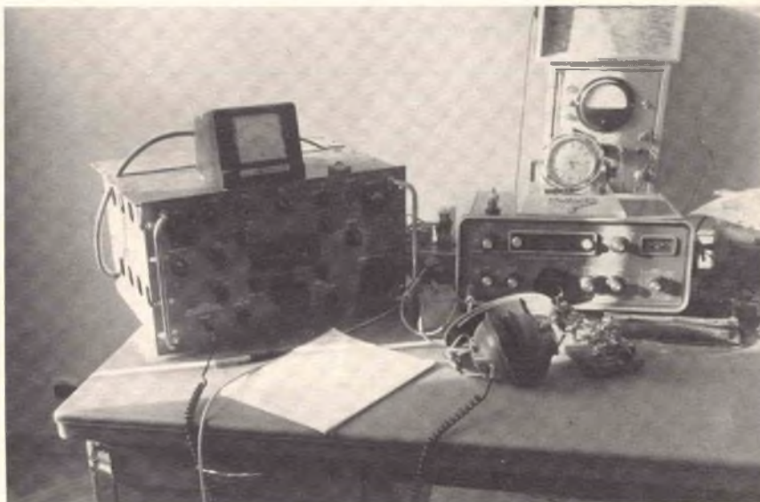
Fig. 7 - Questi i due ricevitori base del QTH di AMC. A sinistra il Collins 350 A con copertura continua di frequenza da 500 kHz a 32 MHz in banda di 1 MHz. A lato sulla destra è invece disposto un modernissimo apparato interamente transistorizzato: l'SX 215 con copertura continua da 3 a 30 MHz in fette di frequenza di 200 kHz. Le pareti del QTH sono coperte di pubblicazioni «Ham». AMC ha la raccolta completa dei QST e degli Handbook della ARRL!
