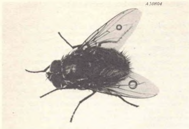
Fig. 89 - Questa fotografia (mosca con nuclei magnetici sulle ali) dà un'idea delle dimensioni che possono assumere i nuclei in ferrite per memorie.
