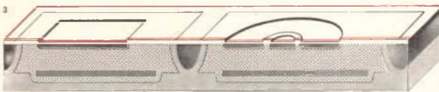
Fig. 78 - Si rimuove nuovamente tutto lo strato di ossido e si effettua una nuova ossidazione. Vengono aperte nuove finestre in cui viene diffuso il boro creando così i seguenti strati di tipo p: — zona di base (per transistori n-p-n e diodi); — zone di emettitore e di collettore (per transistori p-n-p); — zona resistiva (per resistori) ed elettrodi di tipo p (per condensatori).
