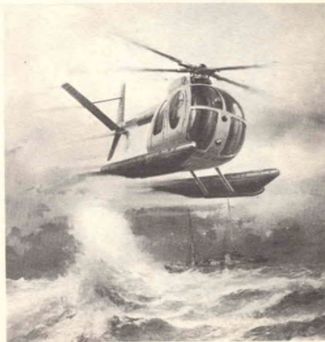
Fig. 1 - Servizio aereo della Guardia di Finanza - Elicottero Nardi-Hughes 500 M, versione anfibia munito di apparecchiature radio per collegamento diretto con la sala operativa.
