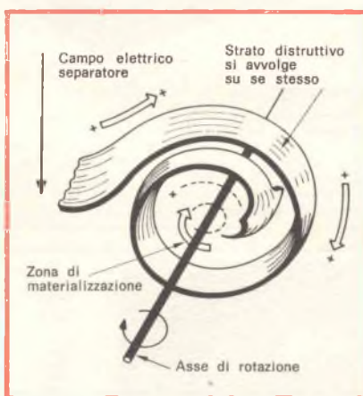
Fig. 1 - Un'onda luminosa che si propaga, è formata da due strati distrittivi oscillanti, uno positivo l'altro negativo. Quando agisce un campo elettrico, questi strati si dissociano e le loro estremità si avvolgono su se stesse dando luogo a un positone (avente una energia di 511 keV) e a un negatone al quale corrisponde una larghezza d'onda limite \lambda di 2,5 pm ( 2,5 \times 10^{-12} m).
