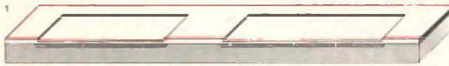
Fig. 76 - Sulla piastrina di silicio di tipo P (il cosiddetto «substrato» che ha uno spessore di 0,25 mm) viene formato uno strato di ossido di silicio ( \text{SiO}_2 ) e vengono aperte su di esso mediante fotoincisione le finestre per i transistori p-n-p, n-p-n e per i diodi. Successivamente si forma lo «strato sepolto» mediante una diffusione di arsenico. Le finestre vengono poi richiuse con un nuovo strato di ossido di silicio. Si tenga presente che, dopo ogni processo di diffusione, le finestre vengono sempre richiuse mediante formazione di nuovi strati di ossido di silicio.
