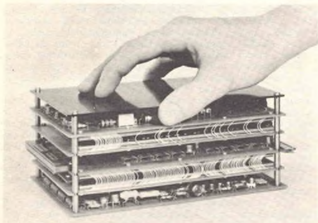
Fig. 90 - Memoria a nuclei magnetici Philips tipo Fi-2 contenente anche i circuiti elettronici di comando. Impiega circuiti integrati e semiconduttori al silicio ed ha una capacità di 1024 parole di 8 bit. Il tempo di ciclo è 4 microsecondi.
