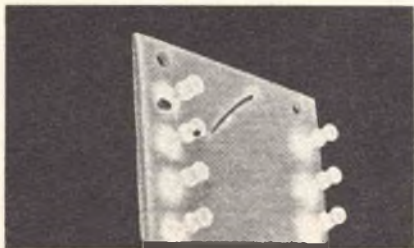
Fig. 2 - Lo stesso circuito di figura 1 visto con lampada di Wood. Le macchie e la striscia scura si riferiscono ad imperfezioni costruttive.
