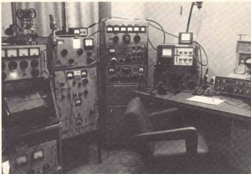
Fig. 6 - AMC ha autocostruito personalmente buona parte delle apparecchiature del suo QTH. Da sinistra un tx per 144 e 432 di notevole potenza; sotto si nota una telescrivente e più sotto ancora un alimentatore. Segue a lato un tx da 200 W autocostruito solo per CW con il suo VFO a parte. Su di un altro rack a lato c'è poi il pezzo forte: un tx autocostruito per SSB, CW, AM che permette un livello + 60 dB su 52 \Omega ! A destra sopra il primo ricevitore è disposto lo strumento di misura base del QTH; un analizzatore di spettro della HP con tubo a memoria.
