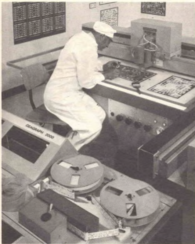
Fig. 85 - Le maschere, dopo il controllo ottico, subiscono eventuali ritocchi. Qui, al controllo ottico, si affianca quello effettuato mediante un calcolatore.
