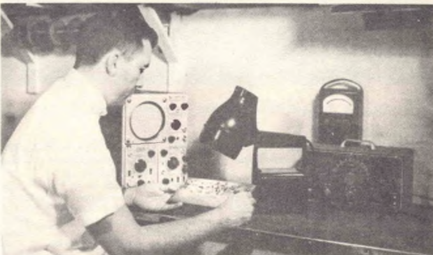
Fig. 8 - La stessa lampada di figura 7, impiegata in un piccolo laboratorio di riparatore, per il controllo dei circuiti stampati e relativi componenti.
