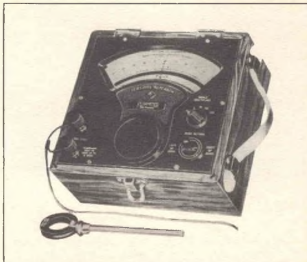
Fig. 28 - Il misuratore di flusso Grassot è un galvanometro privo di molla di richiamo, utilizzato con una bobina di rilevamento.
