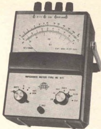
Fig. 11 - Il misuratore d'impedenza di cui in figura 10 è mostrato lo schema elettrico. Questo strumento consente anche la misura delle tensioni alternate da 10 \text{ mV} a 100 \text{ V} con banda passante 10 \text{ Hz} \div 200 \text{ kHz} .
