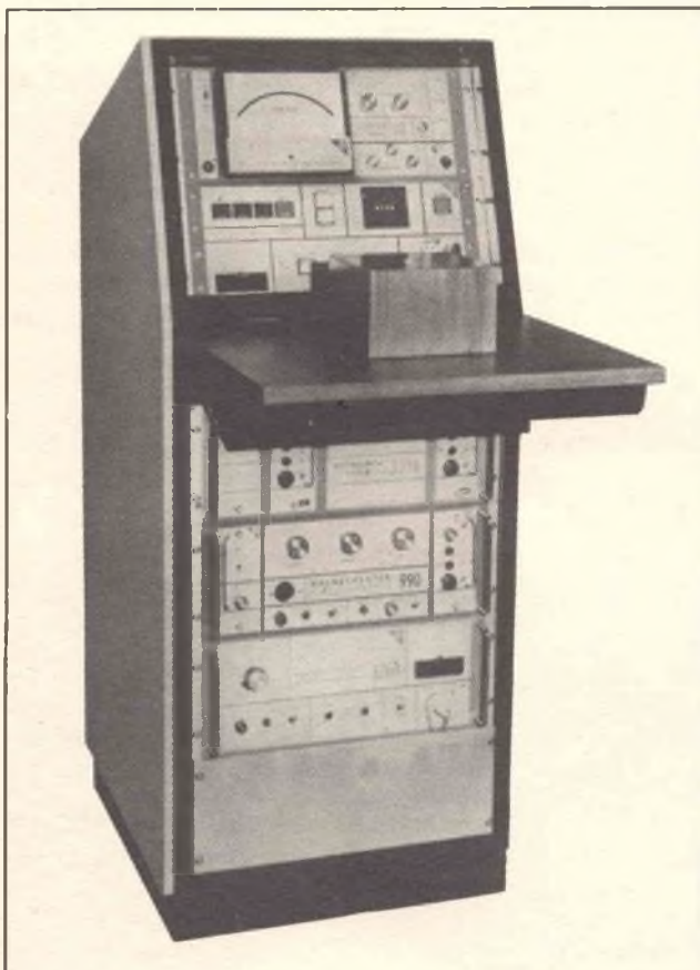
Fig. 35 - Un sistema magnetico completo Magnetreater®, che carica, misura e stabilizza i materiali magnetici (RFL).
