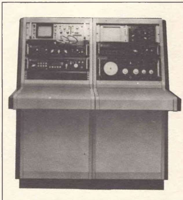
Fig. 4 - Un moderno complesso ricevente della Watkins-Johnson Co. per la ricezione della gamma delle microonde da 0,5 GHz a 18 GHz.
