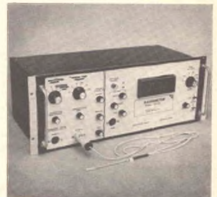
Fig. 5 - Gaussmetro RFL (Vianello) modello 750DR, in versione rack, con adattatore ID75.
