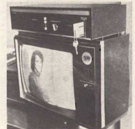
Fig. 14 - La Telebeam ha sviluppato un sistema Pay-TV azionato da una "chiave" di plastica. L'apparato offre 26 canali TV, più un sistema di sicurezza e giochi elettronici. L'apparato funziona in questo modo, l'ospite sceglie il film o evento che vuol vedere, dopo 5 minuti, se continua a guardarlo, verrà addebitato di $ 3,50; se cambiasse canale (TV commerciale) prima del tempo limite, non pagherà nulla.
