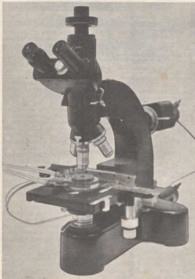
Fig. 110 - Raffreddamento di una cultura batterica da osservare al microscopio.
