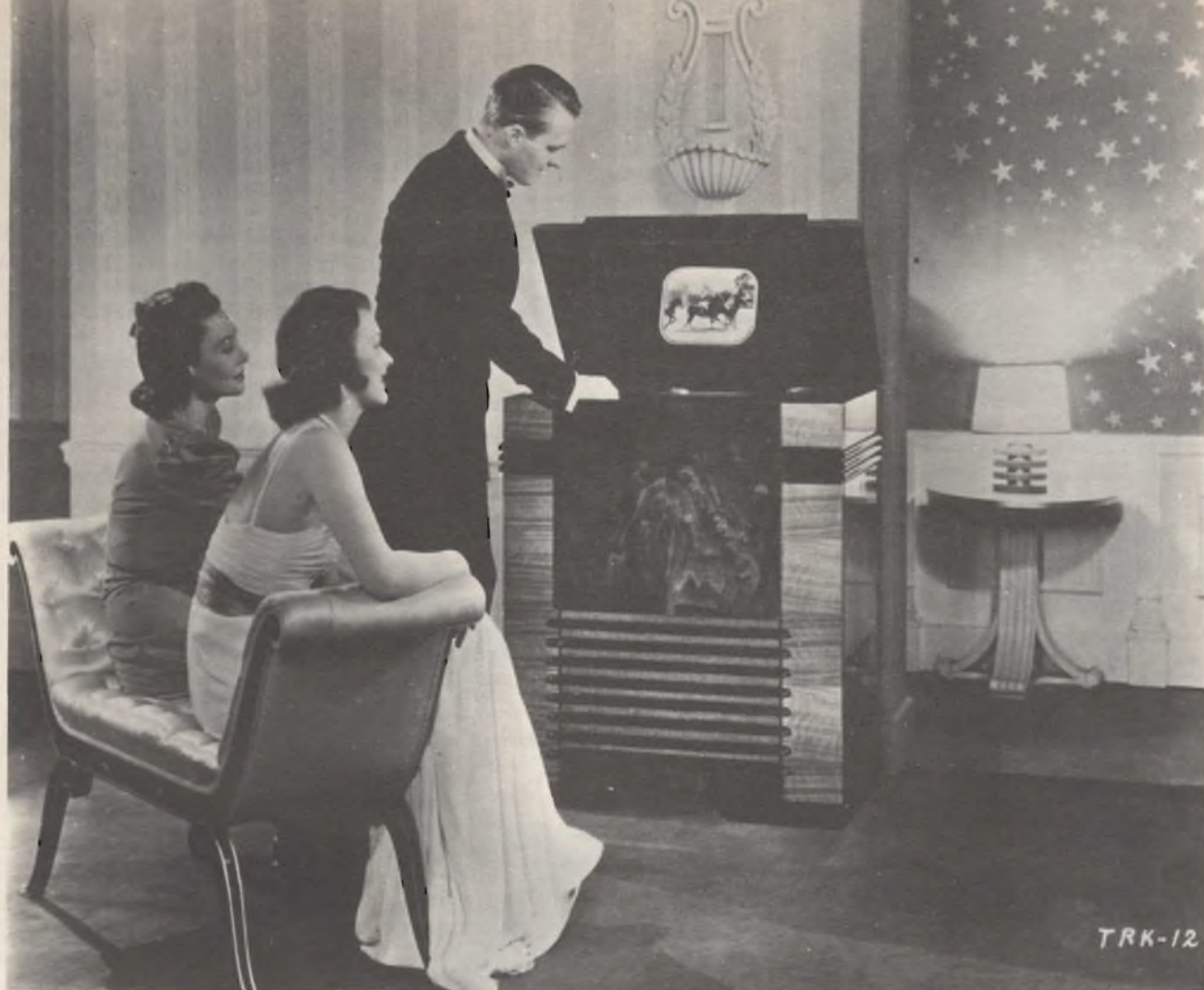
Fig. 17 - Televisore a visione riflessa del 1939. Le immagini venivano rilette dal cinescopio su di uno specchio fissato sul coperchio del mobile.
