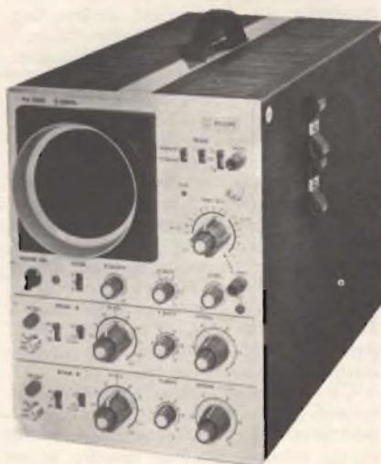
Fig. 16 - L'oscilloscopio a doppio raggio modello PM320 visto esternamente.
