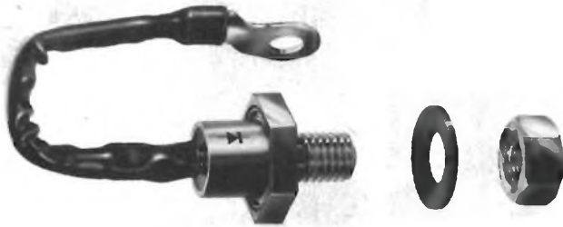
Fig. 132 - Tipico diodo raddrizzatore al silicio per correnti con valore nominale da 20 a 2 A, e tensione nominale di 400 V.
