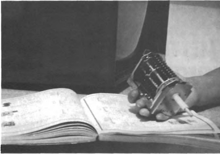
Fig. 2 - I «tamburi» sovente prevedono alcuni alloggiamenti vuoti per l'aggiunta di «biscottini» portabobine supplementari.
