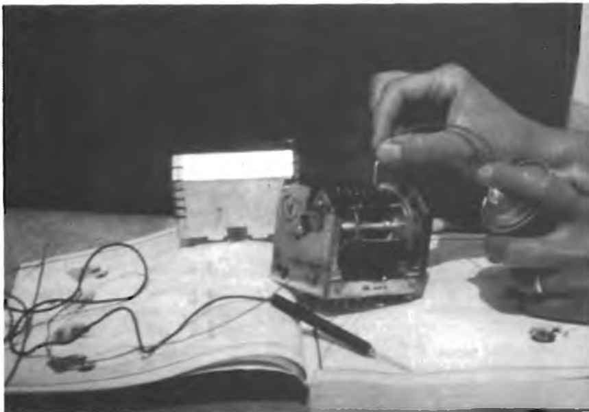
Fig. 6 - Deterzione dei contatti effettuata mediante Spray apposito. Si noti il tubicino applicato al cappuccio della bombola, che porta il liquido direttamente nel punto da pulire.
