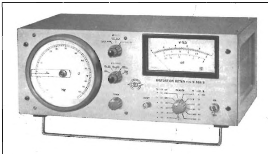
Fig. 2 - Distorsiometro della TES modello D 566 B, gamma di frequenza da 10 Hz a 1 MHz. millivoltmetro con campo di misura da 1 mV a 300 V.
