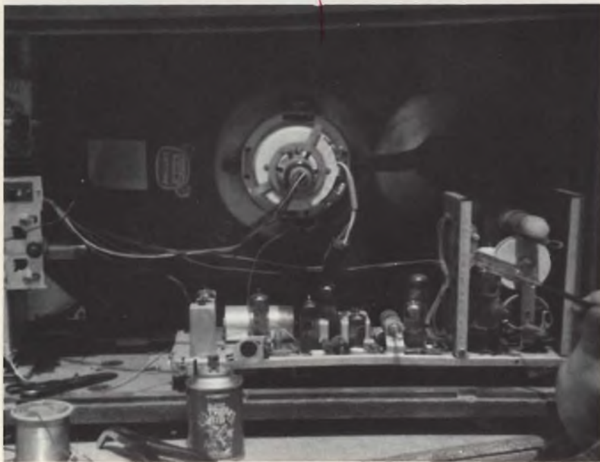
Fig. 6 - Se non è disponibile un voltmetro per misurare l'EHT, una verifica sbrigativa è avvicinare il manico di un cacciavite ad alto isolamento al cappuccio del finale di riga. Se il tutto funziona regolarmente, si vedranno sprizzare scintilline tra le due superfici isolate.
