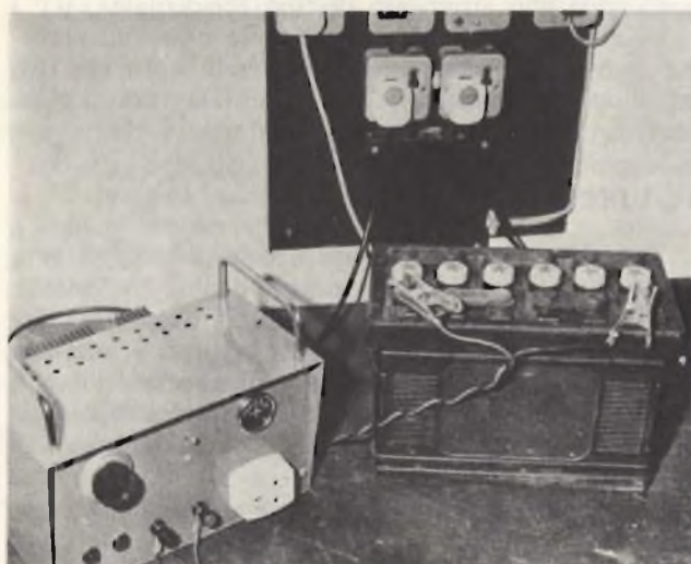
Fig. 6 - Il secondo esemplare realizzato dall'autore, racchiuso in un contenitore di tipo adatto, e facente uso di un potenziometro di regolazione a struttura circolare, e di un doppio deviatore per la commutazione.
