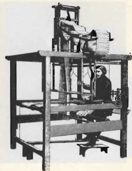
Fig. 8 - Il telaio per tessitura Jaaquard, da un disegno dell'epoca, controllato con schede perforate il cui uso era stato introdotto nel 1728 dal francese Falcon. Si tratta di uno dei primi tentativi di automatizzazione tramite l'impiego delle schede perforate.
