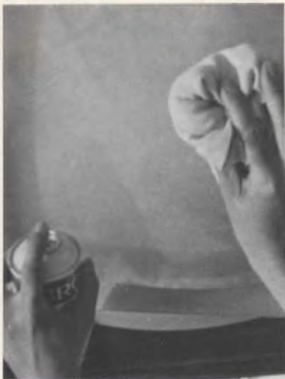
Fig. 10 - Anche il cristallo di protezione impiegato per i tubi che non recavano ancora la corazzina antiscoppio dovrà essere accuratamente deterso sin che non rechi il minimo «puntino nero» o sfumatura o segni di ditate etc. La presentazione estetica del televisore è forse tanto importante quanto l'accuratezza posta nel riattamento. In attesa di essere venduto, l'apparecchio sarà custodito in un sacco di plastica per soprabiti.
