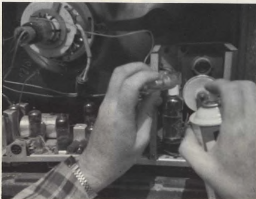
Fig. 8 - Il trasformatore di riga beneficia sempre di una buona passata di spray «anti-Corona». Meglio prevenire le possibili scricche.
