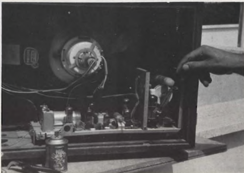
Fig. 3 - Anche se il finale di riga sembra funzionare bene, oltre ai controlli usuali, con l'apparecchio funzionante, converrà battere leggermente sul tubo di potenza. Se in tal modo all'interno della PL504 o altra simile, si nota qualche scintilla, il buon funzionamento non durerà a lungo se non si cambia la valvola. Poiché nell'interno della gabbia circolano tensioni molto elevate, l'arnese impiegato per dare i colpettini dovrà avere un isolamento particolare.
