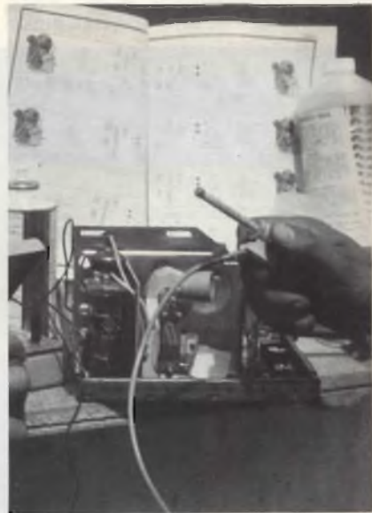
Fig. 1 - La revisione del settore EHT, oltre al cambio delle parti più soggette ad usura, deve essere comprensiva di una accuratissima pulizia di ogni contatto, nonché del controllo puntiglioso degli isolamenti. Vediamo nella foto uno chassis che impiega il rettificatore EHT solid-state, al posto del tubo ...
