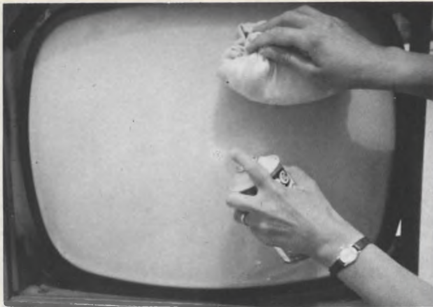
Fig. 9 - La superficie facciale del tubo dovrà essere accuratamente spolverata, poi lavata con uno spray per vetri.
