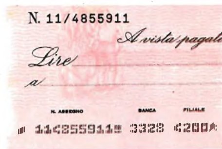
Fig. 7 - Applicazione pratica dei caratteri ottici per concettere all'elaboratore di riconoscere le caratteristiche di un assegno bancario.
