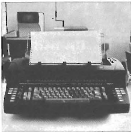
Fig. 8 - I terminali collegati con un elaboratore elettronico centrale mediante le normali linee telefoniche permettono il dialogo diretto con la macchina anche a grandissime distanze.
