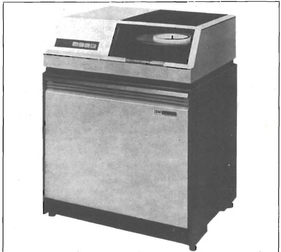
Fig. 5 - Unità a dischi magnetici intercambiabili in cui l'operatore può inserire e rimuovere un modulo composto da 6 dischi magnetici (IBM 2311 Discpac).
