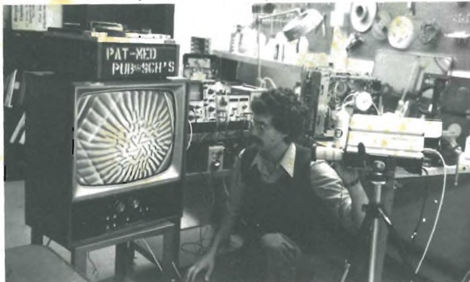
Fig. 1 - La foto illustra il tipico arrangemento necessario per il «feedback» ed una delle innumerevoli forme ottenibili. In questo caso, variando lo zoom, è stato possibile fare in modo che l'immagine assumesse forme ripetitive identiche.
