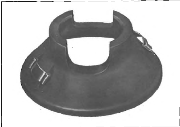
Fig. 20 - Aspetto caratteristico del nucleo in ferrite di una unità di deflessione per 20AX. Le svasature laterali servono per dare al campo di deflessione verticale la conformazione a barilotto richiesta.
