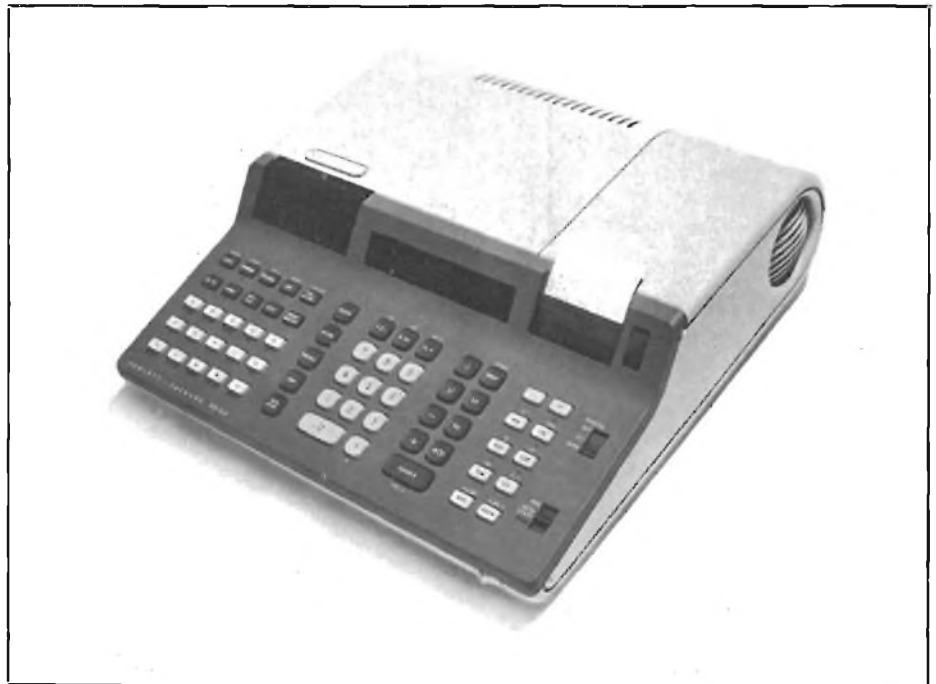
Fig. 5 - Calcolatore da tavolo programmabile, modello HP 9815, della Hewlett & Packard, per applicazioni scientifiche ed industriali munito di 10 registri numerici e memoria mista di 472 passi, estensibili a 2008 (ogni passo equivale ad un byte).
