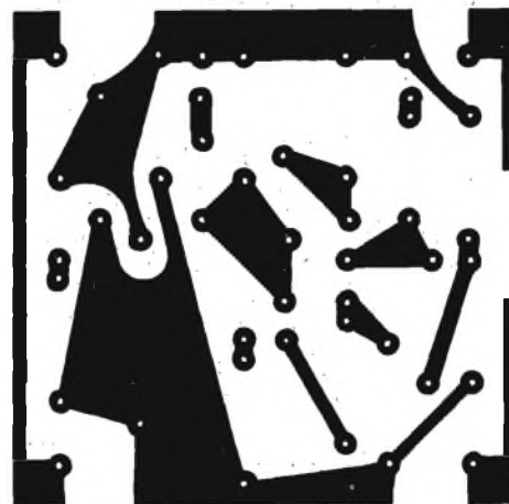
Fig. 23 - Circuito stampato al naturale visto dal lato rame.
