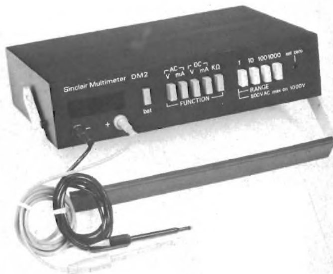
Fig. 1 - Aspetto frontale del nuovo multimetro digitale Sinclair modello DM2. I pulsanti per la scelta della portata e della funzione sono stati differenziati nel colore per rendere ancora più facile e razionale l'uso del dispositivo.
