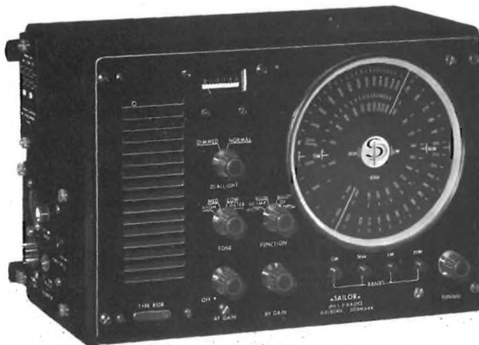
Fig. 1 - Ricevitore per radiocomunicazioni e radiogoniometria SAILOR - R108, onde lunghe 150 ÷ 20 kHz, 250 ÷ 430 kHz, onde medie 495 ÷ 1610 kHz, onde corte 1600 ÷ 4500 kHz.
