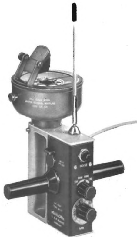
Fig. 2 - Sistema radiogoniometrico SAILOR BK 171, da abbinare al ricevitore R108 (Generalmare).
