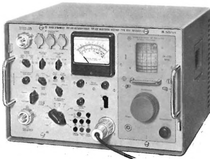
Fig. 3 - Ricevitore di controllo altamente professionale ESU della Rohde & Schwarz, 25 ÷ 1300 MHz.
