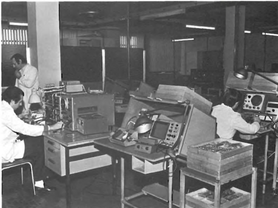
Fig. 5 - Questo è il banco sul quale viene effettuata la misura del fattore di intermodulazione.
