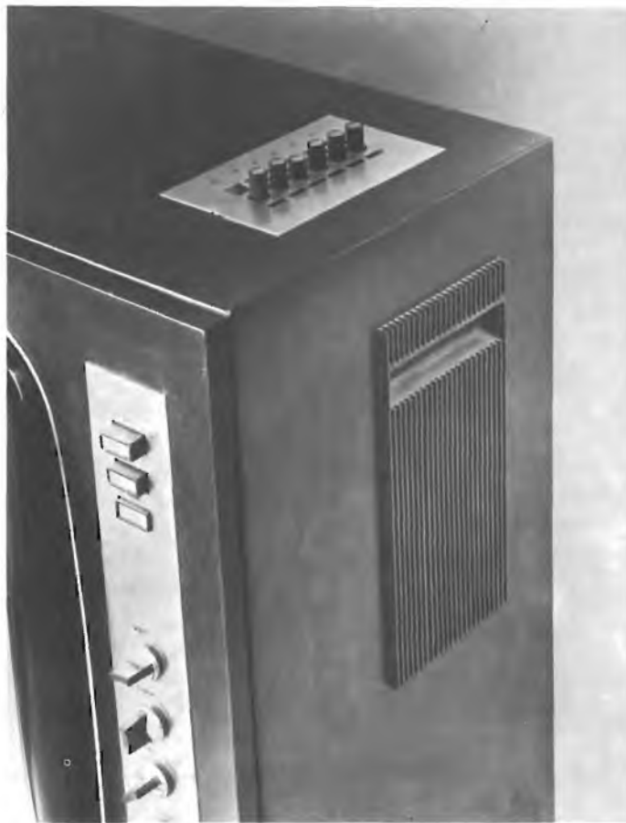
Fig. 45 - Esempio di applicazione di una tastiera potenziometrica tipo M6/B ad un vecchio televisore GBC.
