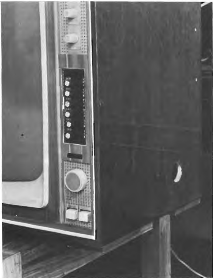
Fig. 43 - Esempio di adattamento di una tastiera potenziometrica tipo M6/B ad un televisore Admira 53015, di produzione Loewe Opta.
