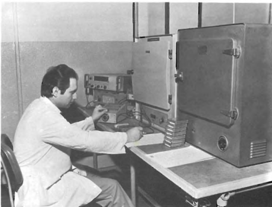
Fig. 6 - La moderna attrezzatura con la quale i gruppi selettori VHF-UHF vengono sottoposti ai controlli per la determinazione del fenomeno di deriva termica.
