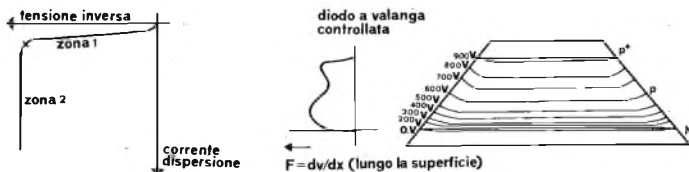
Fig. 234 - Diodo a valanga controllata: curva caratteristica e gradiente della tensione lungo il cristallo.
