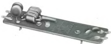
Fig. 25 - Fotografia del «balun» tramite il quale l'impedenza di antenna di 75 Ω è adattata al valore di 300 Ω, bilanciato.
