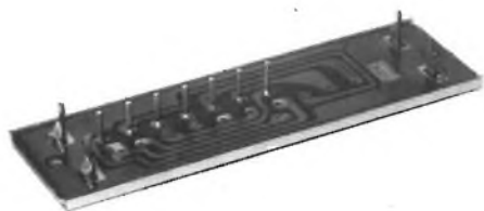
Fig. 24 - Aspetto tipico di una delle basette di adattamento da saldare sugli ingressi del sintonizzatore a «varicap» VHF-UHF per renderlo intercambiabile con gruppi a «varicap» di altre marche.
