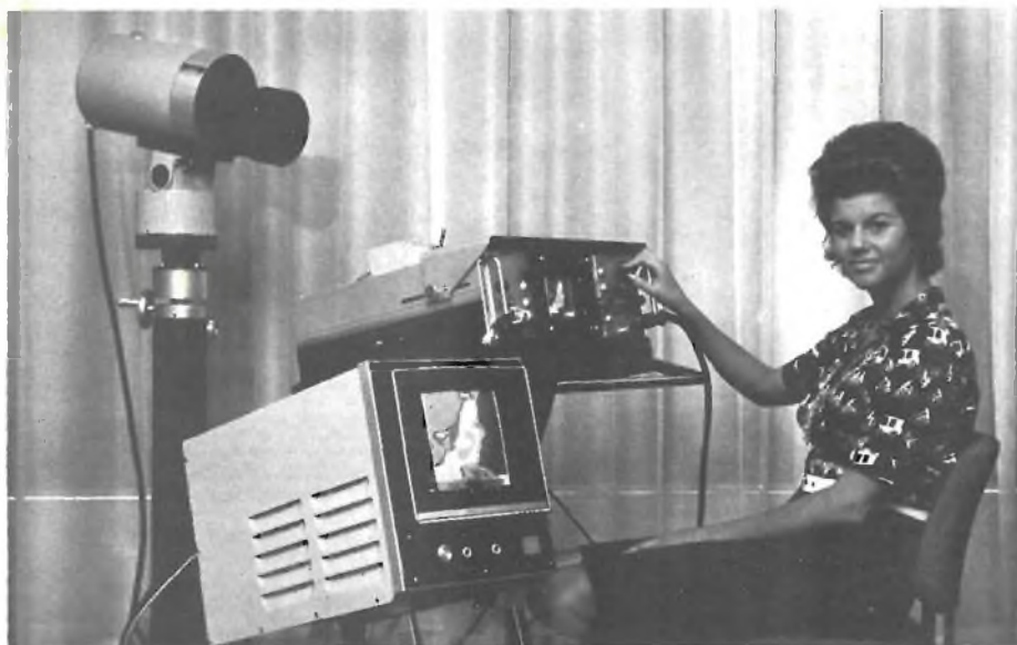
Fig. 7 - Monitor a colore per termovisione, della AGA THERMOVISION, modello 680 in grado di tracciare contemporaneamente 10 isoterme colorate.
