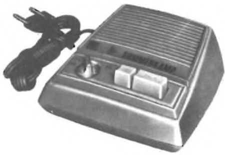
Fig. 5 - Interfonico ad onde convogliate Sommerkamp, modello IC-500 (G.B.C. ZR/6100-12). Potenza di uscita 300 mW, alimentazione 220 Vca.
