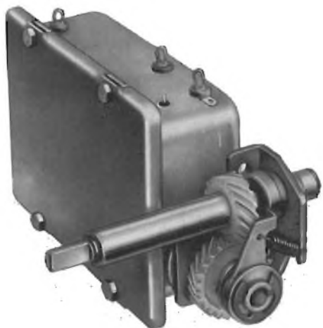
Fig. 12 - Fotografia del sintonizzatore UHF a transistori modello MG/0220-00; il medesimo gruppo è disponibile anche nella versione con comando lineare, col numero di catalogo MG/0230-00.
