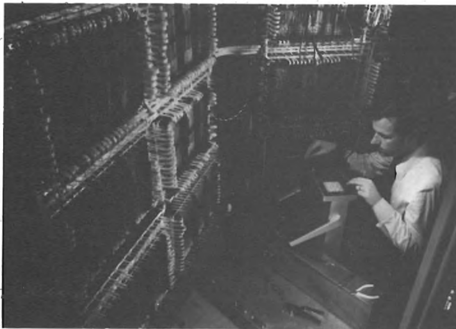
Fig. 8 - Gli oscilloscopi professionali del tipo descritto vengono impiegati per eseguire misure sul calcolatore elettronico Philips 7720. Risulta evidente l'ottima accessibilità al problema di misura che si ottiene con questo oscilloscopio di tipo compatto.
