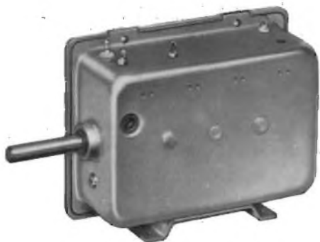
Fig. 15 - Fotografia del sintonizzatore UHF tipo MG/0170-00/180/190; che si distingue dal modello precedente per il fatto che la demoltiplica è stata installata all'interno del contenitore metallico.
