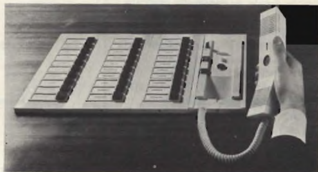
Fig. 7 - Centralino di portineria per l'omonimo servizio citofonico di «portiere elettronico».
