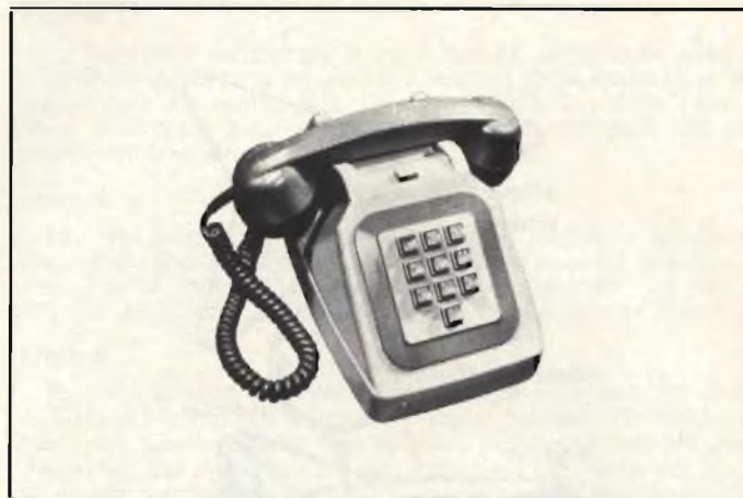
Fig. 8 - Un moderno telefono della C.I.T. in cui il disco combinatore è sostituito dalla pulsantiera.
