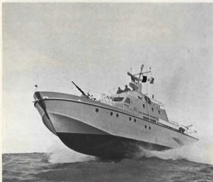
Fig. 9 - Un guardiacoste di altura della Guardia di Finanza, munito di radiotelefono, radiogoniometro, ecoscandaglio e radar.
