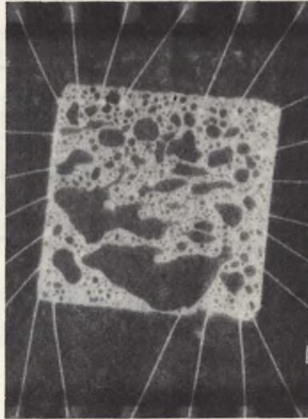
Fig. 12-B - Esempio di radiografia ad alta definizione, ottenuta con l'apparecchiatura citata su di un «chip» facente parte di un microelaboratore.
