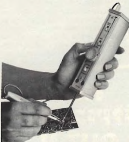
Fig. 2 - Il provatransistori di figura 1, usato per il controllo del circuito di una scatola di montaggio AMTRON.
