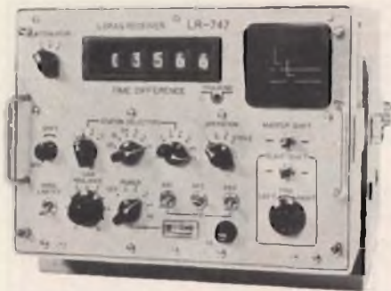
Fig. 15 - Ricevitore LORAN, modello LR 747, per la ricezione dei canali A e C. Indicazione digitale ad inseguimento automatico.
