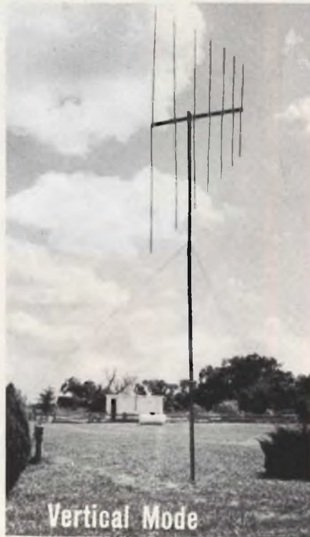
Fig. 4 - Antenna omnidirezionale HY-GAIN, modello V-4215, per frequenze 225 ÷ 400 MHz. Guadagno 4,5 dB. Potenza max 1 kW.
