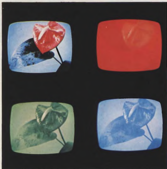
Fig. 19 - La ricezione da parte di un televisore in bianco e nero di una qualunque di queste tre componenti di colore primario non permetterebbe di riprodurre una fedele copia bianco e nero dell'immagine a colori trasmessa (a sinistra in alto).
