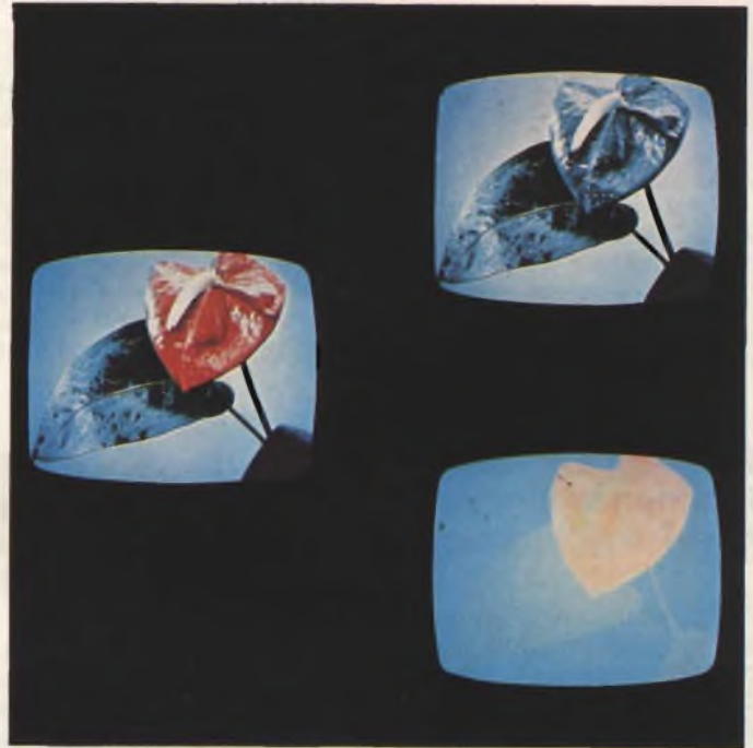
Fig. 21 - Per risolvere il problema della compatibilità diretta, il trasmettitore a colori dovrà irradiare due segnali: uno contenente la sola luminanza dell'immagine a colori (in alto a destra), e cioè un'immagine in bianco e nero; e l'altro contenente la sola crominanza dell'immagine a colori. Il televisore in bianco e nero utilizzerà solo la prima componente; quello a colori entrambe le componenti.
