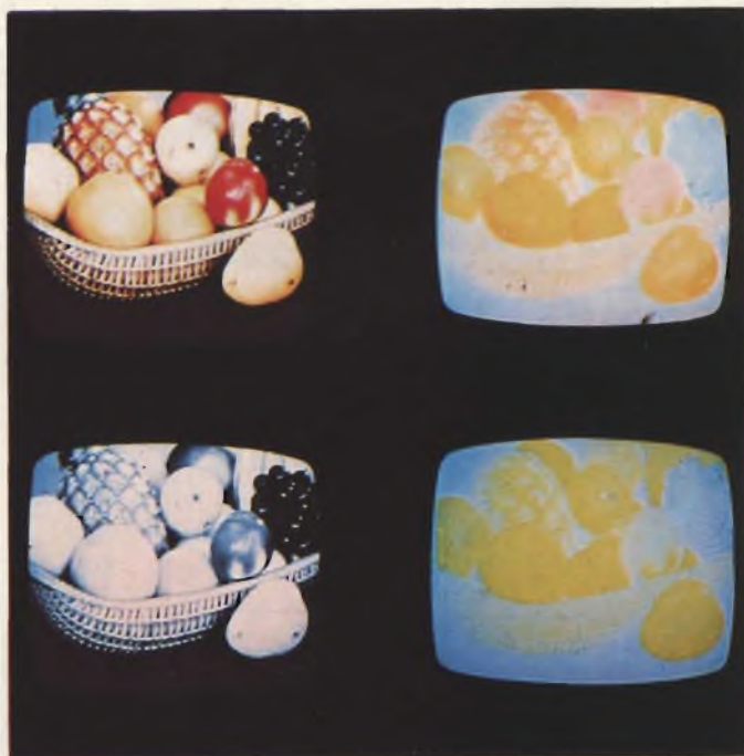
Fig. 27 - Serve a dimostrare che i due segnali differenza di colore del rosso (R-Y) e del blu (B-Y), che producono le rispettive immagini in alto e in basso a destra nella figura vengono trasmessi con una banda molto limitata (riproducono infatti solo aree colorate). L'immagine originaria nei suoi dettagli colori si ottiene con il concorso di queste due componenti di crominanza e della componente di luminanza (immagine in basso a sinistra), la sola che trasporta il dettaglio.
