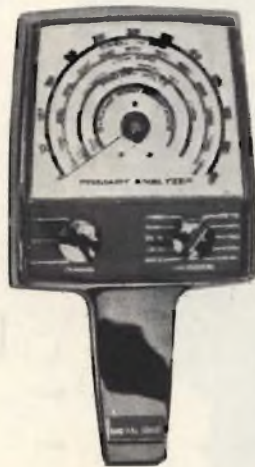
Fig. 2 - Analizzatore modello 4084 per controlli, statici e dinamici, del circuito primario di accensione. Questi analizzatori sono distribuiti dalla Automar.
