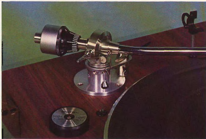
Dare il peso di appoggio alla testina ruotando il contrappeso posteriore. Inserire il pesetto dell'antiskating e regolarlo a seconda della forza di appoggio precedentemente data alla testina.
