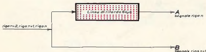
Fig. 60 - Sistema per poter disporre contemporaneamente dei segnali di crominanza della riga n e della riga n + 1 (che arriva 64 \mu s dopo). Il segnale di crominanza della riga n + 1 quando arriva sul punto B "trova" sul punto A il segnale di crominanza della riga precedentemente trasmessa (riga n ).
