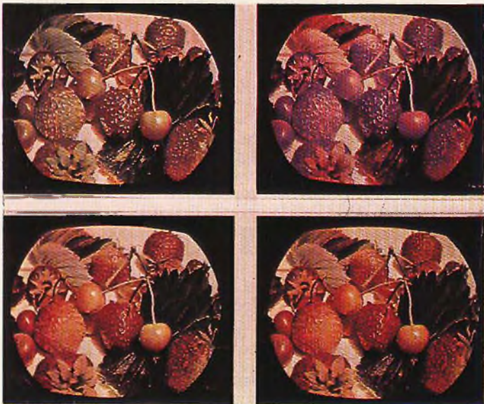
Fig. 48 (in basso a sinistra) - L'immagine ricevuta ha i suoi colori naturali, in quanto nel tragitto trasmettitore-ricevitore né il segnale del burst né il segnale di crominanza hanno subito rotazioni di fase. (In alto), come appare la stessa immagine nel caso in cui il segnale di crominanza abbia subito una variazione di +70^\circ (a sinistra) e di -70^\circ (a destra). (In basso a destra). Immagine riprodotta da un ricevitore PAL al quale è pervenuto il precedente segnale alterato ( \pm 70^\circ ).
