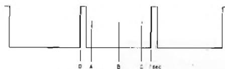
Fig. 8 - Differenti probabilità di inserzione dell'impulso di partenza.
