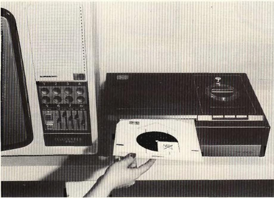
Fig. 2 - Il videogrammofono TED mod. TP 1005 della Teldec, durante l'operazione d'avviamento.
