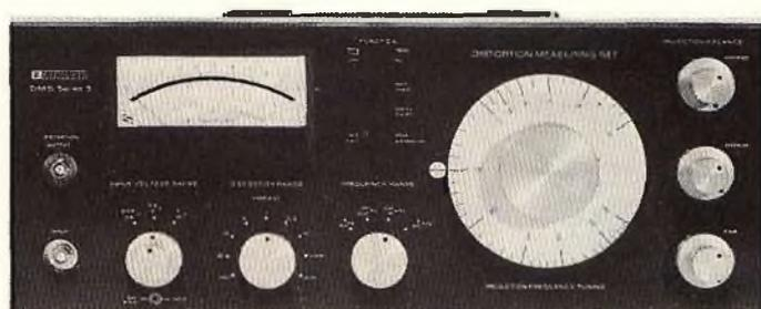
Distorsimetro di bassa frequenza tipo DMS Serie 3 per misure di bassissime distorsioni.
