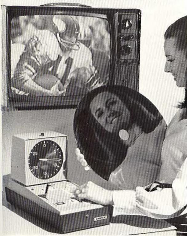
*Fig. 9 - Il principio magnetico è stato esplorato dalla Sony e MDR; il videodisco magnetico, comunque, viene attualmente impiegato per usi di broadcasting professionali. Nella foto è indicato l'apparato videodisco per l'Instant replay (ripetizione istantanea) dell'Ampex mod. HS-100B.*
