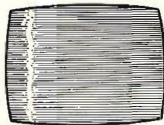
Fig. 3 - Tipico effetto di una scarica «corona» sul raster.
