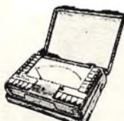
Novo Test «Cassinelli» Mod. TS 161. Sensibilità: c.c.: 40.000 \Omega /V - c.a. 4.000 \Omega /V. Portate raddoppiabili. Campi di misura e portate. Tensioni c.c.: 0,15 - 1 - 1,5 - 5 - 30 - 50 - 250 - 1.000 V. Tensioni c.a.: 1,5 - 15 - 50 - 300 - 500 - 2.500 - 1.500 - 2.500 V. Correnti c.c.: 50 \mu A - 0,5 mA - 5 mA - 50 mA - 500 mA - 5 A. Correnti c.a.: 250 \mu A - 50 mA - 500 mA - 5 A. Capacità: 0-0,5 - 0-50 - 0-500 - 0-5.000 \mu F. TS/2440-01
