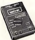
Tester digitale «Hloki» Mod. 3201. Display a cristalli liquidi. Circuiti integrati. Campi di misura e portate: Tensione c.c.: 200 mV - 2.000 mV, 20 V - 200 V, 200 V - 1.000 V. Tensione c.a.: 200 mV - 2.000 mV, 20 - 200 V, 200 - 500 V. Corrente c.c. e c.a.: 200 \mu A - 2.000 \mu A, 20 mA - 200 mA. Resistenza: 2 k \Omega - 20 k \Omega , 200 k \Omega . Alimentazione: 4 pile da 1,5 V, pre-TS/2106-00
