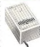
Alimentatore stabilizzato per convertitori e amplificatori d'antenna. Potenza: 100 mA. Ingresso: 220 V - 50 Hz. Uscita: 12 V. Dimensioni: 68x60x40.
