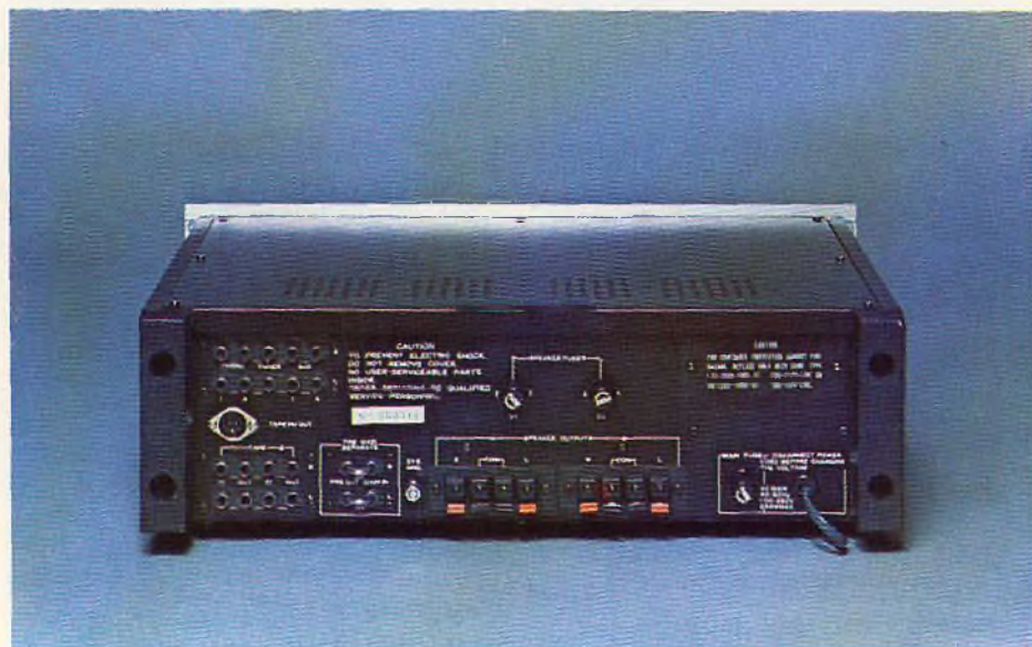
B - Pannello posteriore dell'amplificatore Lenco A 50. Comodi i morsetti a pressione per il collegamento di due coppie di casse.
