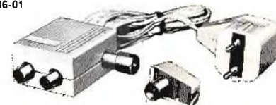
Amplificatore a modulo 2x75 Ω «Stolle» Mod. SAV-3303. Adatto per il collegamento di 2 televisori ad un unico cavo d'antenna. Ingresso canali: 2+65 (47+830 MHz). Guadagno: 12 dB. Uscita max: 50 mV. Alimentazione: 220 V - 50 Hz.
