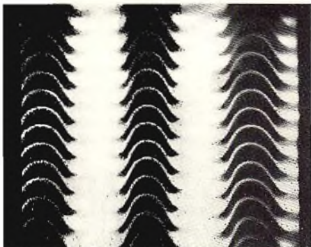
Fig. 6 - Superficie del videodisco Philips-MCA ottenuta con il nuovo processo polimerico della MCA.
