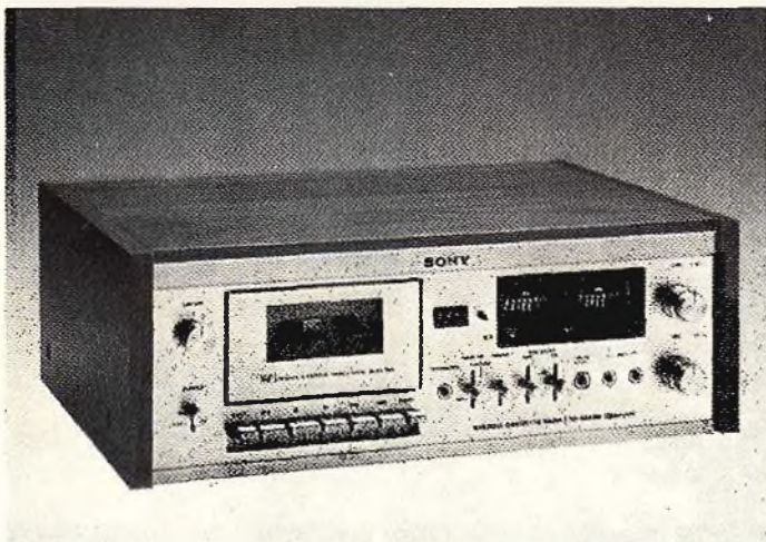
Registratore Sony TC-204SD. Nonostante i valori numerici migliori, il registratore è più rumoroso del giradischi. Consigliamo apparecchi provvisti di sistema «Dolby» (o equivalente) per la riduzione del rumore.
