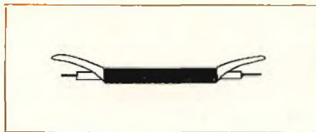
Fig. 3 - Preparazione dei due spezzoni di cavetto schermato.
