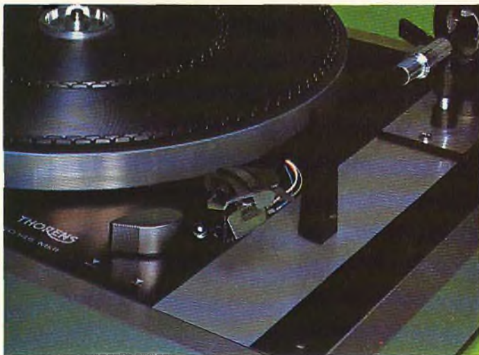
Comando che alza e abbassa il braccio di lettura e testina Stanton 681 EEE montato sulla conchiglia.
