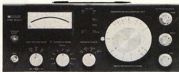
Distorsionmetro di bassa frequenza tipo DMS Serie 3 per misure di bassissime distorsioni.
