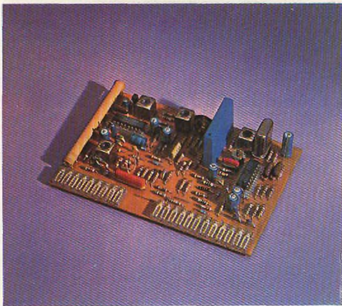
Fig. 42 - Decoder realizzato con due soli circuiti integrati: il TDA 2560 (combinazione funzioni luminanza + crominanza) e il TDA 2522 (combinazione demodulatori sincroni + segnali di riferimento + altre funzioni). È stato realizzato dai Laboratori della Philips-Elcoma e fa parte del progetto del televisore realizzato secondo il sistema 20 AX, un sistema autoconvergente.
