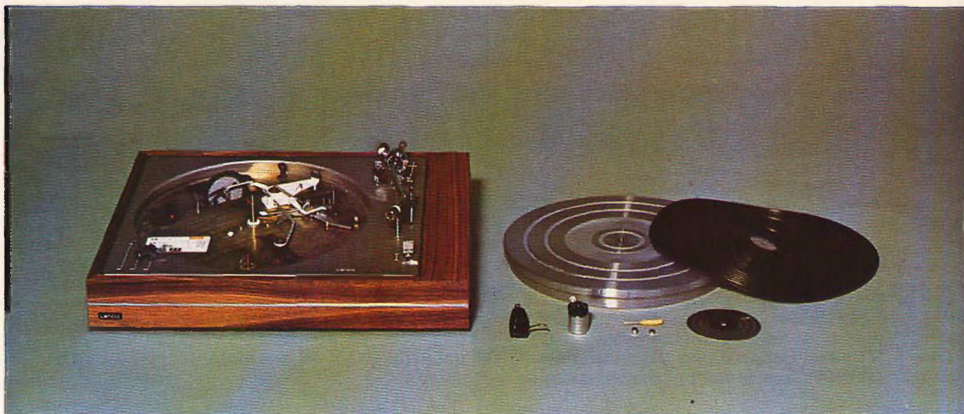
Giradischi Lenco L78-SE completamente smontato. Si noti il disco stroboscopico per controllare la precisione delle velocità di rotazione del piatto.
