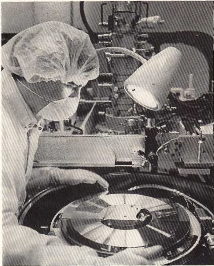
Fig. 6 - Un tecnico dell'RCA mentre prepara il disco master per solcatura tramite diamante e fotoincisione EBR, nella fabbrica di Indianapolis.
