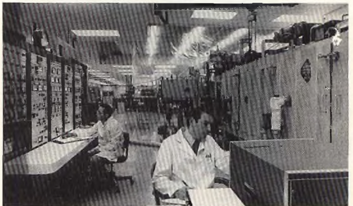
Fig. 9 - La foto mostra l'Auto Coater di Indianapolis. A sinistra il pannello di controllo, a destra la macchina per i processi di stratificazione.
