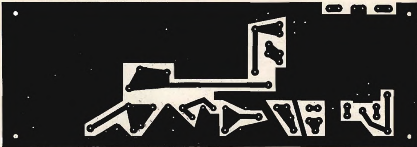
Fig. 3 - Disegno delle piste ramate della basetta stampata su cui è montato il survoltore.
