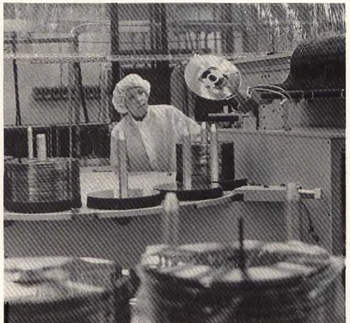
Fig. 10 - Dall'Auto Coater escono i dischi finiti. A questo punto il videodisco assume un colore dorato, per via dello strato metallico e quello lubrificante. I piccoli canali incisivi riflettono la luce a forma spettrale con un effetto molto suggestivo. La fase che segue è l'incollatura dell'etichetta e catalogazione. Il videodisco mostrato nella foto è uno dei più recenti. In precedenza questo veniva prodotto con una sola apertura centrale.
