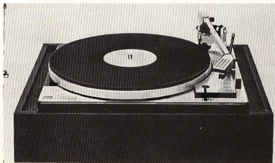
Fig. 6 - Quest'apparecchio non è cambiadischi: perché un così elevato errore di parallelismo?
