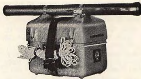
Fig. 7 - Un prezioso apparecchio per la navigazione da diporto e di emergenza. Il LIFEBOAT RMGK 65, HAGENUK (Apel-Mar). Trasmissione su tre frequenze internazionali di soccorso: 500 kHz, 2181 kHz e 8364 kHz. Generatore a manovella. Potenza di uscita 1,5 \div 3,5 W. Doppia antenna. Contenitore galleggiante.
