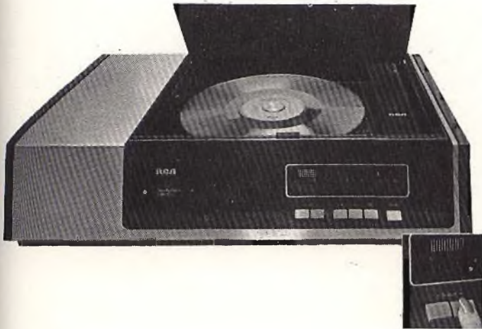
Fig. 17 - Il videogrammofono Selecta-Vision dell'RCA. Appena si chiude il coperchio e si preme il pulsante «Play» (dopo aver premuto quello d'accensione «Power»), un braccio porta-cartuccia esce dalla custodia (il rialzo a destra) e la puntina si adagia sul disco. La parte illuminata del quadrante indica i minuti trascorsi dall'inizio della rappresentazione. Il quadrante serve anche per aiutare la «ricerca» (Search). Alla fine del disco (dopo 30 minuti), il braccio ritorna automaticamente nella custodia. A questo punto si gira il disco per la rappresentazione del secondo lato. L'RCA non prevede un cambiadisco automatico.
