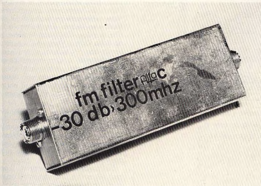
Prototipo del filtro armonico per emittenti locali a costruzione ultimata.
