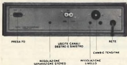
Fig. 13 bis - Vista posteriore con le prese e gli attacchi del sintonizzatore per filodiffusione ELA 43-18.
