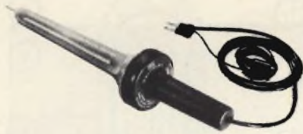
Fig. 8 - Esempio di sonda per alta tensione adatta per misure fino a 40 kV. Ha una resistenza d'ingresso di 1000 M. Divide la tensione d'ingresso per 1000.
