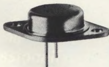
Fig. 17 - Caratteristiche del transistore BD 117 impiegato in questo prototipo. Questo modello può essere sostituito dal tipo BD1182.
