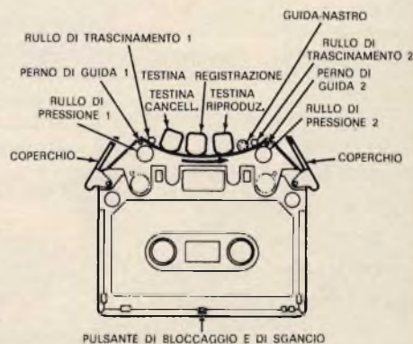
Fig. 5 - Il meccanismo di trasporto di un nastro prevede l'apertura di due piccoli coperchi laterali, e spinge il nastro al di fuori del contenitore in materiale plastico.
