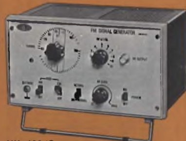
UK 460/S Generatore di segnali FM 80 ÷ 109 MHz
