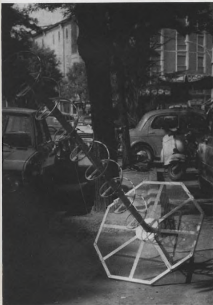
Fig. 4 - Vista d'assieme dell'antenna ad elica realizzata dall'autore per la base dell'Aeronautica Militare di Sestola; l'antenna opera nella banda di frequenze comprese fra 340 e 430 MHz.
