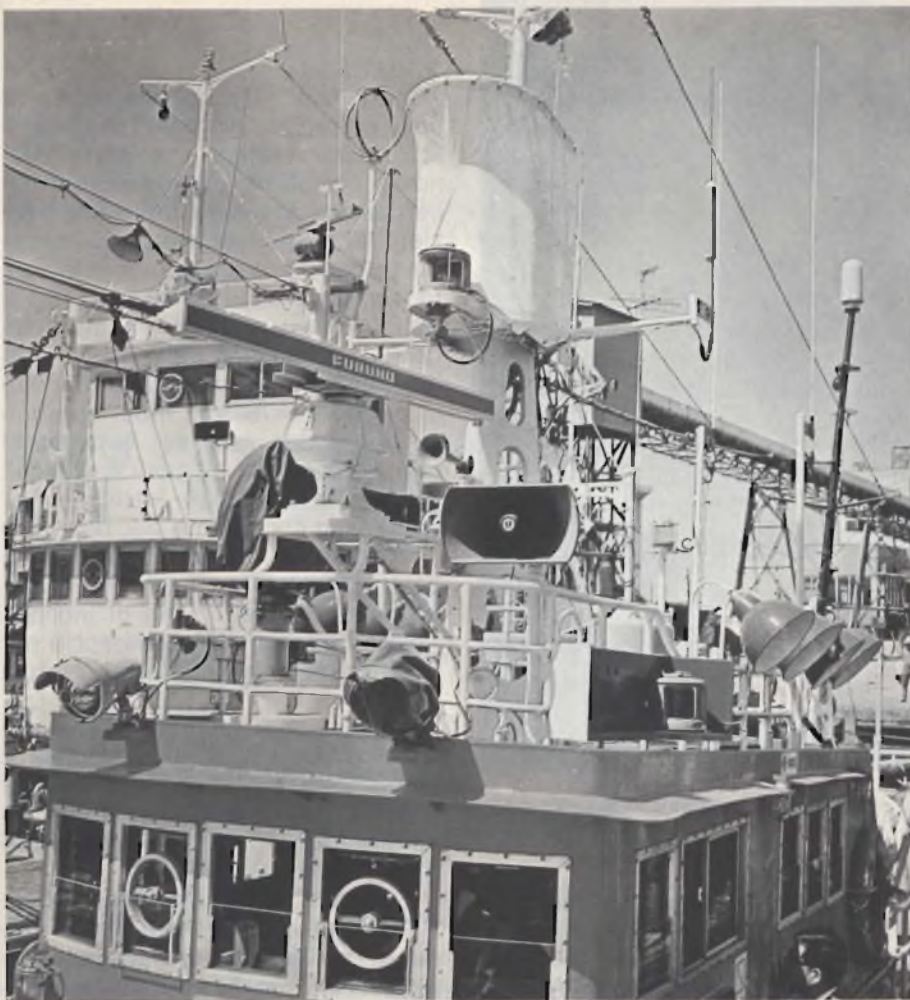
Fig. 6 - Nave passeggeri dotata di moderni impianti di radiocomunicazione e radionavigazione, con servizio radio continuo (4 ufficiali RT). Foto SIRM, Società Italiana Radio Marittima, Genova.
