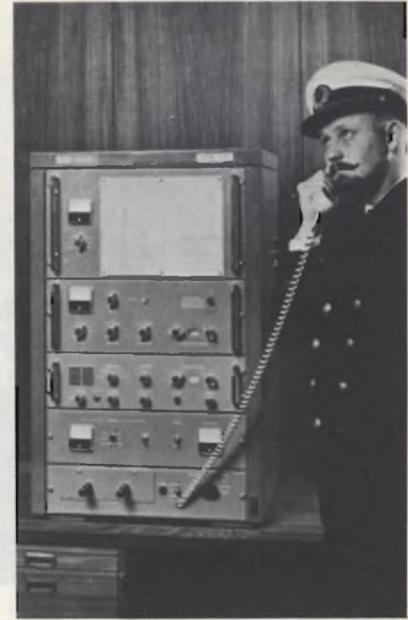
Fig. 5 - Moderno trasmettitore delle bande marine comprese nelle gamme 1600 ÷ 3800 MHz e 4 ÷ 24 MHz.
