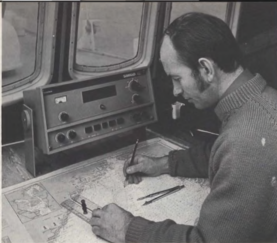
Fig. 9 - Apparecchio ricevente per il sistema di navigazione Loran C (foto Eltamar Genova).
