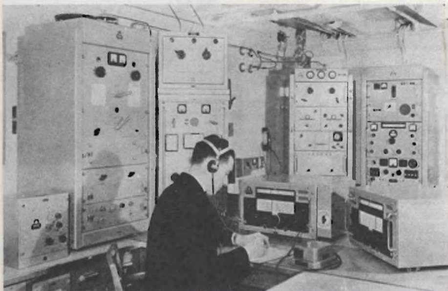
Fig. 2 - Cabina radio di un moderno transatlantico. In questo caso i trasmettitori sono stati costruiti dalla Marconi ed i ricevitori dalla Atalanta.
