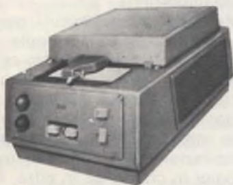
Fig. 7 - Apparecchio per la cifratura dei messaggi telex via radio, inseribile fra telescrivente e teleinseritore, modello Hell 508.
