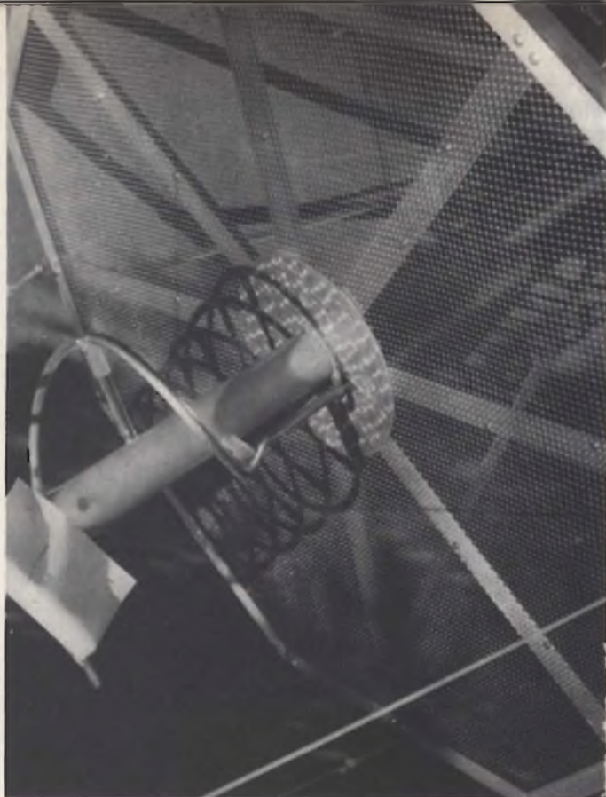
Fig. 6 - Particolare del capo caldo del radiatore dell'antenna; notare i bastoncini in plastica che irrigidiscono la struttura ad elica.
