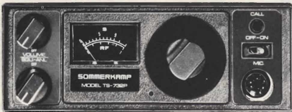
TS - 732 P 5 W - 32 canali - 11 - 16 Vcc e 110/220 Vca
