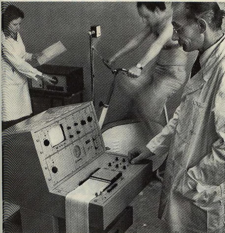
Fig. 13 - Complesso modulare ETA-SYSTEM CARDIOLINE, comprendente batteria, alimentatore, registratore 3 canali, programmatore ECG, preamplificatore fono, microfono, selettore polsi, trasduttore, sfigmoscillografo, oscilloscopio per foto, controllo frequenze ECG, indicatore e vari accessori.
