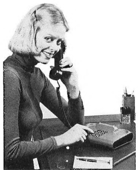
Fig. 14 - L'ultimo modello di telefono costruito in Danimarca. Possiede un regolatore di volume ed un amplificatore incorporato. Seleziona
