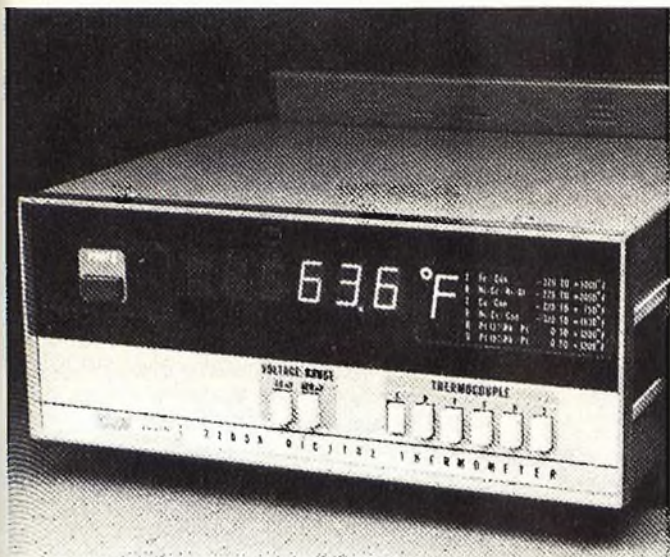
Fig. 9 - Termometro digitale modello 2100A-A6, a sei termocoppie, più due portate millivoltmetriche della FLUKE.
