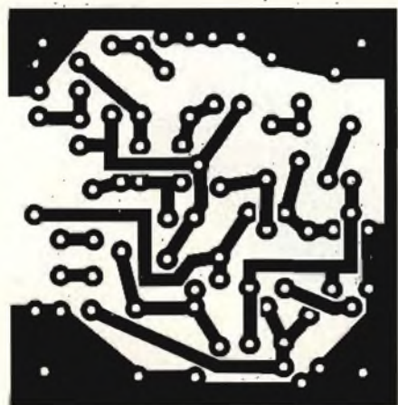
Fig. 2 - Disegno delle piste ramate della basetta stampata (scala 1 : 1) su cui è allestito il proiettore.
