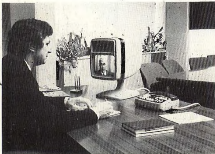
Fig. 2 - Esempio di installazione su di un tavolo di lavoro di un monitor, abbinato all'apparecchiatura telefonica di tipo convenzionale, comprendente anche i controlli di messa a punto, oltre al sistema di composizione del numero mediante pulsanti.
