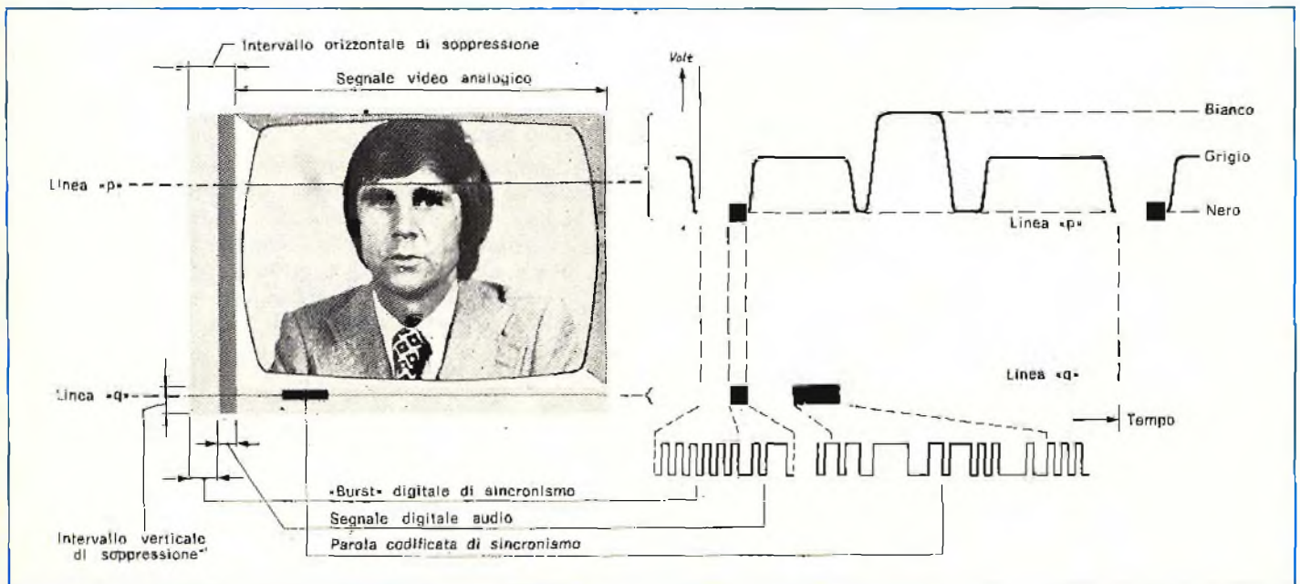
Fig. 4 - Relazioni che intercorrono tra un'immagine video-telefonica e le caratteristiche del segnale composto, che costituisce la trasmissione.
