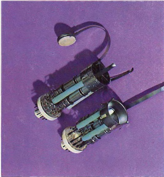
Fig. 69 - Fotografia di un sistema elettrodico di un cinescopio in-line (in basso) e di un cinescopio a delta (in alto). Nel sistema elettrodico dei cinescopi in-line sono scomparse le espansioni polari presenti all'uscita di ciascun cannone nei cinescopi a delta. Ciò per il fatto che nei cinescopi in-line gli errori di convergenza sono meno vistosi e sono dovuti esclusivamente alle tolleranze dei componenti impiegati, dato che per principio essi sono autoconvergenti.
