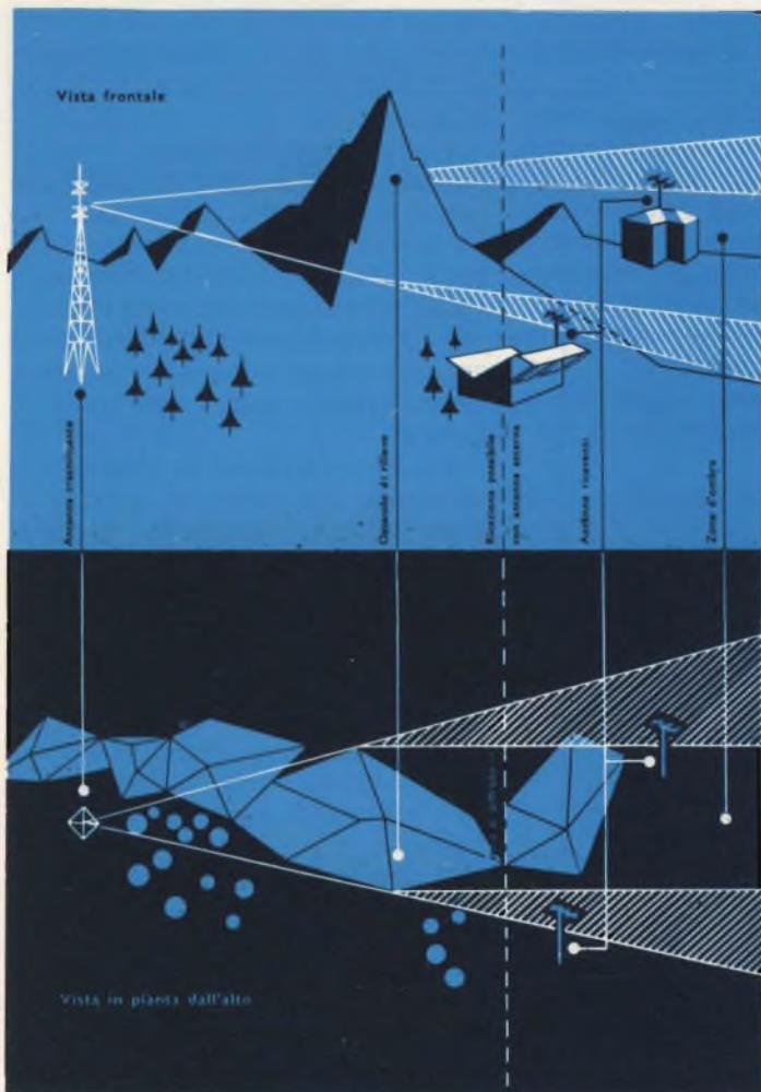
Fig. 5 - Classico esempio di propagazione per diffrazione di una emissione della gamma VHF. Alle due antenne riceventi pervengono i radiosegnali pur essendo l'antenna trasmittente coperta da un ostacolo.
