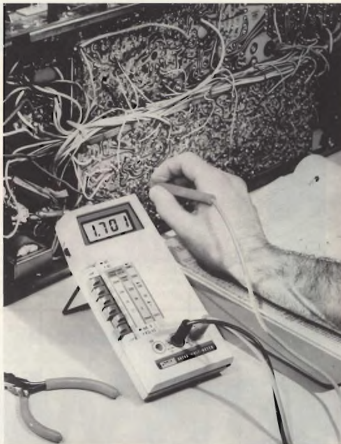
Il multimetro Fluke 8020A alla ricerca del guasto in un apparecchio TV.
