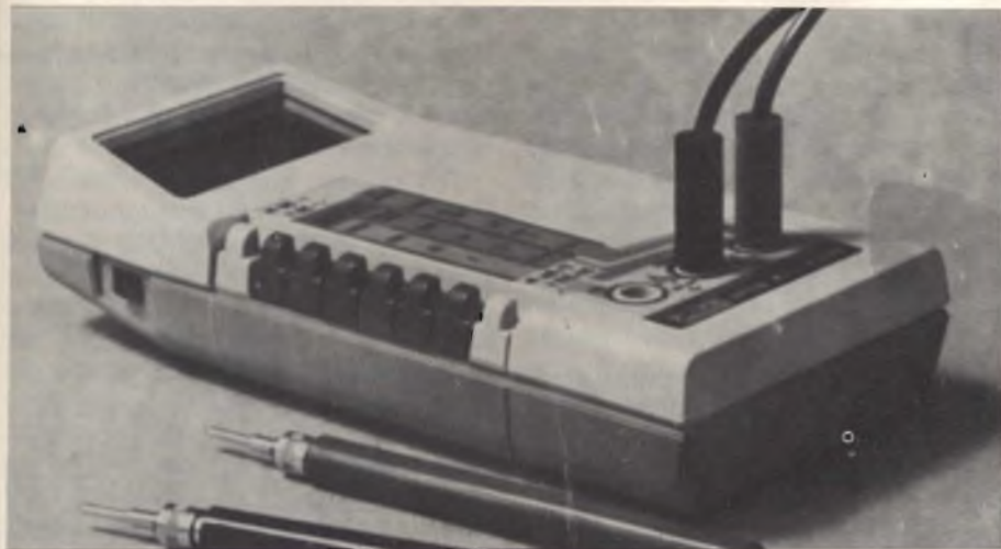
Fig. 1 - Fotografia del nuovo multimetro digitale Fluke, Modello 8020A: si notino la sobrietà della linea e la razionale disposizione dei commutatori di funzione e di portata.
