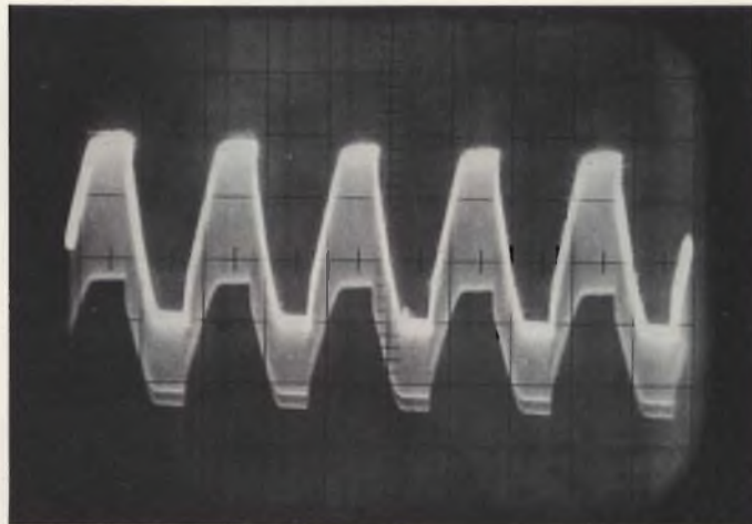
Fig. 7 - Clipping simmetrico delle linee di ritardo, corrispondente ad una corretta regolazione del bias delle linee stesse (condizioni di misura: frequenza della sinusoide: 1 \text{ kHz} ; oscilloscopio connesso al punto E: base tempi 0,5 \text{ msec./cm.} , deflessione verticale: 0,5 \text{ V/cm.} ).
