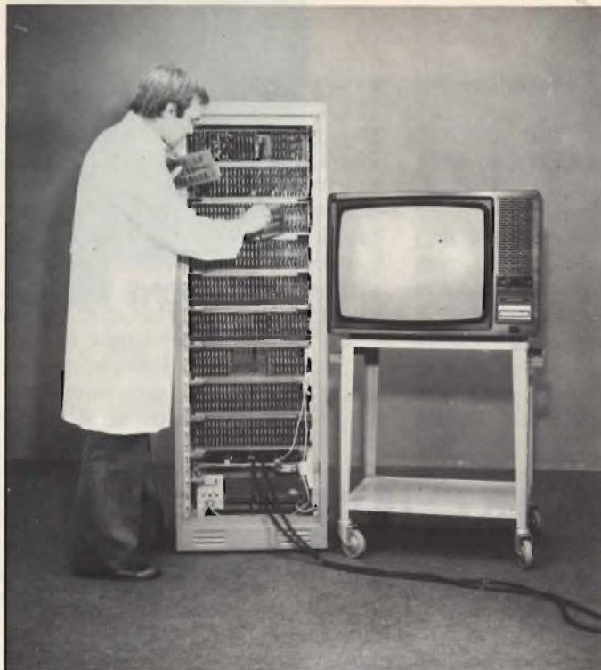
Fig. 2 - Primo prototipo di simulazione, che monta 5000 circuiti integrati TTL e consuma 170 A.
