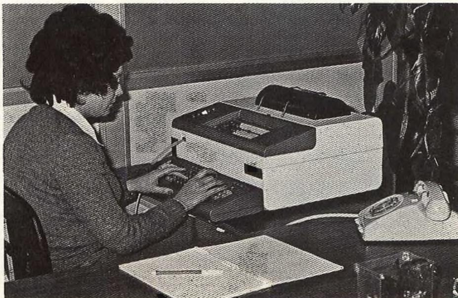
Fig. 1 - Una delle più moderne telescriventi elettroniche tipo start-stop, velocità 50 ÷ 100 baud: la GEME 2000.
