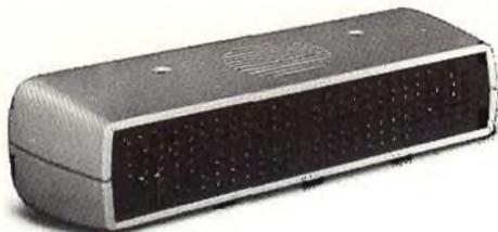
Funzionamento ad ultrasuoni. Area protetta mq. 20 con portata frontale di circa metri 7. Alimentazione 12 V c.c. 0,07 A. Protetto contro le manomissioni. Relè di allarme N.A. e N.C.. "Walk-test" acustico. Possibilità di introdurre integrazione segnale con ponte (2 sec.). Staffa orientabile a corredo. Possibilità di collegare fino a 4 unità aggiuntive tipo LHD 6021. Dimensioni: mm 230 x 60 x 100.
