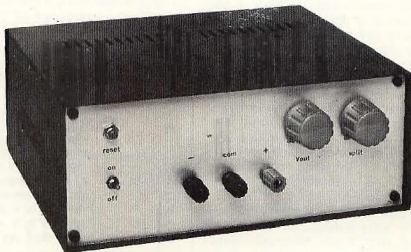
Prototipo dell'alimentatore splittato a realizzazione ultimata.
