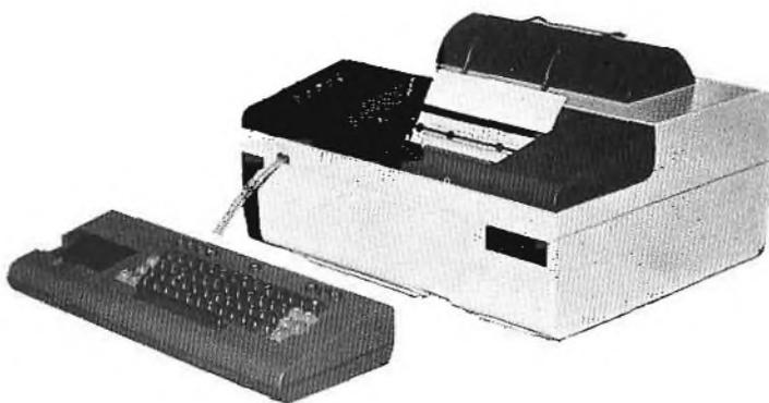
Fig. 3 - La telecrivente è adattabile ad ogni situazione ambientale: infatti l'unità TX è separabile dall'unità RX, che possono essere collegate fra loro tramite un cavo di adatta lunghezza.
