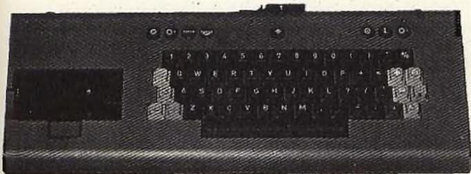
Fig. 4 - La sezione trasmittente, della telescrivente, con la tastiera ed il sistema opto-elettronico.
