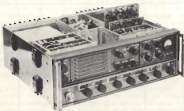
Fig. 1 - Rice-trasmittitore professionale modello GSB 900, per la gamma 1.600 ÷ 30.000 kHz in 284.000 canali sintetizzati a salti di 100 Hz. Potenza di picco 100 W.
