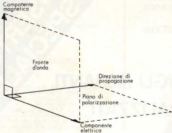
Fig. 1.1 Piano di polarizzazione di un'onda radio.
