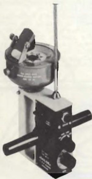
Fig. 22 - Antenna radiogoniometrica, con bussola di rilevamento Sestrel, per il ricevitore Sailor R105 di cui alla figura 13.
