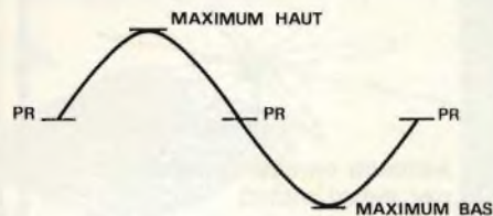
Fig. 2-A - Analisi dei punti di riferimento di un'oscillazione sinusoidale completa, compresa tra l'inizio e la fine di un ciclo.
