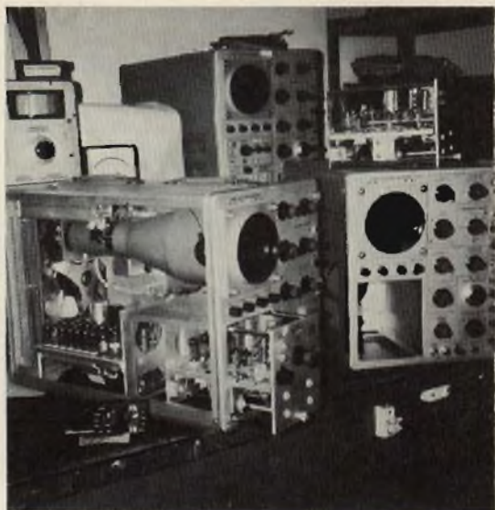
Fig. 8 - Riparazione di oscilloscopi Tektronix 545 A e loro messa a punto (cortesia De Rica Elettronica - Roma).
