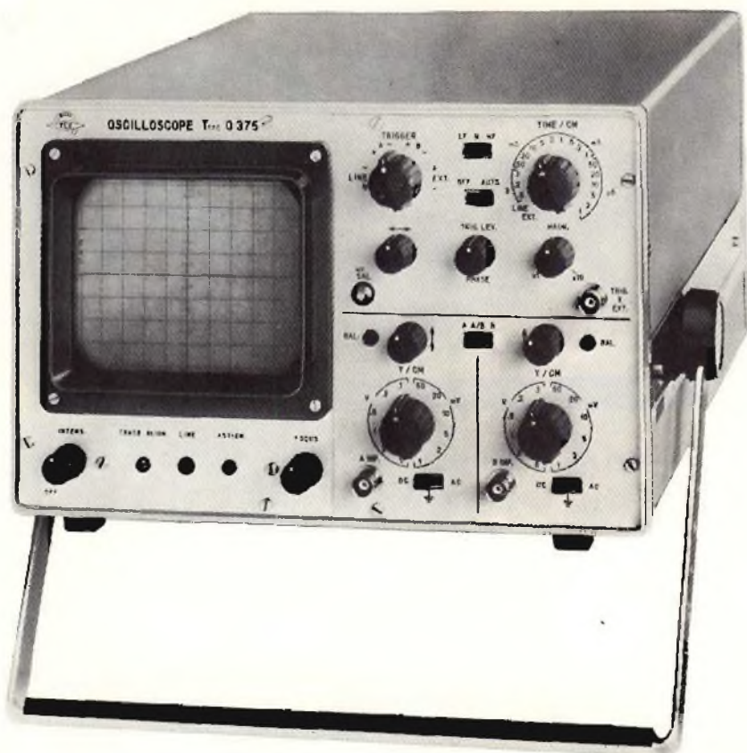
Fig. 6 - L'oscilloscopio a doppia traccia 0 375 prevede uno schermo a struttura quadrata disposto nell'angolo superiore sinistro, mentre gli altri comandi sono raggruppati sul pannello laterale ed al di sotto dello schermo, in modo da rendere l'impiego dello strumento assolutamente intuitivo.
