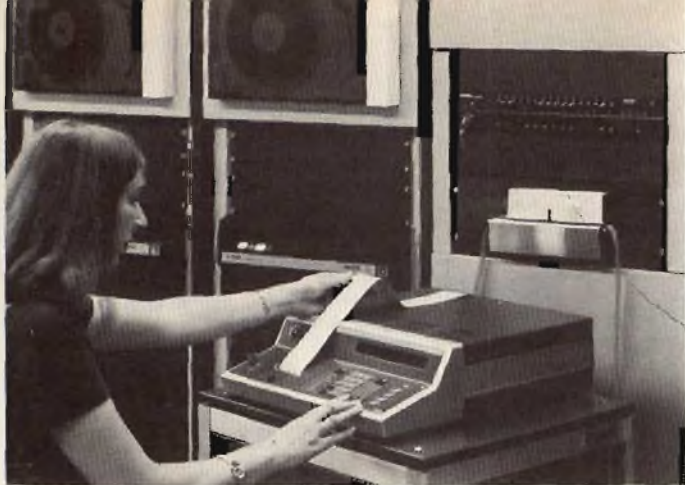
Il data logger PM 4000 direttamente interfacciato con un mini-computer P 851 per l'elaborazione diretta dei dati acquisiti.
