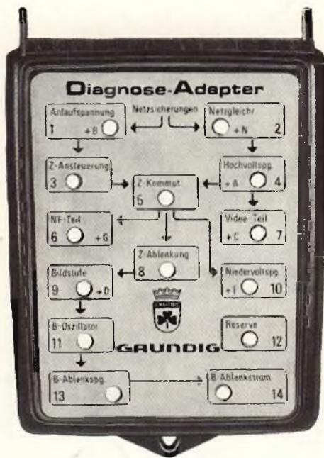
Fig. 9 - Il diagnosiadapter, un sistema per la diagnosi immediata delle anomalie nei TV a colori.
