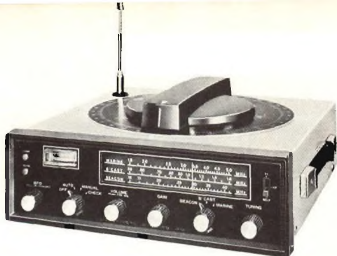
Fig. 13 - Radiogoniometro portatile FURUNO , modello T-P248 (Società Italiana Radio Marittima, S.I.R.M.) Gamme 160 ÷ 410 kHz, 550 ÷ 1600 kHz, 1800 ÷ 5000 kHz. A1, A2, A3, SSB.
