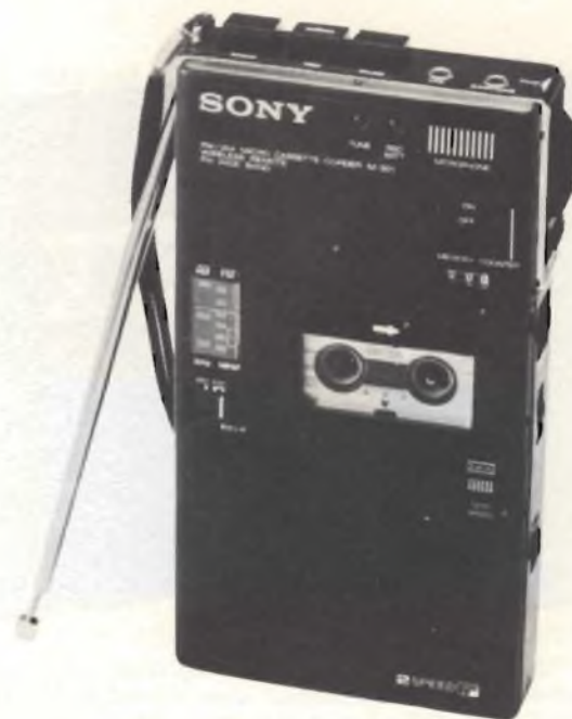
Fig. 9 - Una delle più interessanti realizzazioni della Sony nel campo dei micro-registratori consiste in questo modello a due velocità, contenente anche un radio ricevitore con possibilità di registrazioni dirette.
