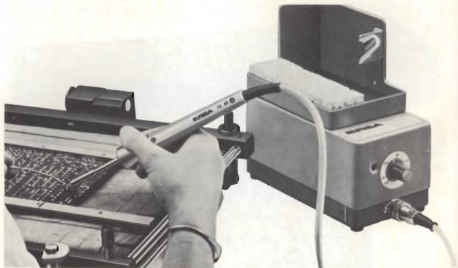
Fig. 10 - Stazione di saldatura a temperatura controllata elettronicamente, con punta in acciaio di lunghissima durata ERSA TE 50 (GBC ITALIANA).
