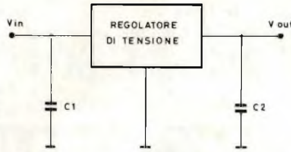
Fig. 4 - Connessione standard di un regolatore di tensione a circuito integrato.
