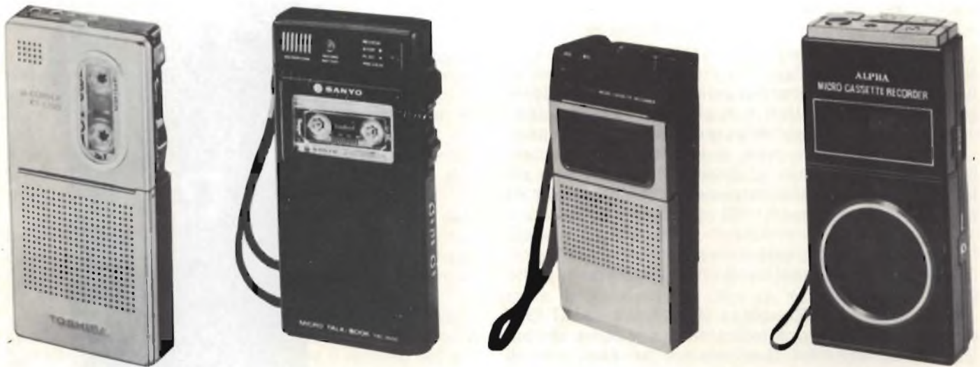
Fig. 8 - Quattro esemplari di micro-registratori a nastro, funzionanti con sistema di trascinamento di tipo periferico: a partire dalla sinistra, il modello KT-1300 della Toshiba; il modello TRC-3500 della Sanyo, con dispositivo di allarme di fine nastro; il modello CS-696 della Fair Mate, ed il modello MTC-500, della Alpha International.
