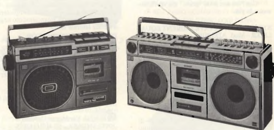
Due apparecchi SHARP/HA.SA.CO.: GF 9090H, radioregistratore stereo con 4 gamme d'onda, APSS ricerca automatica della musica sul nastro, registrazione stereo anche dall'esterno, 4 altoparlanti con sistemi a due vie, tasto di inserzione spazio, di pausa meccanico, controlli a cursore separati per alti e bassi, sistema nuovo per localizzare velocemente tratti di registrazione. Recentissimo è il radioregistratore GF 3700F, con tre gamme d'onda: APSS, unico tasto per la registrazione, tasto di pausa meccanico, selezione di pezzi incisi facile e veloce. Si tratta di due apparecchi in linea con il programma della ditta che annovera soprattutto apparecchi di medio-alto livello, che, secondo quanto ci ha dichiarato il sig. David Hasbani sono sempre più richiesti.
