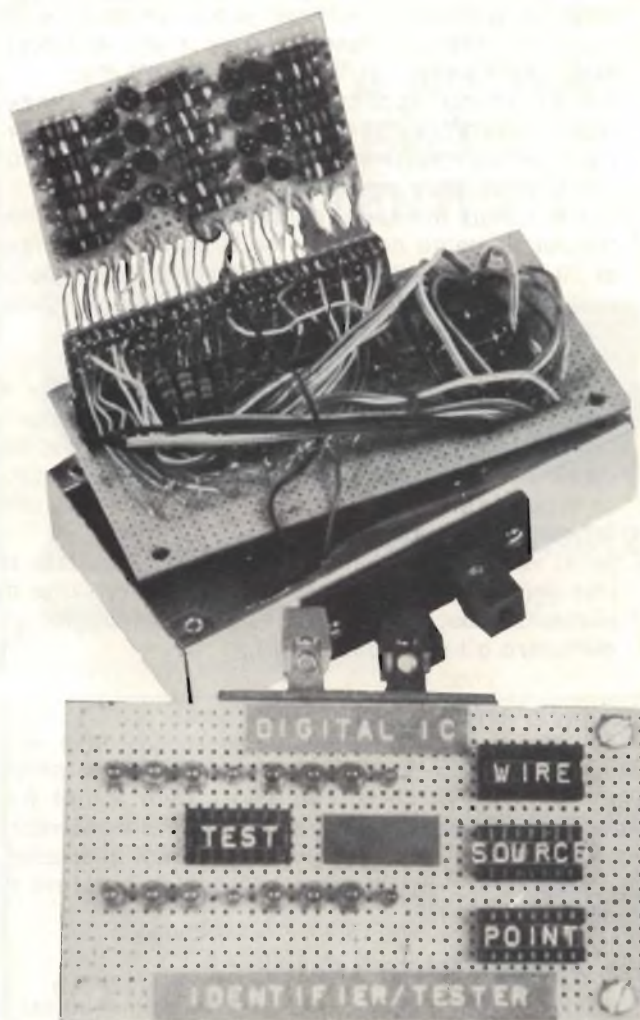
Fig. 3 - Fotografia dello strumento completamente montato, e ripreso in modo tale da chiarire la disposizione dei diversi elementi sulle basette di supporto.
