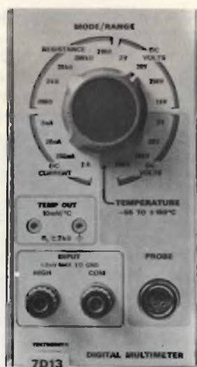
Fig. 2 - Il PLUG IN modello 7 D13 contiene un multimetro completo e presenta il risultato del processo di misura sullo schermo dell'oscilloscopio con 3\frac{1}{2} digits.
