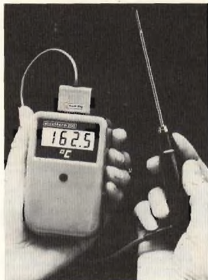
Termometro elettronico generale ACCUTHER 200.
