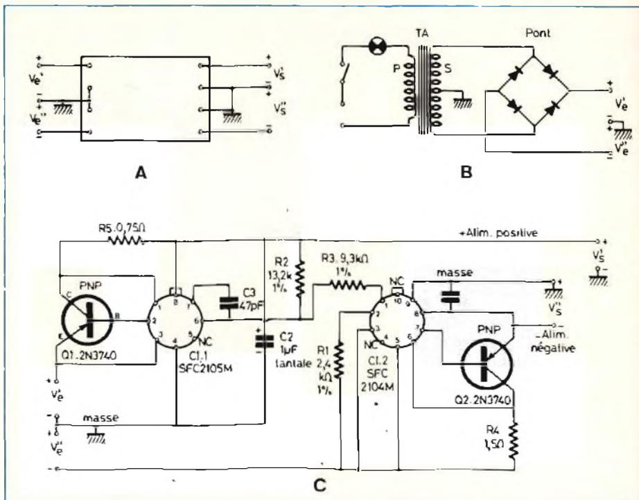
Fig. 5 - In «A» schema semplificato del regolatore adatto ad ottenere in uscita una tensione regolata di  $\pm 15$  V, con corrente di 0,2 A; in «B» schema del rettificatore con trasformatore, necessario per ottenere i due valori della tensione di ingresso V, rispetto a massa; in «C» — infine — schema completo della sezione elettronica di regolazione, facente uso di due diverse unità integrate, e di due transistori del medesimo tipo.
