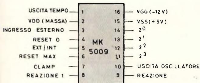
Fig. 2 - Identificazione dei sedici terminali dell'unità integrata MK 5009.
