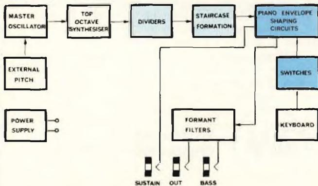
Fig. 31 - Schema a blocchi del pianoforte.
