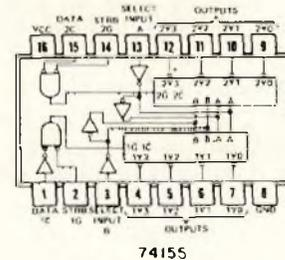
Fig. 2 - Configurazione del pin del chip 74155 e schema a blocchi del circuito MMD-1.
