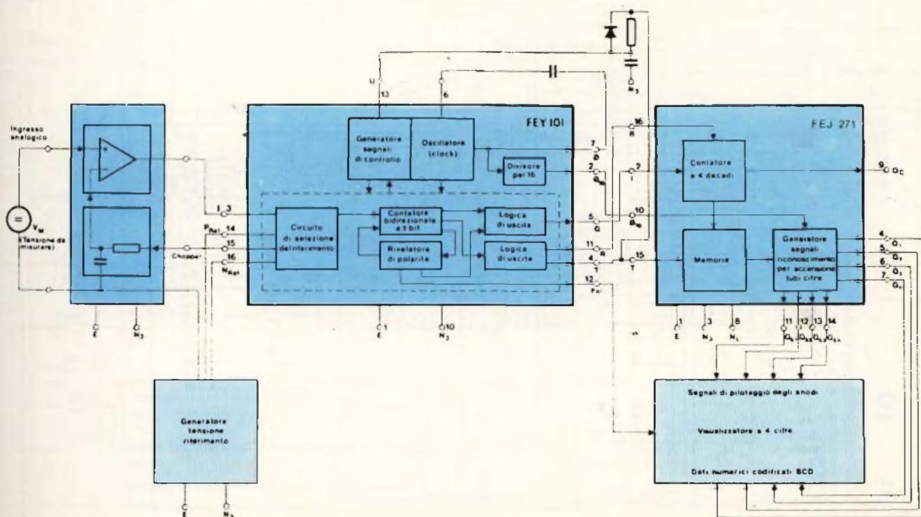
Fig. 1 - Schema a blocchi del multimetro digitale 3 1/2 cifre.
