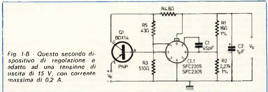
Fig. 1-B - Questo secondo dispositivo di regolazione è adatto ad una tensione di uscita di 15 V, con corrente massima di 0,2 A.
