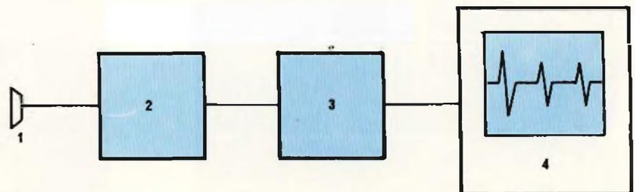
Fig. 1 - Schema di principio di un ecoencefalografo. 1 = sonda ultrasonora. 2 = generatore frequenza pilota in trasmissione, convertitore echi in impulsi elettrici in ricezione. 3 = sezione amplificatrice. 4 = sezione oscillografica.
