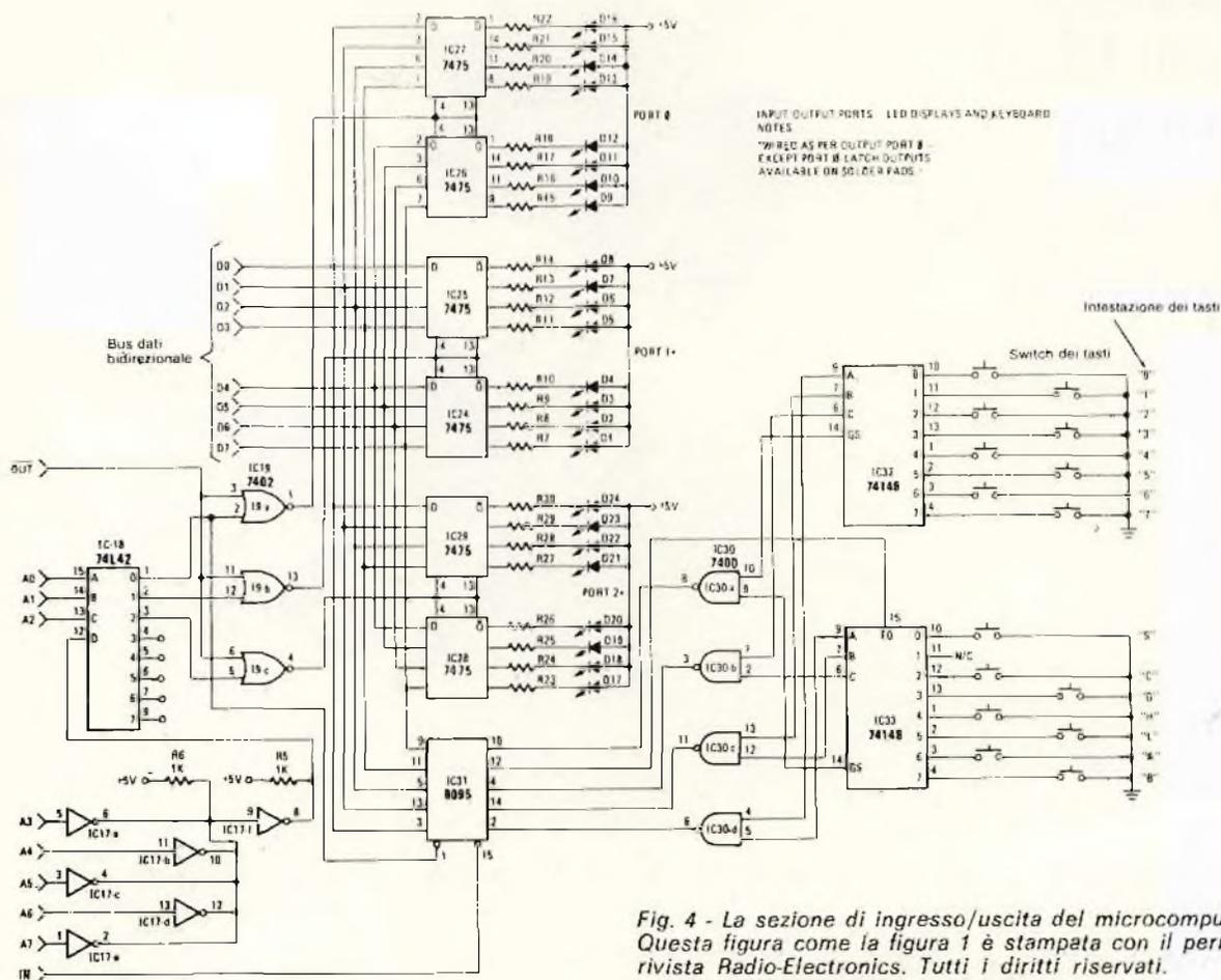
Fig. 4 - La sezione di ingresso/uscita del microcomputer MMD-1. Questa figura come la figura 1 è stampata con il permesso della rivista Radio-Electronics. Tutti i diritti riservati.
