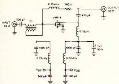
Fig. 5 - Schema elettrico completo dei vari componenti dell'amplificatore a larga banda che costituisce l'oggetto dell'articolo: T1 consiste in quattro spire di coppie di conduttori intrecciati in rame smaltato del diametro di 0,70 mm, su nucleo Indiana General tipo F 625-9Q2.
