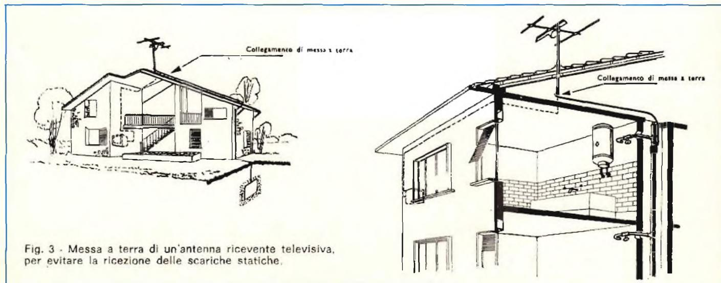
Fig. 3 - Messa a terra di un'antenna ricevente televisiva, per evitare la ricezione delle scariche statiche.
