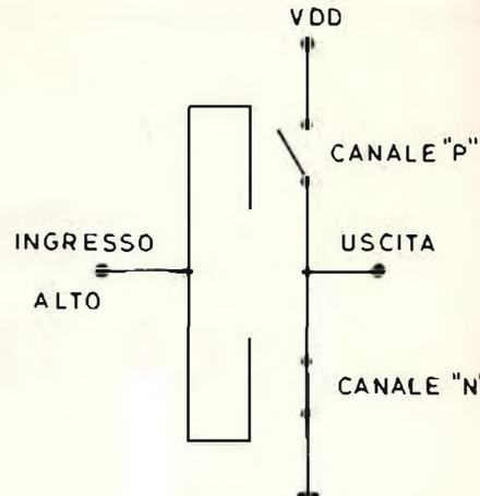
Fig. 3 - Condizione opposta dell'invertitore di figura 1, rispetto al caso illustrato alla figura 2: in questa seconda applicazione, il transistore superiore è in interdizione (commutatore aperto), mentre quello inferiore conduce (commutatore chiuso).
