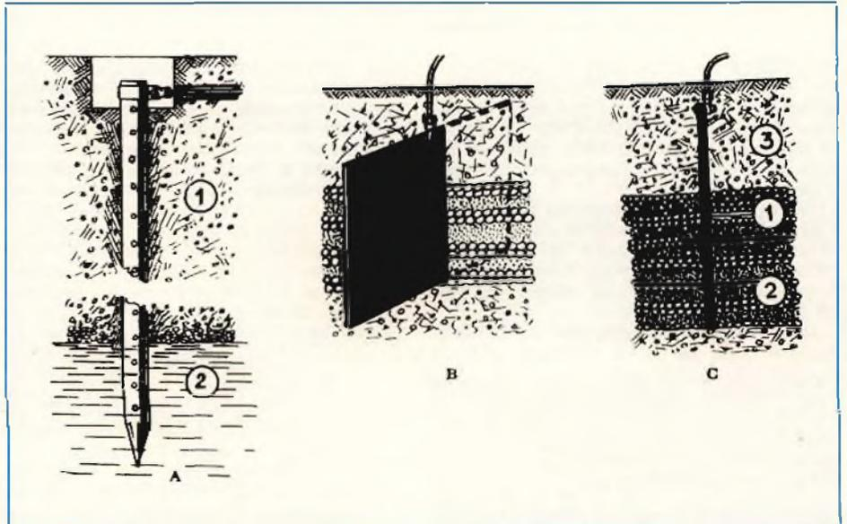
Fig. 1 - Vari tipi di dispersioni di terra: A) a spandente tubolare, 1 = strato di terreno permeabile, 2 = falda freatica. B) e C) a piastra ed a griglia metallica, 1 = dispersore, 2 = strati alterni di sassi e carbone, 3 = terra di copertura.
