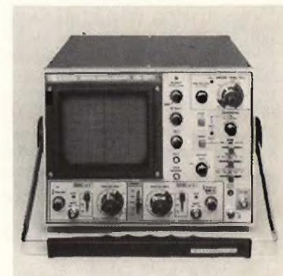
Oscilloscopio doppia traccia 30 MHz con tubo da 130 mm.
