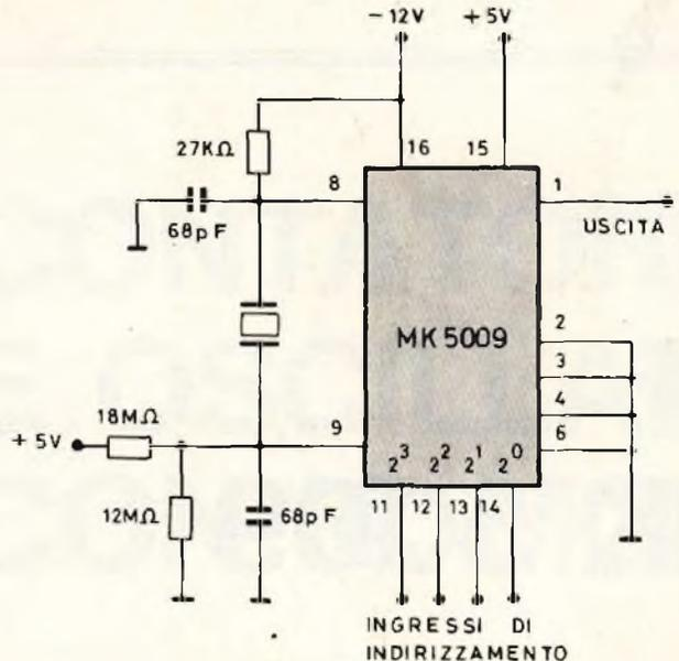
Fig. 4 - Tecnica di impiego del circuito integrato MOSTEK per l'allestimento di un oscillatore funzionante a cristallo.
