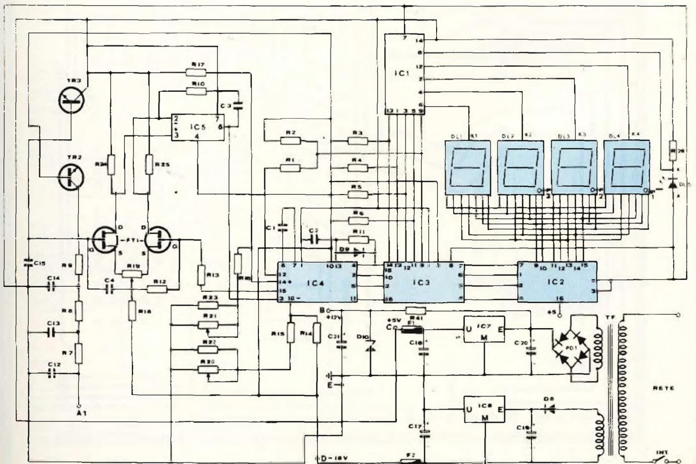
Fig. 3 - Schema elettrico del convertitore analogico-digitale.
