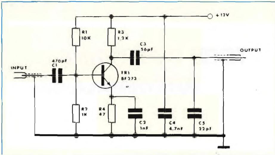
Fig. 1 - Schema elettrico dell'amplificatore d'antenna AM/FM per autoradio.
