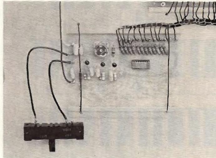
Fig. 32 - Oscillatore MASTER e generatore di ottava superiore.
