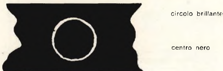
Fig. 2 - Punto luminoso di «Spot» che rispecchia un catodo con scorie.
