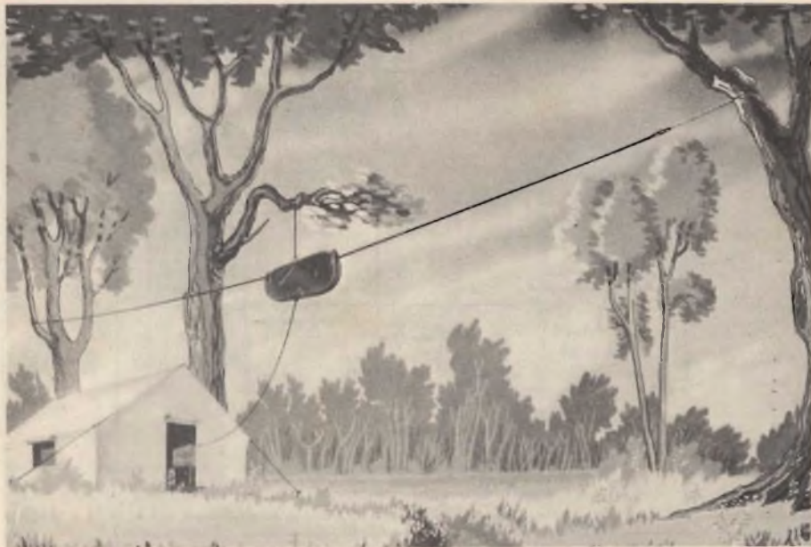
Fig. 8 - Antenna portatile, a dipolo raccordiabile in funzione della frequenza. Gamma 1.500 ÷ 30.000 kHz.
