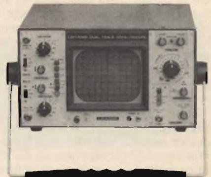
Oscilloscopio LEADER modello LBO 508-A con larghezza di banda di 20 MHz, ed in grado di eseguire somma e differenza algebrica fra i segnali di ingresso.
