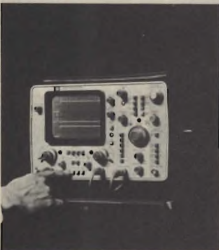
Oscilloscopio HEWLETT PACKARD modello 1740 A per ben comprendere le relazioni di fase tra due treni di impulsi occorre visualizzare il segnale di trigger come terza traccia.
