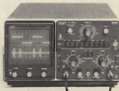
La fotografia rappresenta il modello PM 3232 con banda passante 10 MHz della multinazionale olandese PHILIPS.
