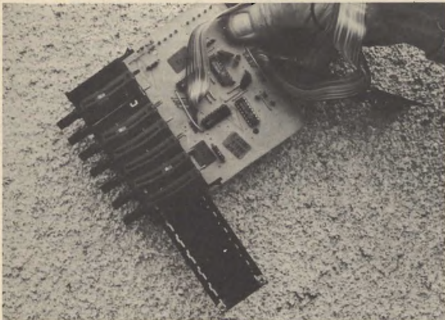
Fig. 4 - Riparazione dei programmatori Grundig. Sfilamento della pista potenziometrica.
