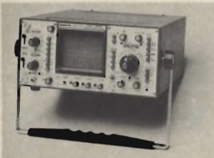
Oscilloscopio LEADER modello LBO 515 con larghezza di banda fino a 25 MHz.
