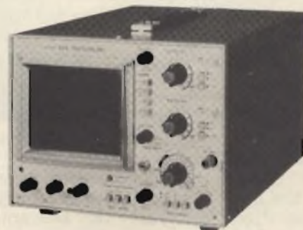
L'oscilloscopio modello 5514 della KIKUSUI; sul commutatore della base dei tempi è indicato quale modo di funzionamento viene selezionato.
