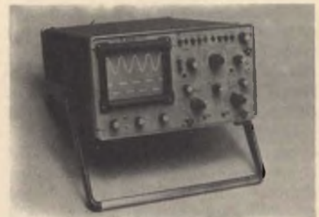
Oscilloscopio modello OS 1100 della Casa inglese GOULD ADVANCE con base dei tempi ritardata.
