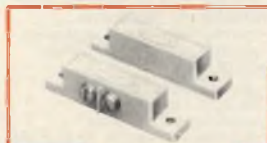
INTERRUTTORE MAGNETICO ADEMCO Tipo 51 Contatto: normalmente aperto Distanza di chiusura: 12 mm Distanza di apertura: 7 mm OT/6005-00 L. 4.600
