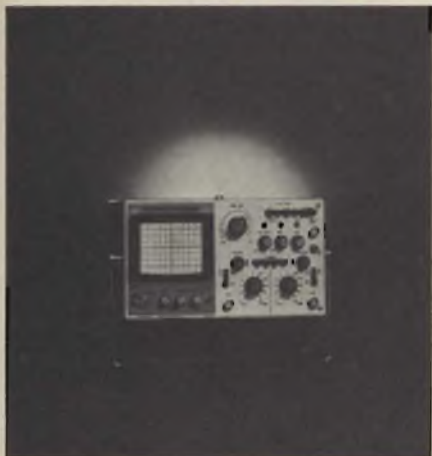
Oscilloscopio a doppia traccia UNAHOM modello G 404 DT. Notare sullo schermo le linee di riferimento del 10% e 90% dell'ampiezza dell'intero schermo, assai utile per la misura del tempo di salita.
