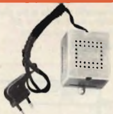
Alimentatore stabilizzato Adatto per amplificatori d'antenna Ingresso: 220 V.c.a. Uscita: 12 V.c.c. Corrente d'uscita: 100 mA Dimensioni: 68x60x40 mm NA/0729-06 L. 4.500
