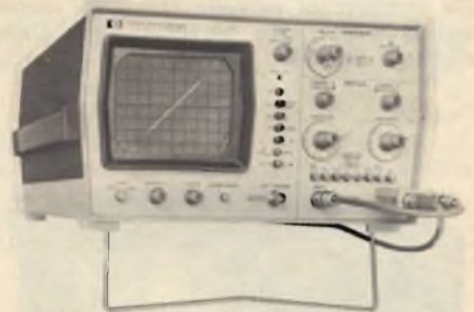
Oscilloscopio modello 1222A della H.P. dotato di un tempo di salita di 28 nSec.
