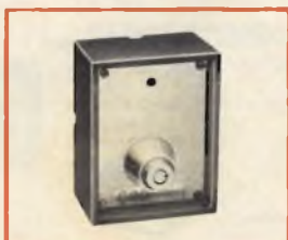
SERRATURA CSA Per comando a distanza di centralino d'allarme Protetta contro l'apertura, il distacco dalla parete e contro percussioni Circuito contro il taglio dei cavi Spia di impianto inserito Portata sui contatti: 2A - 220V Dimensioni: 109 x 84 x 52 mm OT/2730-00 L. 34.500
