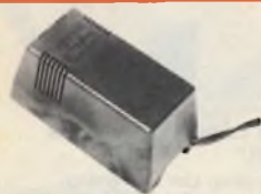
Alimentatore stabilizzato per preamplificatore d'antenna "SIEMENS" Mod. S 43101-N-A4 Tensione d'entrata: 220 V.c.a. \pm 10\% Tensione d'uscita: 12 V.c.c. (neg. a massa) Corrente d'uscita: 100 mA Dimensioni: 110 x 57 x 50 NA/0729-16 L. 8.900
