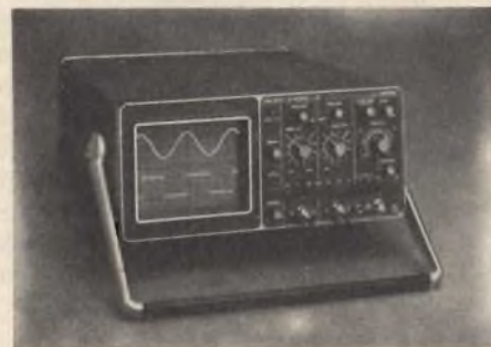
Oscilloscopio modello PM 3211 della Philips; notare la disposizione logica dei comandi.
