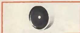
SIRENA ELETTRONICA LA SONORA Tipo EL50/111 A Protetta contro l'inversione di polarità Livello di uscita a 7 m: 102 dB Potenza: 6 W Frequenza: 1,1 + 2 kHz Alimentazione: 12 Vc.c. Dimensioni: \varnothing 128 x 74 mm OT/7600-00 L. 22.500
