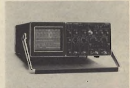
L'oscilloscopio Philips modello PM 3214 con doppia base dei tempi e linea di ritardo. La fotografia lo mostra mentre ingrandisce di 10 volte i particolari che nelle due tracce superiori sono indicati da una traccia più intensa.
