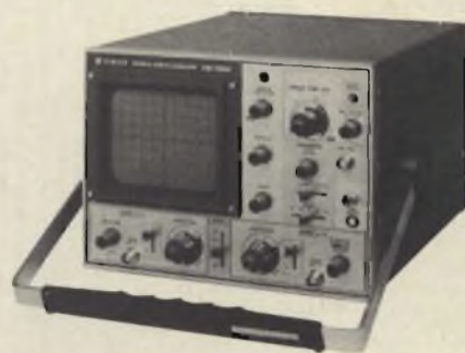
Oscilloscopio della TRIO KENWOOD modello CS 1562A, con sensibilità massima verticale di 10 mV/DIV.
