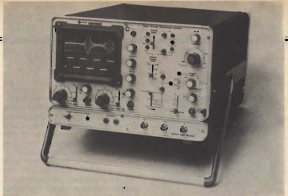
Fig. 6 - Oscilloscopio a memoria digitale mod. OS 4000 della Gould Advance.
