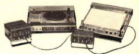
La coppia PM 5165 e PM 5171 permette il rilievo delle curve di risposta BF con l'uso di un registratore X-Y.
