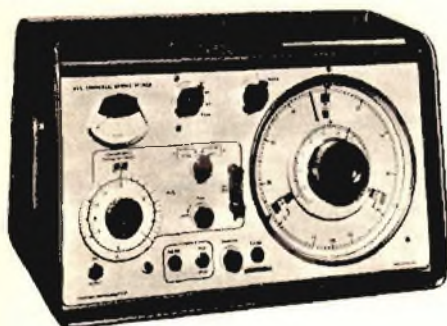
Fig. 8 - Moderno ponte universale TF 1313A, con precisione migliore di 0,1% per la misura di induttanze 0,1 μH ÷ 110 H, capacità 0,1 pF ÷ 110 μF; resistenze 0,03 Ω ÷ 110 MΩ.
