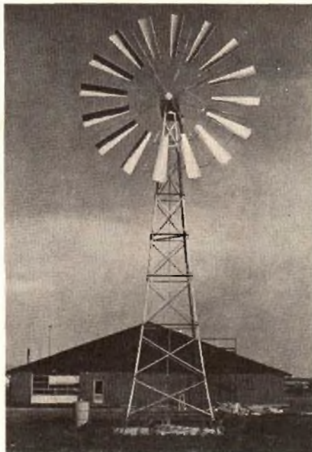
Fig. 30 - Mulino a vento alto 13 m, diametro 5,60 m, 16 pale in grado di fornire il riscaldamento od il condizionamento ad una abitazione normale ed anche ad una piccola industria. Potenza ottima di resa 10 kW.
