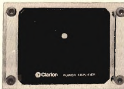
Fig. 18 - L'amplificatore di potenza GA-501 della Clarion funziona con una potenza di uscita di 25 W per canale.
