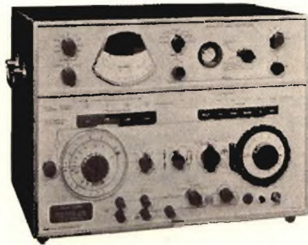
Fig. 6 - Analizzatore di induttanze TF 2702 reperibile tuttora presso i rivenditori del surplus o di strumenti usati.
