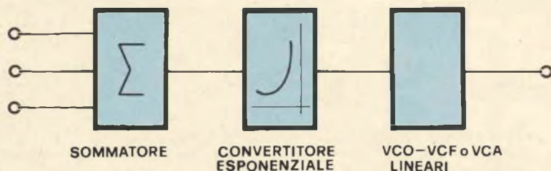
Fig. 3 - Composizione a blocchi di un modulo VCO.
