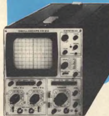
HM 512 5"-40 MHz-5mv. Doppia traccia. Linea di ritardo Y. Base tempi ritardabile. Hold-off variabile.
