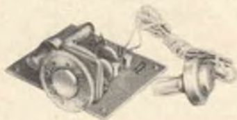
Fig. 1 - Miniricevitore AMTRON UK 502/U (GBC ITALIANA), fornito in scatola di montaggio. Gamma onde lunghe e medie.
