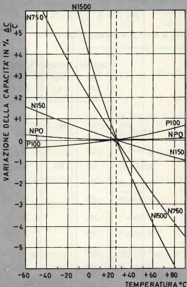
ANDAMENTO TYPICO DELLA CAPACITA' IN FUNZIONE DELLA TEMPERATURA
