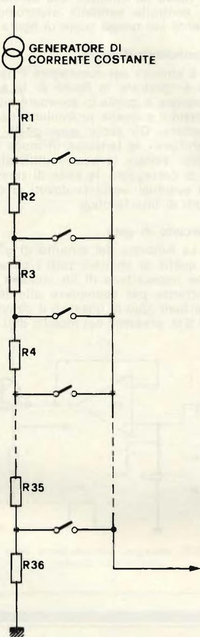
Fig. 1 - Principio di funzionamento della tastiera.
