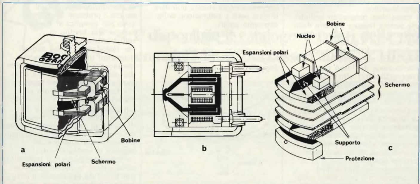
Fig. 1 - Elementi costruttivi di alcune testine magnetiche.
