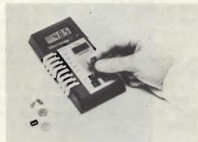
Misuratore di capacità da 0,1 pF e 1999 µF.
