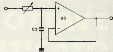
Fig. 5 - Schema di principio del circuito di «PORTAMENTO».
