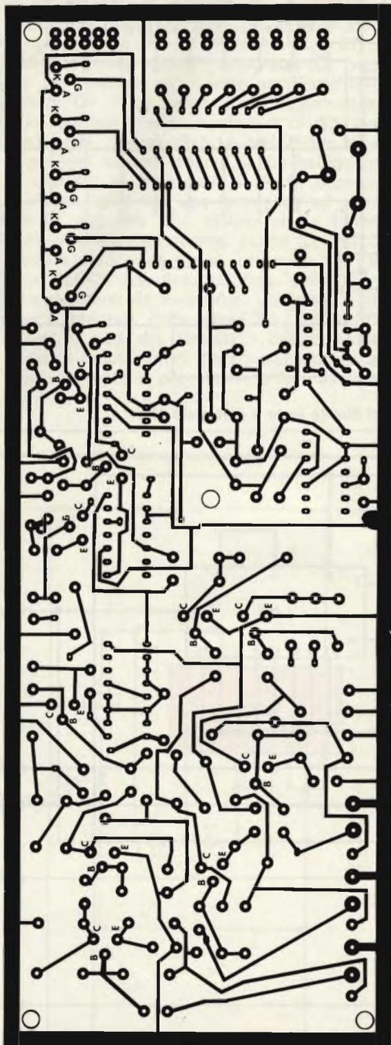
Fig. 4 - Circuito stampato visto dal lato rame di scala 1 : 1. E' necessario prestare attenzione nell'effettuare le saldature essendo in certi punti le piste vicinissime.
