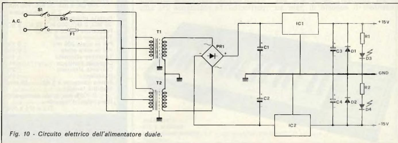
Fig. 10 - Circuito elettrico dell'alimentatore duale.
