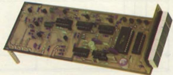
*Prototipo del lettore di frequenza a realizzazione ultimata: si noti l'estrema cura nella disposizione dei componenti.*
