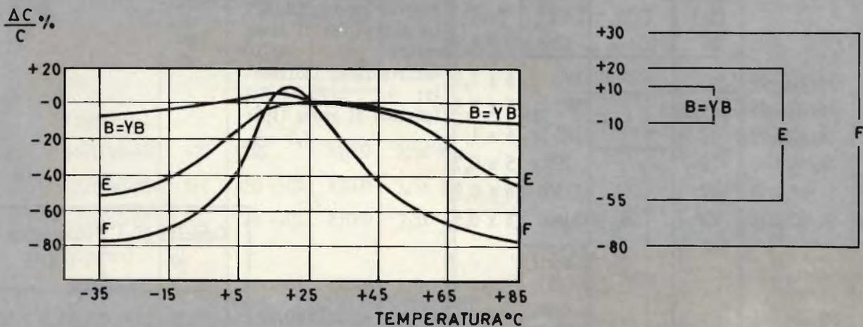
Condensatori ceramici a disco, di accoppiamento e by-pass. Senza terminali; saldabili direttamente sullo chassis o sul circuito stampato.
