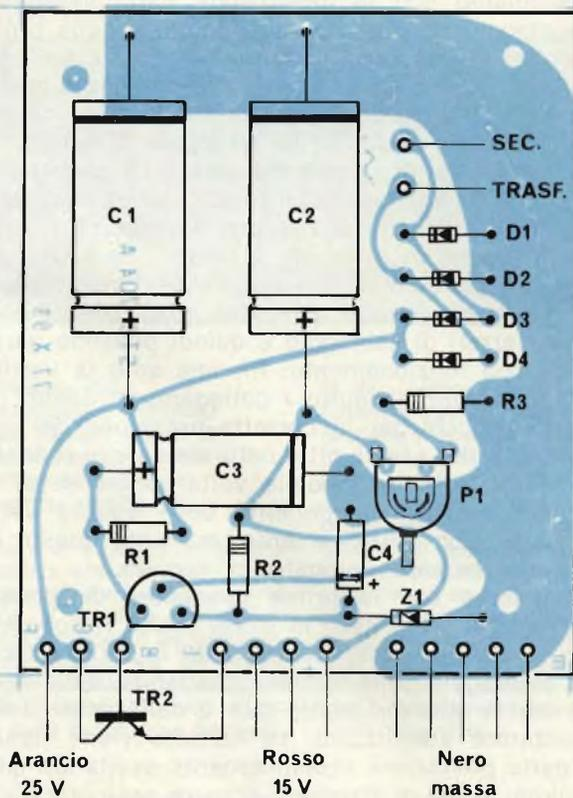
Fig. 63 - Disposizione dei componenti sul circuito stampato dell'alimentatore stabilizzato.
