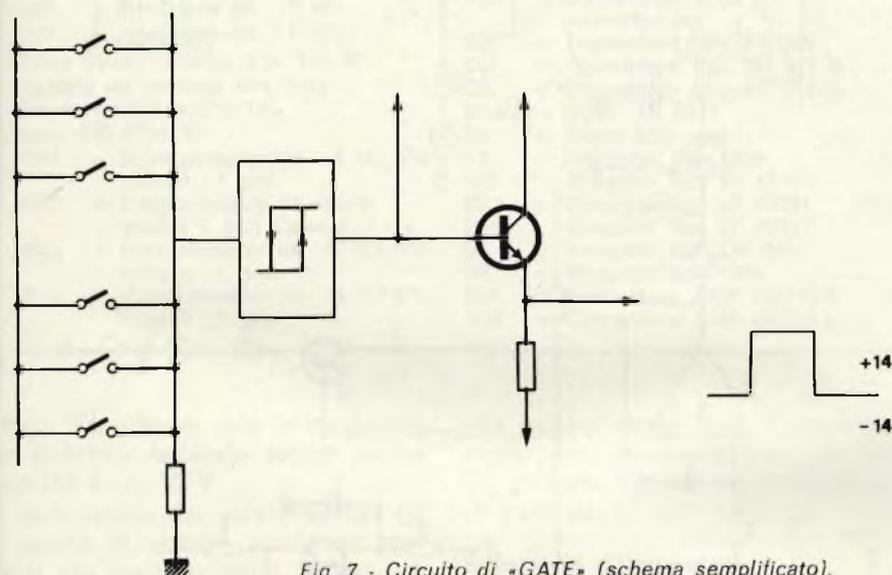
Fig. 7 - Circuito di «GATE» (schema semplificato).
