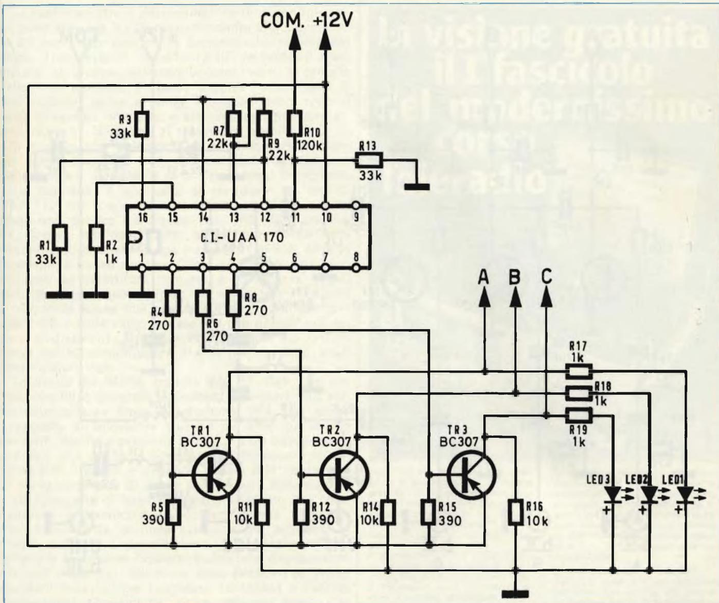
Fig. 3 - Circuito elettrico dell'elegante selettore elettronico compreso nel sistema montato su palo. Il circuito integrato, a seconda della tensione d'ingresso, attiva o TR1, o TR2 o TR3. Normalmente l'UAA 170 è impiegato per il comando di LED «a scala» in relazione al livello presentato; nell'identico modo, tramite R4, R6, R8, polarizza i transistori.
