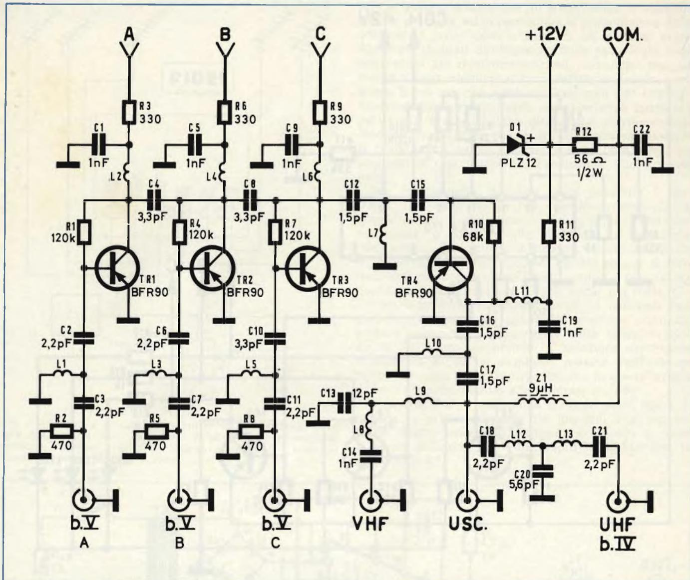
Fig. 4 - Circuito elettrico dell'amplificatore «booster» compreso nel sistema montato su palo. TR1, TR2 e TR3 sono posti in circuito alternativamente, dai transistori identicamente denominati nella figura precedente. TR4 costituisce un secondo stadio, o stadio «finale» del complesso, che lavora in unione a tutti e tre gli stadi precedenti, commutabili. Sono da notare i filtri, commentati nel testo, che consentono d'impiegare un unico cavo di «discesa».
