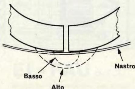
Fig. 3 - Influenza della corrente di Bias sul campo magnetico.
