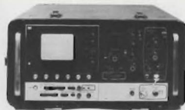
Analizzatore di spettro con banda da 10 MHz a 40 GHz.
