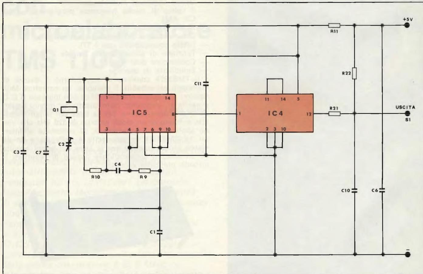
Fig. 1 - Schema elettrico della sezione base dei tempi. La frequenza di uscita, misurata sul punto S1 è di 320 kHz.
