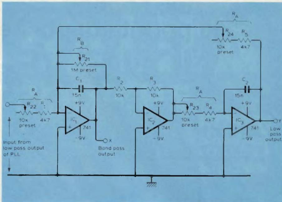
Fig. 5 - Schema della sezione per la rivelazione degli impulsi di sincronismo, facente parte del complesso impianto elettronico di uno dei nuovi satelliti meteorologici del tipo «Tiros-N».
