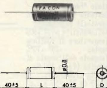
Nota: armature entrambe ossidate che consentono una inversione della tensione di polarizzazione indicata con V<sub>np</sub> c.c.
