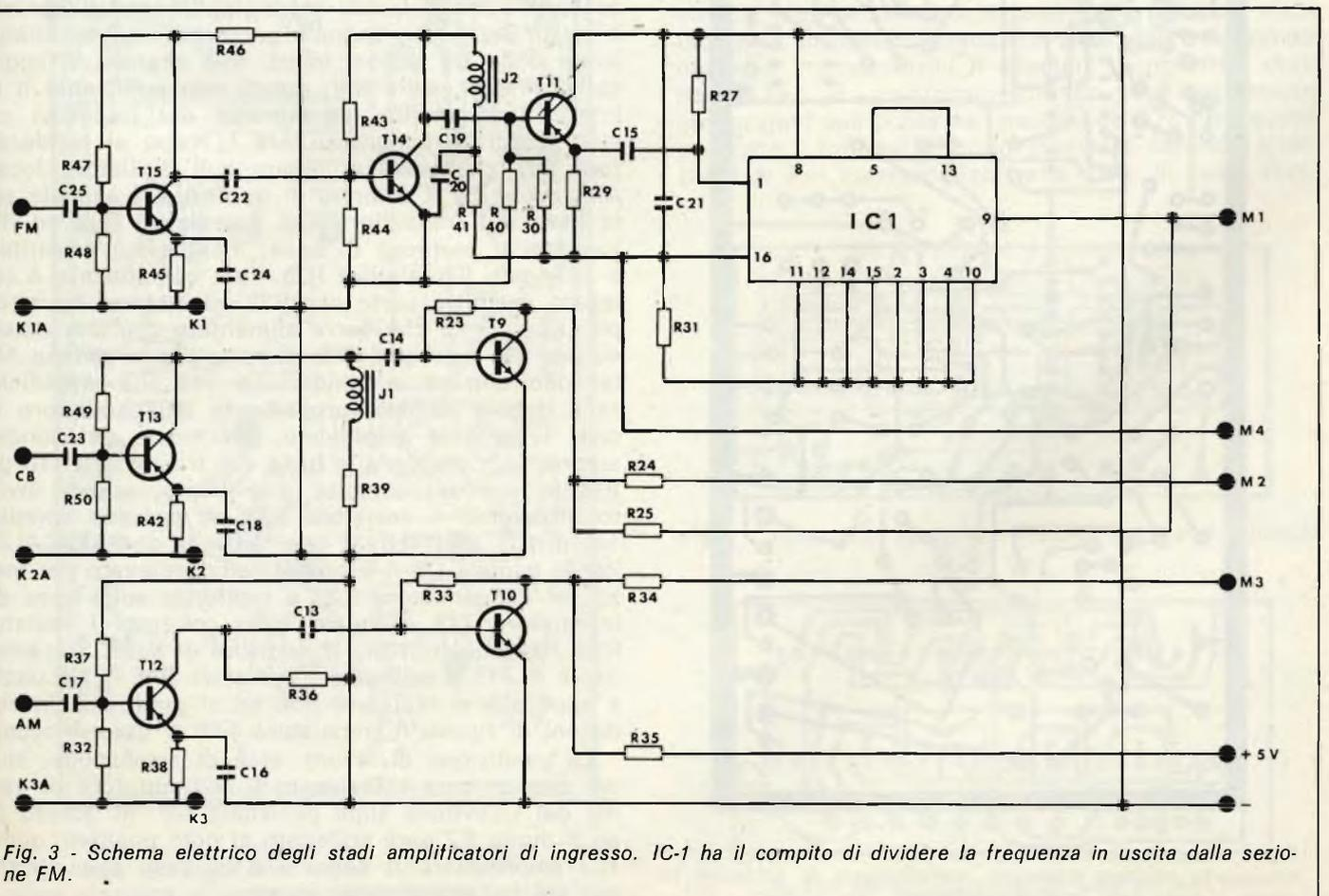
Fig. 3 - Schema elettrico degli stadi amplificatori di ingresso. IC-1 ha il compito di dividere la frequenza in uscita dalla sezione FM.
