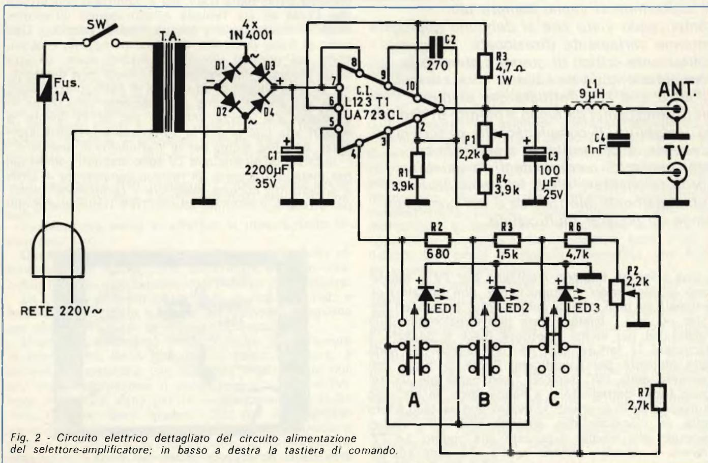
Fig. 2 - Circuito elettrico dettagliato del circuito alimentazione del selettore-amplificatore; in basso a destra la tastiera di comando.
