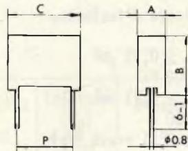
Condensatori in polipropilene doppia metallizzazione "Wima"
