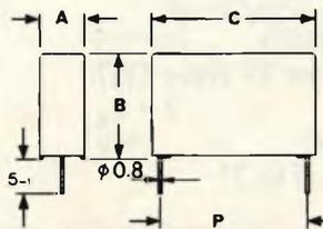
Condensatori in policarbonato metallizzato "Philips" Stampati in resina epossidica
