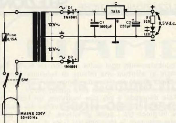
Fig. 1 - Schema elettrico della parte alimentatrice dello strumento.
