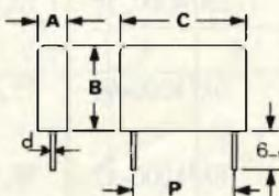
Condensatori in polipropilene metallizzato "Facon"
