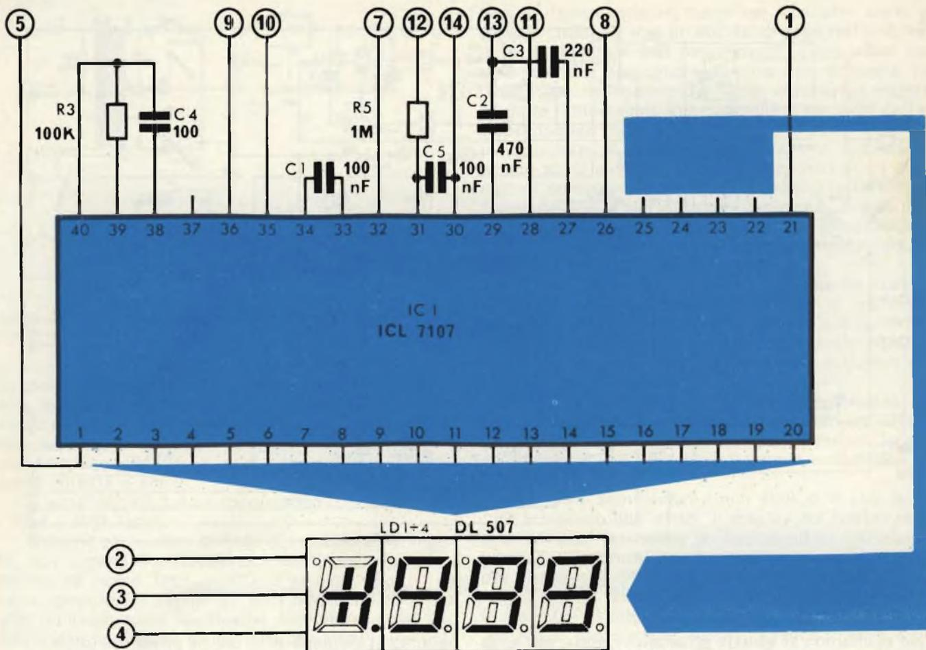
Fig. 3 - Schema elettrico del convertitore analogico digitale.
