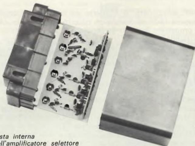
Vista interna dell'amplificatore selettore previsto per il montaggio su palo. La basetta verticale che si nota a destra comprende l'IC UAA170 e la relativa circuiteria, oltre a TR1, TR2, TR3.
