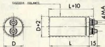
Condensatori elettrolitici in alluminio di alta capacità "Facon"
