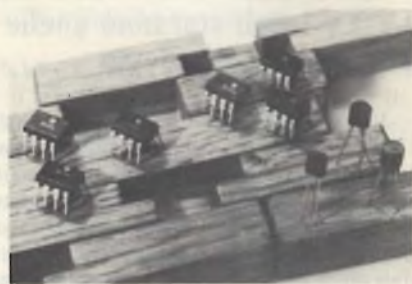
TL 431 della Texas instruments, che può sostituire tutti gli zener.
