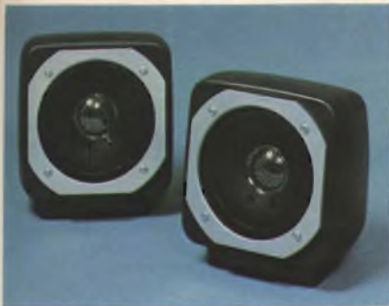
Custodia con altoparlante "BANDRIDGE" In ABS nero Altoparlante con sospensione pneumatica Potenza d'uscita: 20 W RMS Impedenza: 4 Ω Dimensioni altoparlante: ∅ 126 mm KA/1870-00
