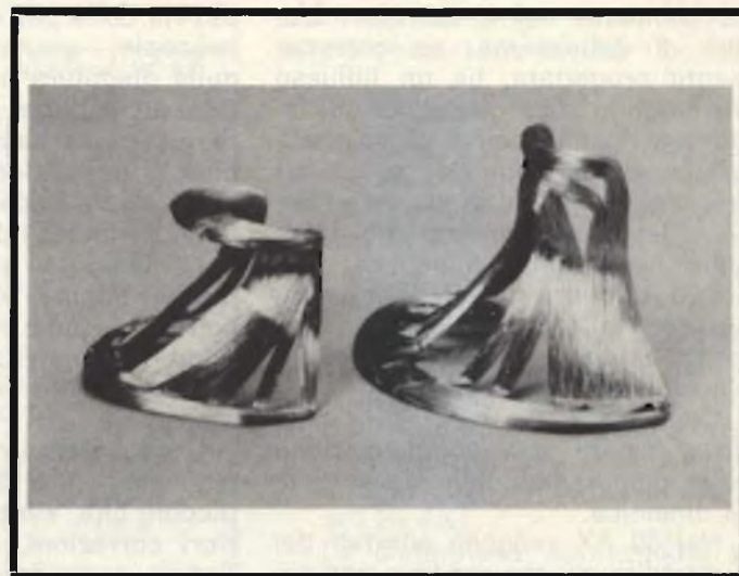
Fig. 4 - Bobina di deflessione per deflessione orizzontale; a sinistra 20 AX, a destra 30 AX.
