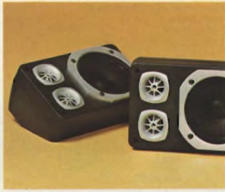
Box di altoparlanti "BANDRIDGE" Custodia in ABS nero A due vie, composto da: 1 Woofer ∅ 126 mm 2 Tweeter ∅ 50,8 mm Sospensione pneumatica Potenza d'uscita: 15 W RMS Impedenza: 4 Ω KA/1860-00
