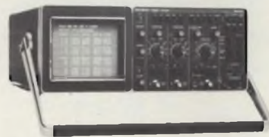
Combinazione di oscilloscopio e logic analyzer in un solo strumento.
