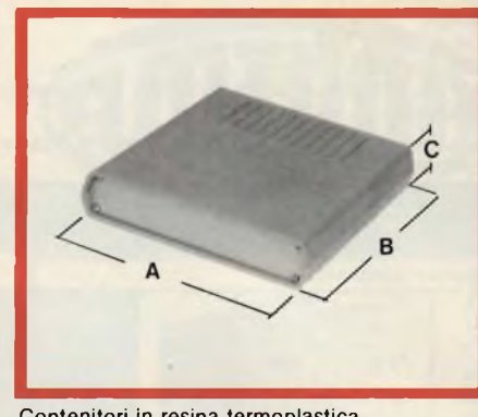
Contenitori in resina termoplastica autoestinguente. Pannelli in alluminio. Completi di griglie di aerazione. Chiusura con viti.
