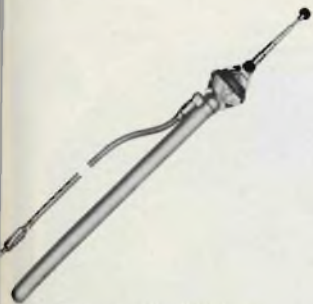
Antenna per autoradio Mod. BSA/28 Fissaggio: su carrozzeria Lunghezza cavo: 1.150 Sezioni: 4 Lunghezza totale: 1.000 Inclinazione: 0°÷43° KT/1800-00
