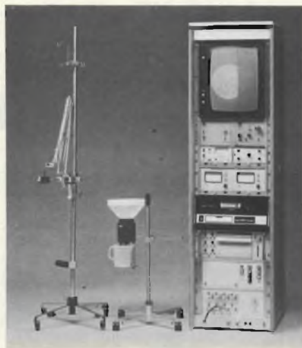
Fig. 17 - Il video al servizio della salute. Una modernissima apparecchiatura per il controllo di coloro che sono affetti da disturbi all'apparato urinario, costruita dalla DISA. Il registratore video con memoria, a cassette incorporate, opera insieme ad un registratore grafico a sei canali.
