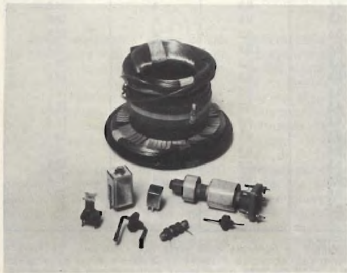
Fig. 1 - Le sole bobine che è possibile trovare in commercio già tutte fatte, sono quelle di Media Frequenza tarate a 455 kHz, le bobine di linearità per TV, le bobine di deflessione, e poche altre. In pratica, lo sperimentatore che ne voglia una per un ben determinato impiego, deve costruirsele da sé.
