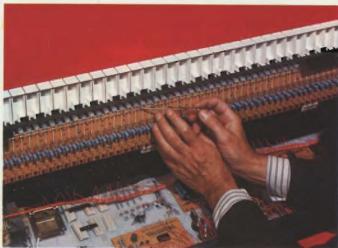
Fig. 68 - Particolare della fase di collaudo: registrazione dei ponticelli.
