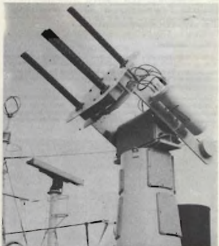
Fig. 3 - Non si tratta di un complesso di mitragliatrici ma bensì di antenne elicoidali, molto sofisticate, largamente usate per la ricerca spaziale da parte delle stazioni installate a bordo delle navi destinate a questo servizio.
