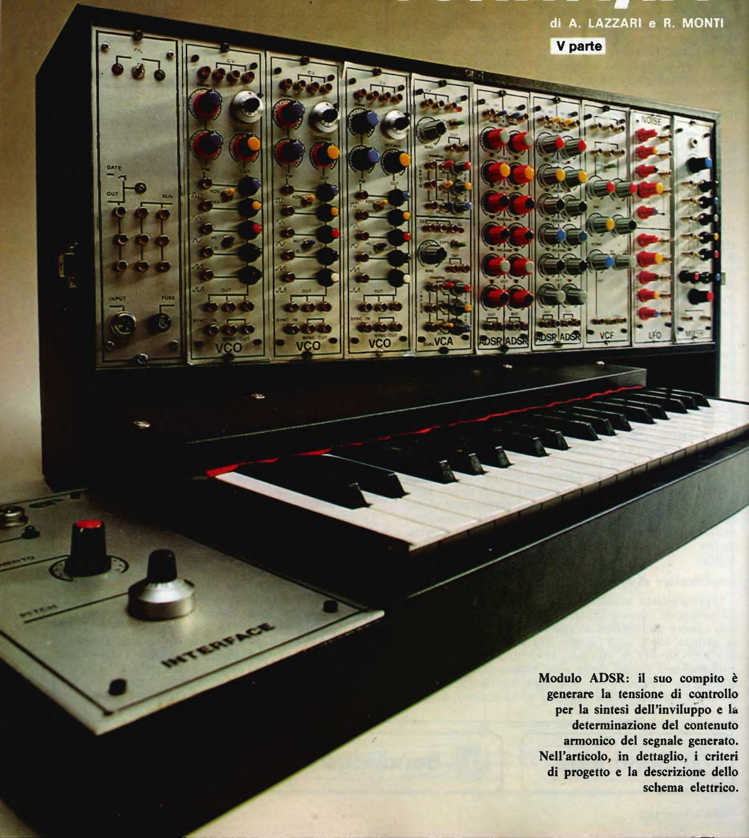
Modulo ADSR: il suo compito è generare la tensione di controllo per la sintesi dell'involuppo e la determinazione del contenuto armonico del segnale generato. Nell'articolo, in dettaglio, i criteri di progetto e la descrizione dello schema elettrico.
