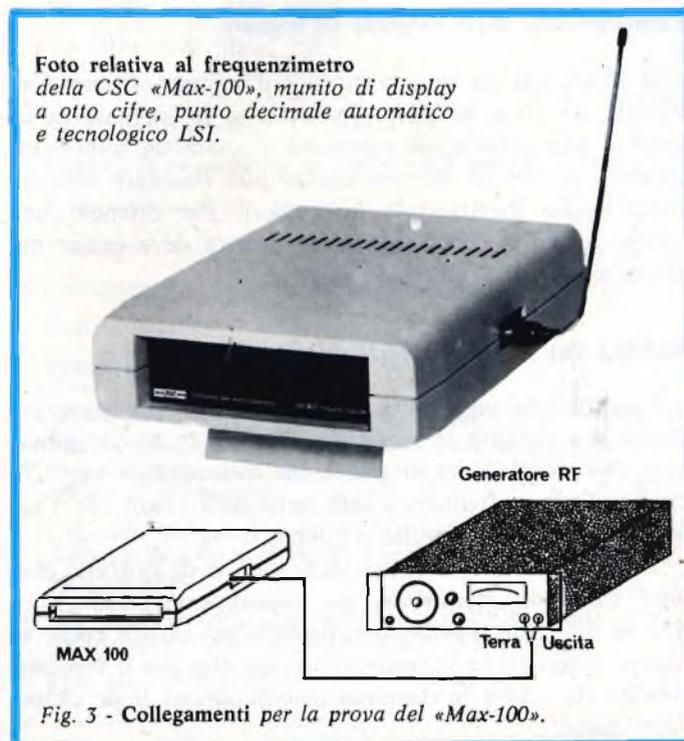
Fig. 3 - Collegamenti per la prova del «Max-100».
