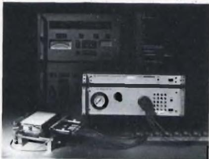
Trasduttore elettropneumatico per il test programmabile delle autoradio.
