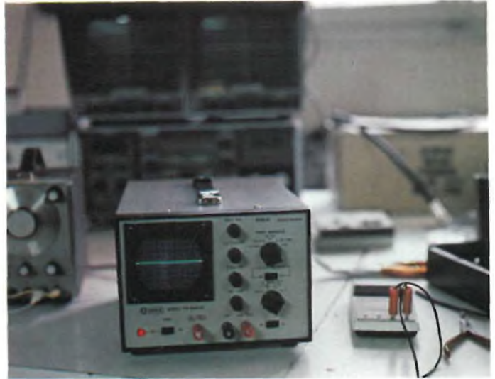
Fig. 5 - L'oscilloscopio con la scansione orizzontale funzionante. Come si vede la traccia è assai luminosa, anche se il relativo controllo non è portato al massimo. Durante la foto la "luminosità" è stata posta a circa mezza corsa.
