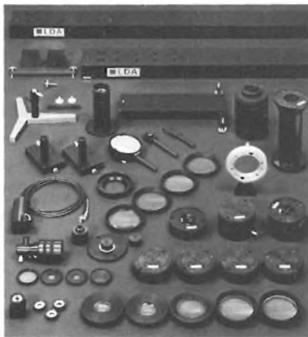
Fig. 4 - Insieme dei componenti che costituiscono il laser ottico 55X LDA.
