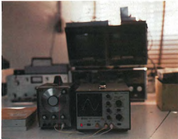
Fig. 7A - Ora, regolato il sincro orizzontale per avere una sola sinusoidale, ed il guadagno verticale, si può procedere ad una minuscola osservazione della forma d'onda.
