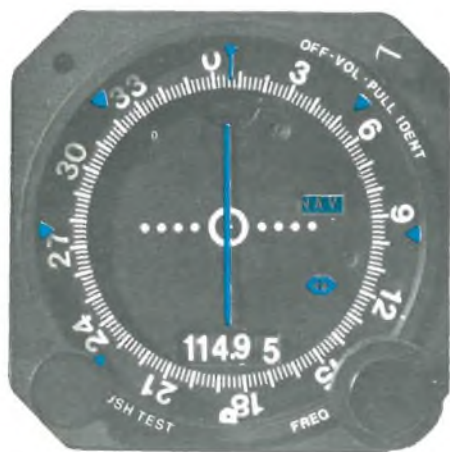
Fig. 1 - Un semplicissimo ricevitore per punto nave che sfrutta i radiofari del sistema VOR. Si tratta del modello VOR MX25.
