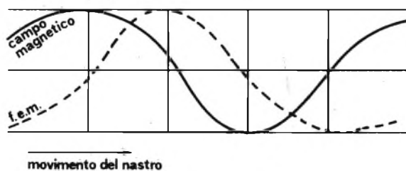
Fig. 6 - Principio della riproduzione magnetica.
