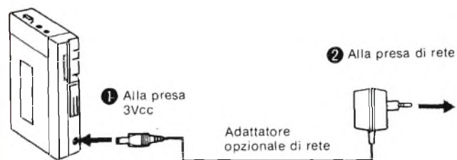
Fig. 4 - Esatto impiego dell'adattatore di rete: la relativa spina d'uscita deve essere inserita nella presa dei 3 Vcc.
