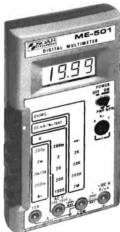
Fig. 1 - Questo disegno mostra il pannello frontale del multimetro numerico SOAR a cristalli liquidi mod. ME-501 le cui caratteristiche sono ampiamente descritte in questo articolo. Si noti anche l'elegante e razionale disposizione dei vari tasti. L'apparecchio è in vendita presso tutte le sedi GBC con codice TSJ2123-00.
