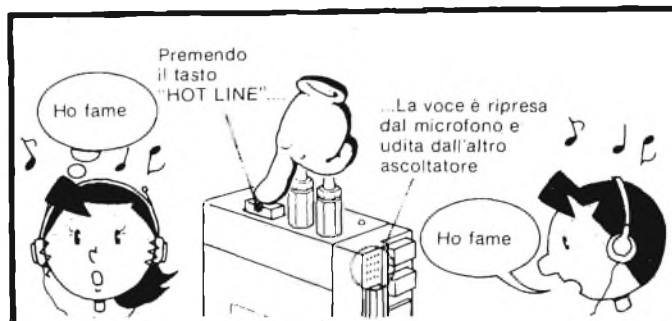
Fig. 16 - Durante l'ascolto a due è possibile comunicare semplicemente premendo il pulsante "HOT LINE" situato nella parte superiore vicino alla seconda presa Jack.
