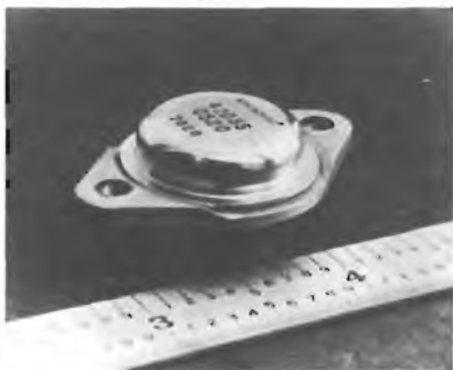
Regolatore di tensione tipo serie capace di sopportare 20A.
