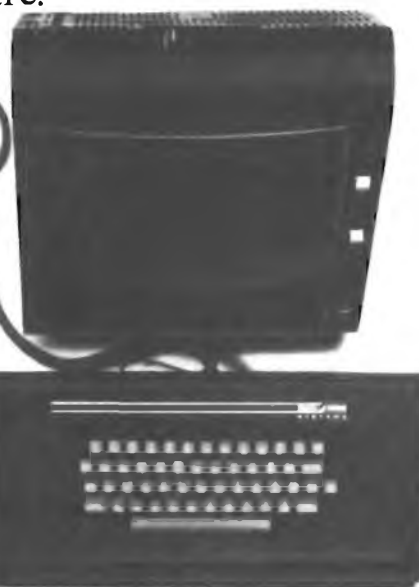
NBZ80-HL. Come NBZ80-S con 16k byte di RAM, tastiera alfanumerica con interfaccia video, 8k ROM di Basic su scheda addizionale, libro Basic Programming Primer, monitor TV (opzionale).
