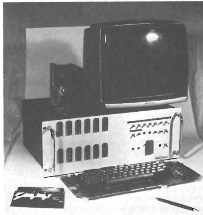
Vista d'insieme del sistema completo, col nuovo terminale e, all'ombra del TV, il "DRIVE" del sistema a dischi per il KIM che descriveremo nelle prossime puntate. Il drive ospita dischetti da 5" 1/4.
