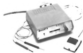
Localizzatori di corti con cambio automatico del fondo scala.
