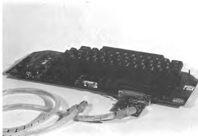
Il KTM 2/80 con il prototipo della interfaccia "20mA-RS232" necessaria per usare il KTM 2/80 col KIM-1, a 9600 BAUD di velocità di trasmissione. Notate anche, sulla destra, il "dipswitch" con le opzioni di funzionamento del terminale.
