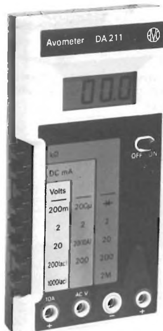
Multimetro digitale completamente protetto con display a cristalli liquidi.
