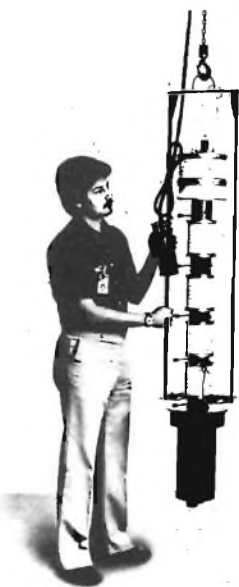
Klystron di potenza per trasmettitori UHF-TV a consumo ridotto.
