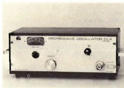
Oscillatore RF a larga banda con 50 mW di uscita.
