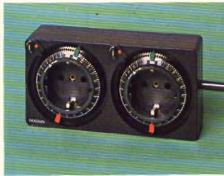
Fig. 4 - Aspetto frontale del doppio timer Grässlin "Dupl-O-matic" STA. Se il lettore osserva con attenzione la fotografia, noterà sulla destra di ciascun quadrante, in alto, l'interruttore comandato alternativamente in "on" ed in "off" dagli spinottini solidali al tamburo rotante.
