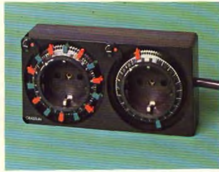
Fig. 4 - Aspetto frontale del doppio timer Grässlin "Dupl-O-matic" STA. Se il lettore osserva con attenzione la fotografia, noterà sulla destra di ciascun quadrante, in alto, l'interruttore comandato alternativamente in "on" ed in "off" dagli spinottini solidali al tamburo rotante.
