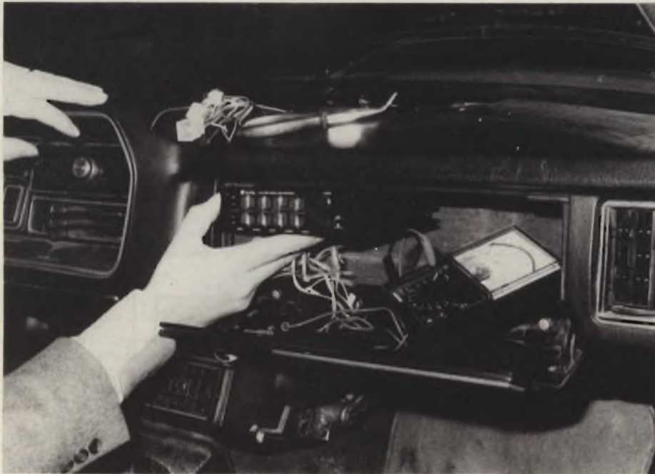
Durante il montaggio, si deve essere certi che il contatto di massa sia veramente ottimo, ed altrettanto per tutti gli altri collegamenti. Non è una cattiva idea il controllo tramite tester.
