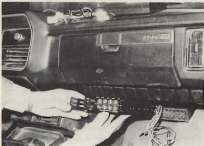
Montaggio dell'ampli-equalizzatore "KC/5200-00" e prova della sistemazione delle staffe.
