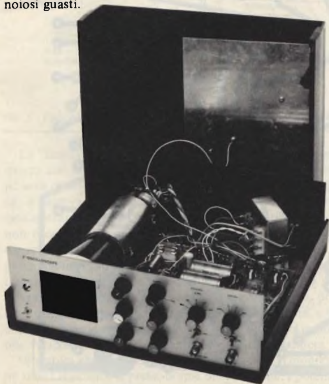
Vista interna a realizzazione ultimata dell'oscilloscopio da 3" presentato in questa serie di articoli.
