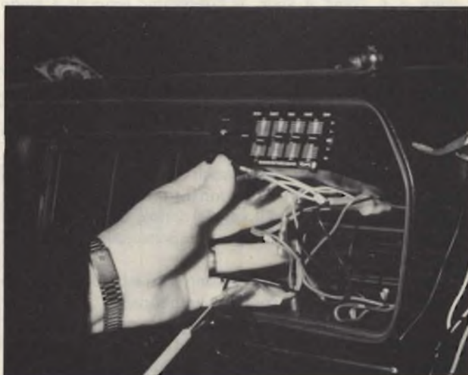
Fase di montaggio dell'amplificatore stereo per auto da 30 + 30 W munito di equalizzatore grafico.
