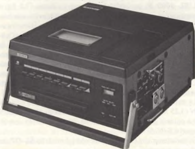
SONY mod. BVU 200 P, da studio dotato tra l'altro di servo capstan.
