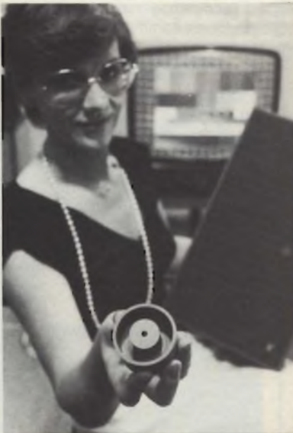
Nucleo di ferrite ad "olla" per i diffusori acustici dei televisori.
