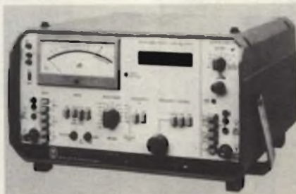
Misuratore di livello per il range da 200 Hz a 1,62 MHz.
