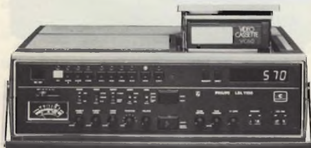
Videoregistratore Philips LDL-1100 che utilizza le cassette 1/2" VCR. Le sue possibilità comprendono l'editing, il doppiaggio e il ferma immagine.
