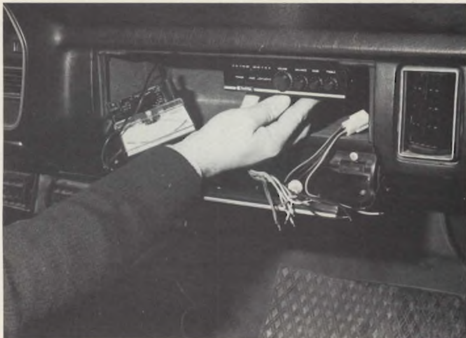
Particolare di una fase di montaggio a bordo di una autovettura del preamplificatore miniatura.
