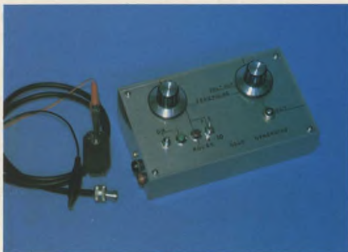
Generatore di stimoli elettrici a realizzazione ultimata. La sonda visibile a fianco va applicata al vegetale in esame.
