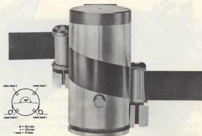
Avvolgimento Omega e tamburo del BCN.
