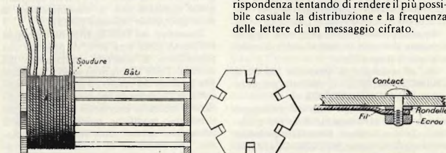
Fig. 9 - Altra soluzione per attuare i contatti del commutatore di cui alla figura 6.
