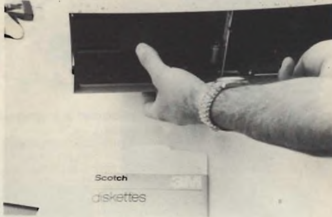
Per ultimo, si serra il bloccaggio tramite la leva del Driver: a questo punto il dischetto è serrato nel Driver ed è pronto a ruotare.
