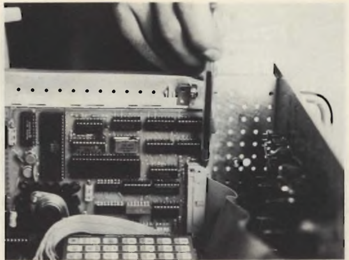
Si nota il Floppy Disc Controller che è appoggiato su un lato del contenitore che ospita il SYM 1.1. La biro indica chiaramente il connettore standard per cavo piatto a 34 conduttori che si diparte dal Controller e va verso il Driver, al quale sarà collegato.
