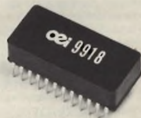
Amplificatore operazionale caratterizzato da un ritardo di propagazione di 5 ns.
