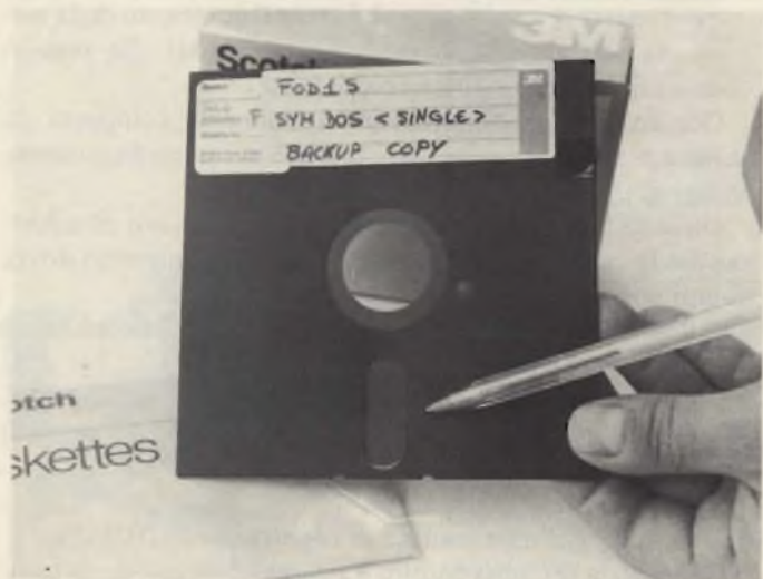
La biro indica la finestrella ovale che permette alla testina di R/W del Driver di appoggiare sul dischetto. Si nota bene la camicia protettiva (più scura) nonché l'etichetta e la banda adesiva nera che, in alto a destra permette di proteggere la scrittura del disco.
