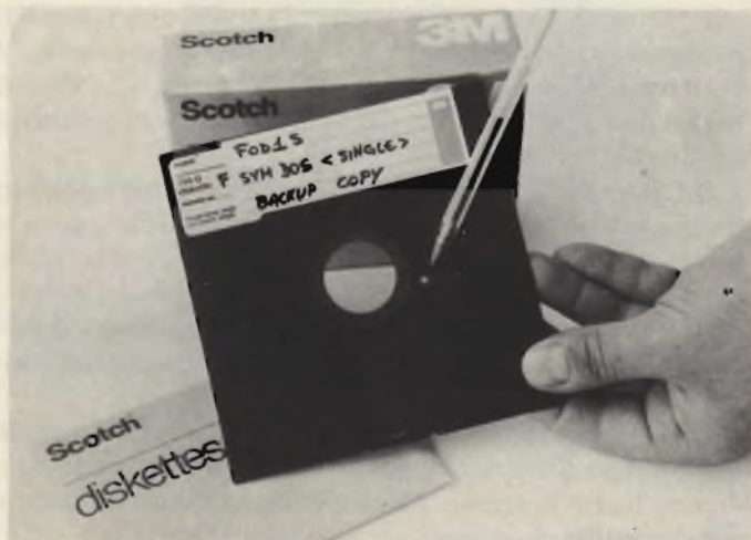
La biro stavolta indica il foro del disco che è fatto coincidere col foro della camicia protettiva. Tale foro, come spiegato nell'articolo, serve ad abilitare sul Driver un sensore di rotazione.
