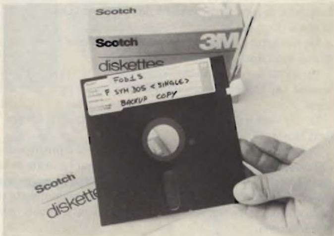
Stavolta la banda di protezione è stata parzialmente rimossa. Si noti la incavatura che permette ad un microswitch del Driver di sapere se il disco può anche essere scritto oltre che letto.
